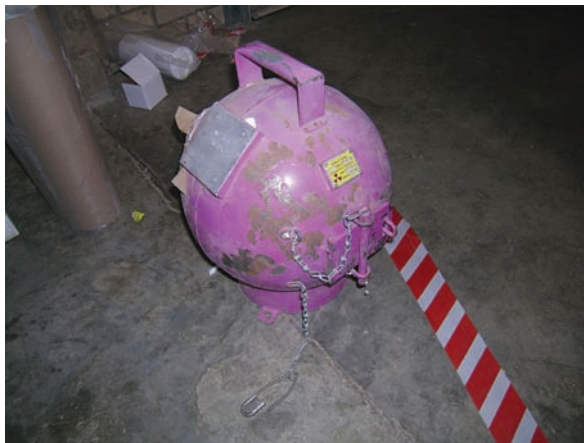
FIG. 42. Conteneur typique utilisé pour le transport et le stockage des sources neutroniques de diagraphie pétrolière.
