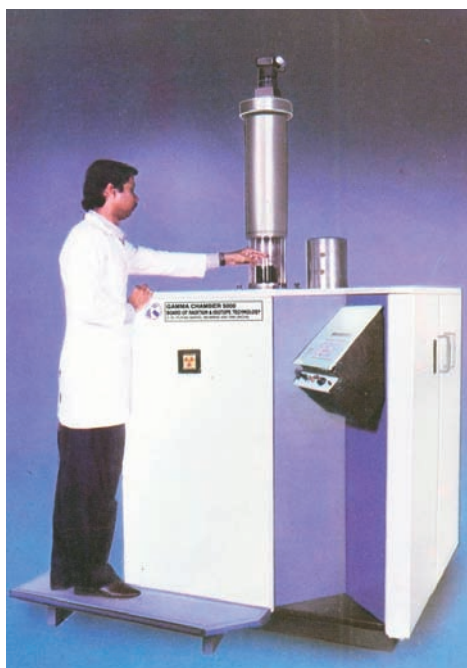
FIG. 22. Exemple typique d'irradiateur d'échantillons (photographie : BRIT).
