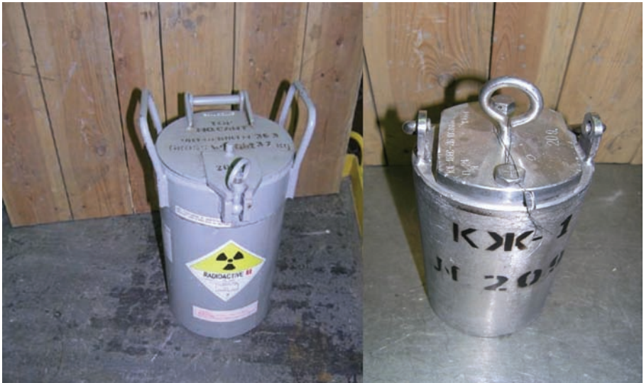
FIG. 143. Enveloppe externe et conteneur blindé interne d'un colis utilisé pour le transport de sources gamma de haute énergie (photographie : MAYAK P.A.).
