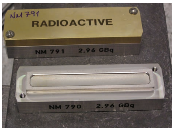
FIG. 118. Sources bêta ^{85}\text{Kr} en position fermée (avec le couvercle de protection en laiton) et ouverte (sans le couvercle) (photographie : QSA-Global).
