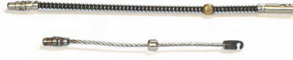
FIG. 105. Exemples typiques d'assemblages (source/flexible) de gammagraphie anciens (photographie : Oak Ridge Associated Universities).
