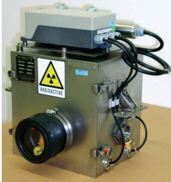
FIG. 76. Dispositif de mesure de la teneur en humidité des matériaux en vrac (photographie : Berthold Technologies).
