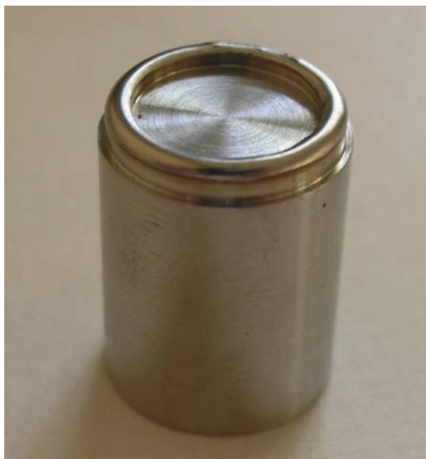
FIG. 113. Exemple typique de source de neutrons ^{241}\text{Am/Be} (photographie : MAYAK P.A.)
