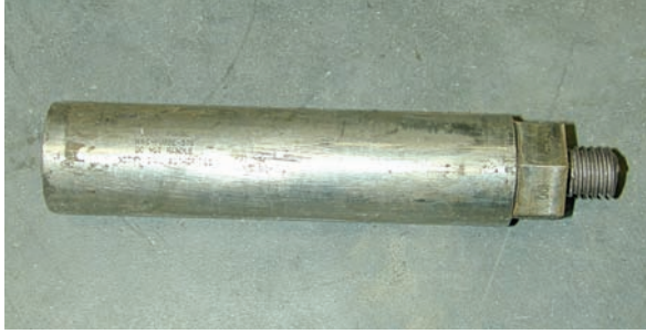
FIG. 40. Source de neutrons ^{238}\text{Pu}/\text{Be} typique utilisée en diagraphie pétrolière.
