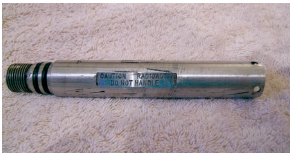
FIG. 39. Source de neutrons ^{241}\text{Am}/\text{Be} typique utilisée en diagraphie pétrolière.
