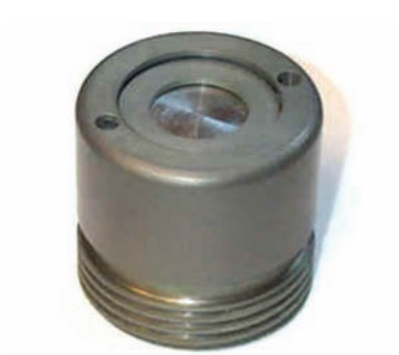
FIG. 99. Source de cobaltothérapie dans un porte-source en tungstène (photographie : Oak Ridge Associated Universities).
