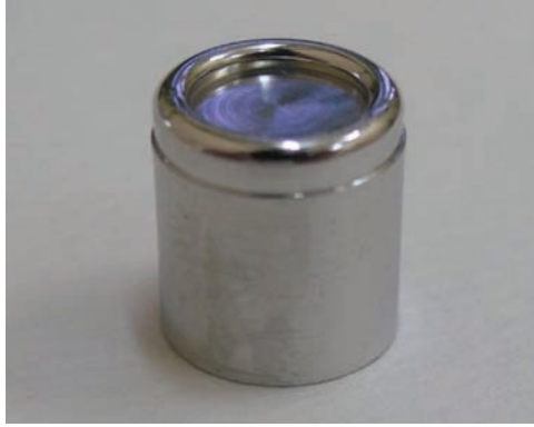
FIG. 110. Exemple typique de source gamma ^{60}\text{Co} (photographie : MAYAK P.A.).
