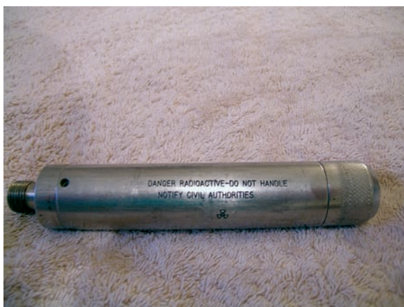
FIG. 36. Source de neutrons ^{241}\text{Am}/\text{Be} typique utilisée en diagraphie pétrolière.
