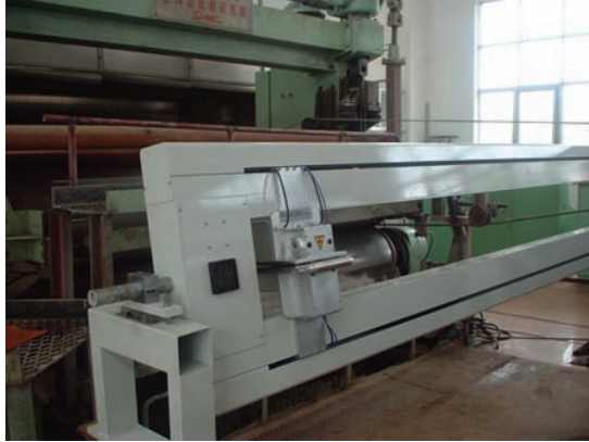
FIG. 72. Jauge à rayonnement bêta installée sur un laminoir (photographie : Betarem).
