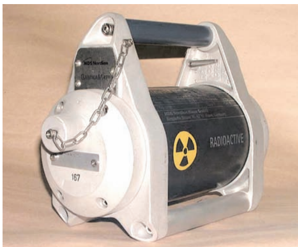
FIG. 44. Exemple typique d'appareil portatif moderne de gammagraphie (photographie : MDS Nordion).
