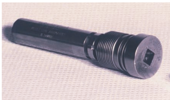
FIG. 115. Exemple typique de source ^{241}\text{Am}/\text{Be} de diagraphie pétrolière fixée à une tête de sonde (photographie : NRC).
