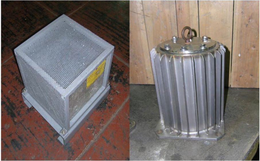
FIG. 144. Enveloppe externe et conteneur blindé interne d'un colis utilisé pour le transport de sources gamma de haute énergie (photographie : MAYAK P.A.).
