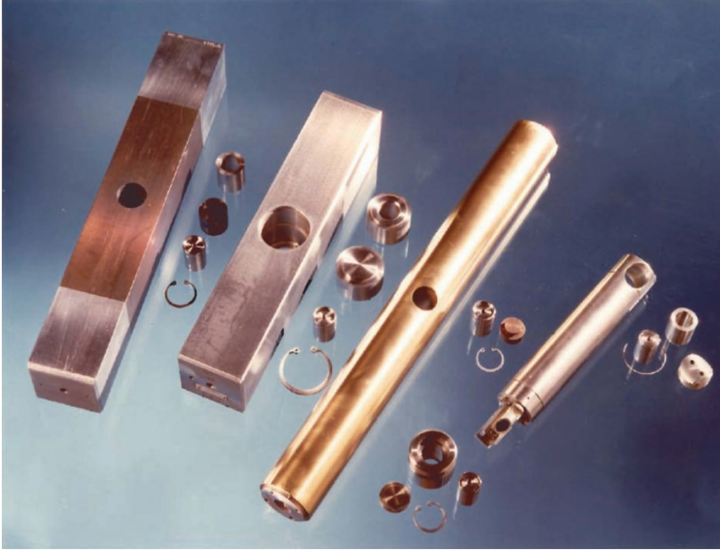
FIG. 101. Diverses sources de cobalthérapie avec les accessoires nécessaires pour leur chargement dans la tête de téléthérapie (photographie : REVISS Services (UK) Ltd).
