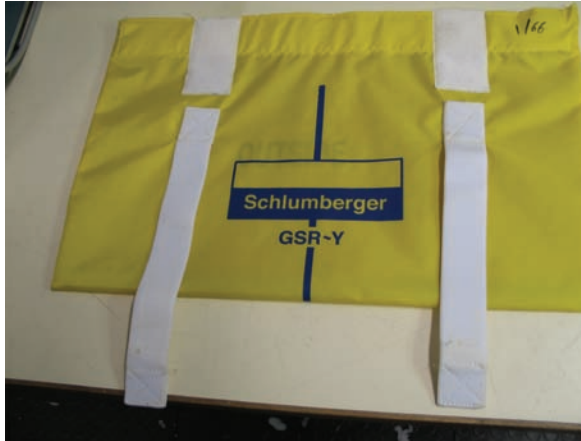
FIG. 133. Couverture d'étalonnage pour détecteur de rayonnement gamma naturel en diagraphie pétrolière (photographie : Schlumberger).
