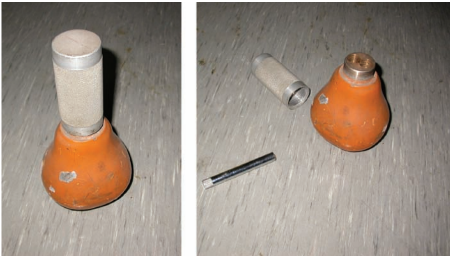
FIG. 52. Exemple d'appareil de gammagraphie obsolète à exposition manuelle de la source (photographie : NE-Seibersdorf).
