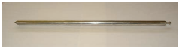
FIG. 103. Exemple typique de source de stérilisation industrielle (photographie : REVISS). Dimensions approximatives : 35 mm de diamètre \times 720 mm de longueur ; activité typique à l'état neuf : 1,85 PBq (50 kCi) de ^{60}\text{Co} .
