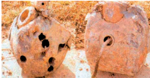
FIG. 15. Têtes de téléthérapie au ^{60}\text{Co} ou au ^{137}\text{Cs} endommagées.
