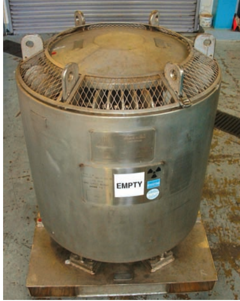
FIG. 134. Conteneur pour source gamma de haute activité en configuration de transport (photographie : REVISS).
