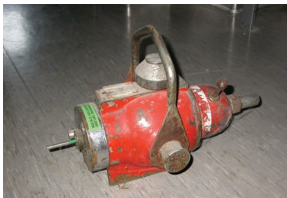
FIG. 48. Exemple typique d'appareil de gammagraphie obsolète (source de ^{60}\text{Co} ) (photographie : NE- Seibersdorf).
