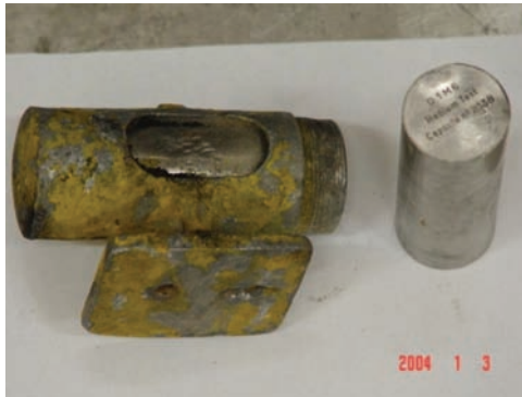
FIG. 112. Source de jauge gamma ^{226}\text{Ra} ancienne avec son porte-source.
