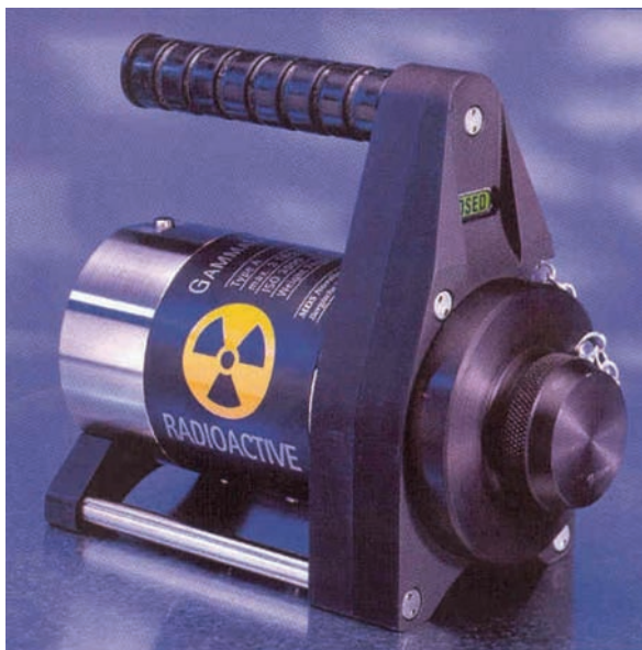
FIG. 45. Exemple typique d'appareil moderne léger de gammagraphie (utilisant des sources de ^{75}\text{Se} ) (photographie : MDS Nordion).
