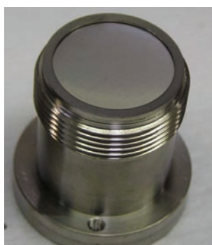
FIG. 117. Source bêta ^{85}\text{Kr} vue du côté de la fenêtre (photographie : QSA-Global).
