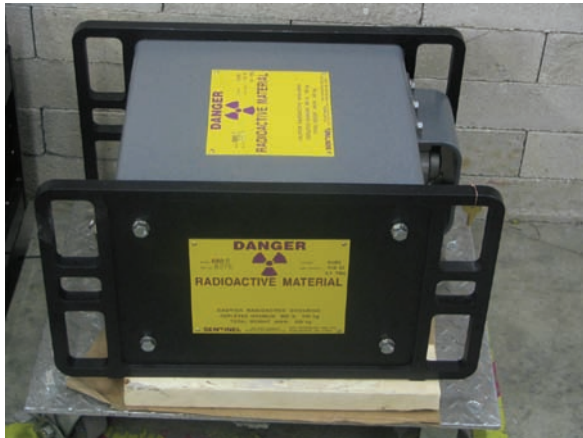
FIG. 54. Exemple typique de dispositif moderne semi-portatif de gammagraphie utilisant une source de ^{60}\text{Co} (photographie : QSA-GLOBAL).
