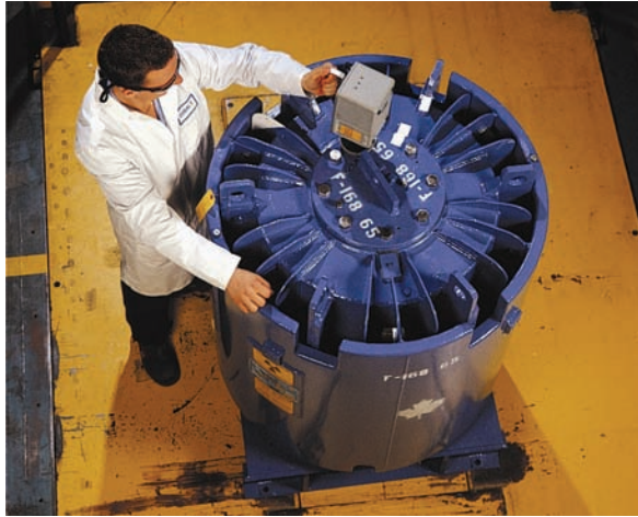
FIG. 136. Vérification des débits de dose à la surface avant l'expédition d'un conteneur de source gamma de haute activité (photographie : MDS Nordion).
