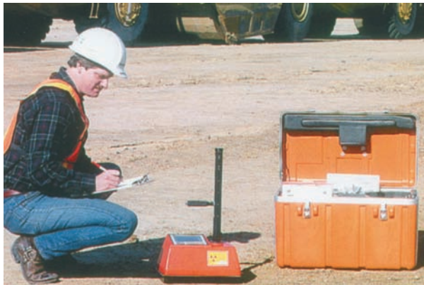
FIG. 78. Exemple typique d'humidimètre/densimètre avec sa caisse de transport (photographie : CPN International).
