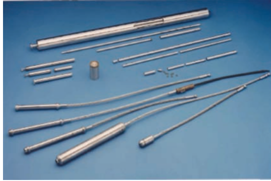
FIG. 104. Assortiment de sources de ^{60}\text{Co} destinées à des irradiateurs (photographie : REVISS).
