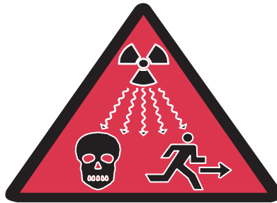
FIG. 3. Nouveau symbole de mise en garde destiné à décourager l'accès à une source radioactive.
