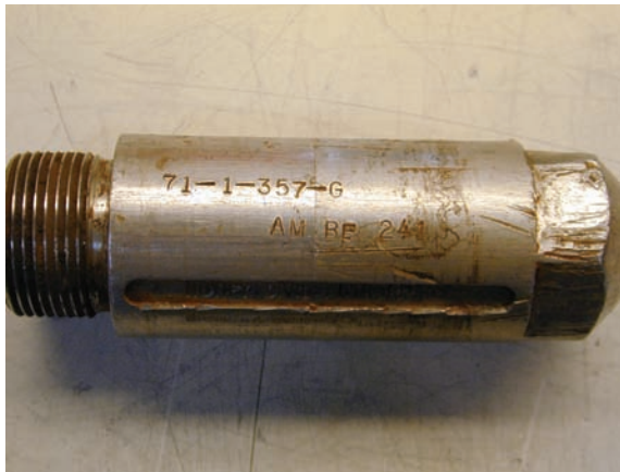
FIG. 38. Source de neutrons ^{241}\text{Am}/\text{Be} typique utilisée en diagraphie pétrolière.
