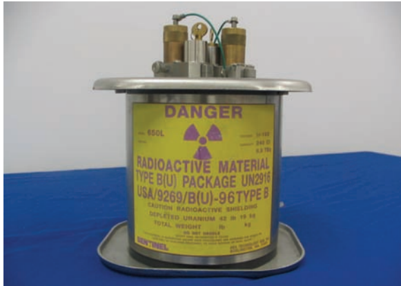
FIG. 139. Échangeur de source prêt à être couplé à un dispositif de radiographie pour procéder à l'échange de la source (photographie : QSA).
