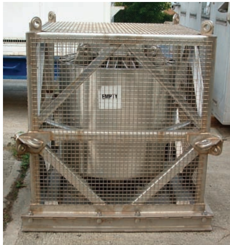
FIG. 135. Conteneur pour source gamma de haute activité à l'intérieur d'une cage destinée à empêcher le contact avec ses surfaces chaudes (photographie : REVISS).
