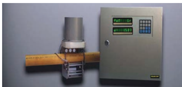
FIG. 70. Exemple typique de jauge à transmission ( ^{241}\text{Am} ) installée sur une section de tuyau.
