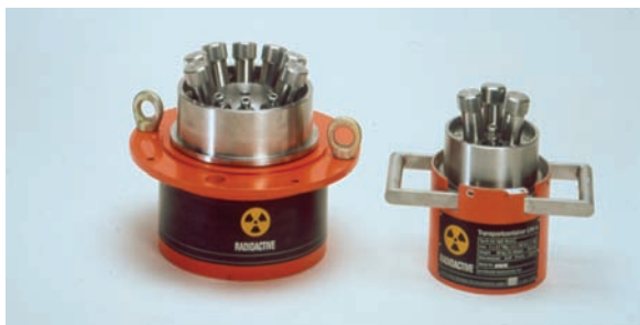
FIG. 141. Échangeurs de sources multiples prêts à être couplés à un dispositif de radiographie en vue de procéder à l'échange des sources (photographie : MDS Nordion).
