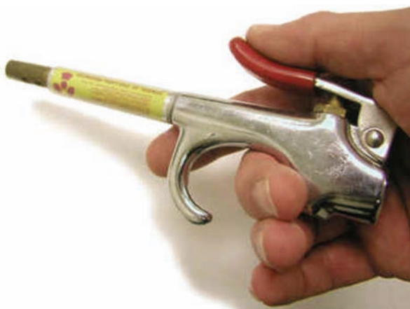
FIG. 90. Exemple typique de pistolet antistatique à air (photographie : Oak Ridge Associated Universities).
