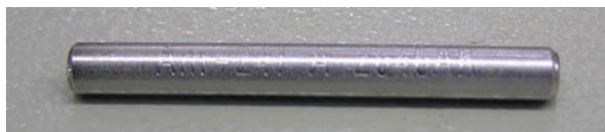
FIG. 124. Source ponctuelle de rayonnement gamma de faible énergie pour travaux d'analyse (photographie : QSA-Global).
