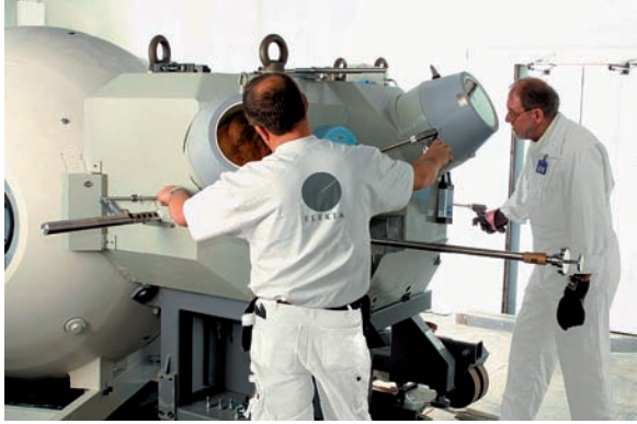
FIG. 21. Exemple typique de système de rechargement pour scalpel gamma (photographie : Elekta).
