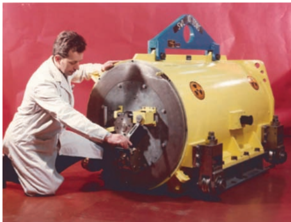
FIG. 137. Conteneur prêt à être chargé dans une installation d'irradiation.
