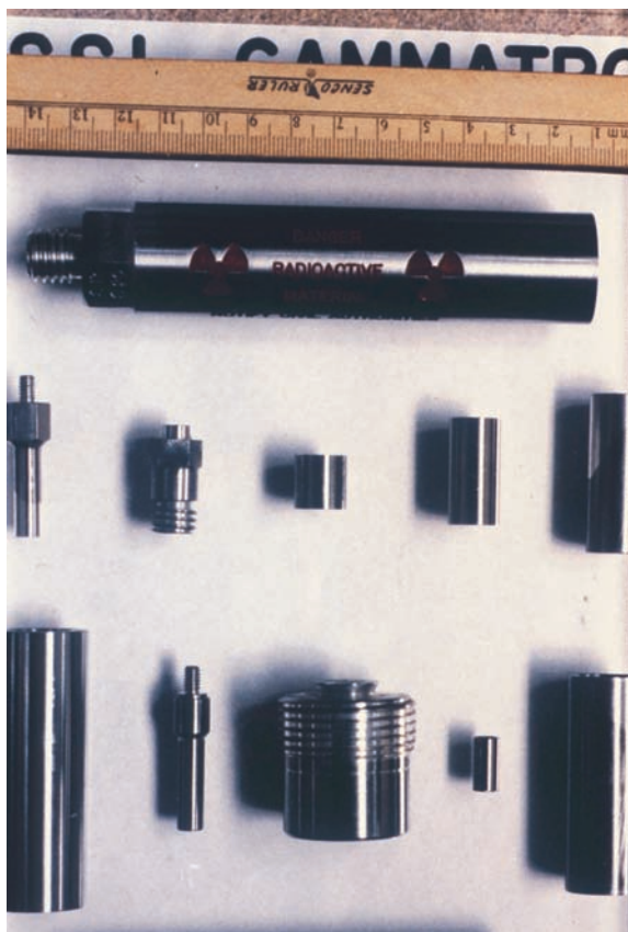
FIG. 114. Assortiment de sources ^{241}\text{Am}/\text{Be} et ^{137}\text{Cs} utilisées en diagraphie pétrolière (photographie : NRC).
