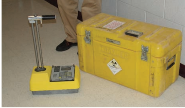
FIG. 77. Exemple typique d'humidimètre/densimètre avec sa caisse de transport (photographie : Troxler Labs).
