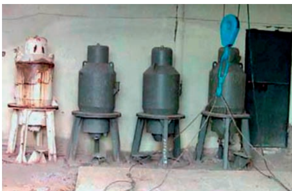
FIG. 26. Irradiateurs mobiles contenant 3500 Ci de césium (ex-Union soviétique).
