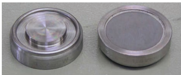
FIG. 125. Exemple typique de source gamma de faible énergie pour travaux d'analyse (grand diamètre) : on peut voir, à droite, le côté de la fenêtre en béryllium et, à gauche, le côté soudé (photographie : QSA-Global).
