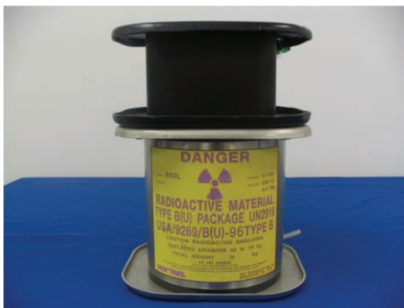
FIG. 138. Échangeur de source en configuration de transport (photographie : QSA).
