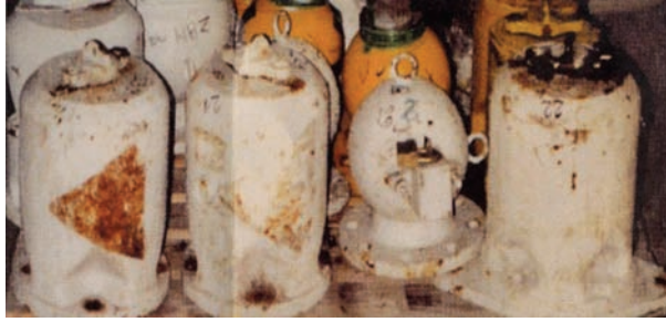
FIG. 62. Conteneurs de sources de jauges à rayonnement gamma déclassés.
