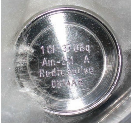
FIG. 119. Vue du côté soudé d'une source gamma ^{241}\text{Am} de faible énergie étendue (diamètre : environ 40 mm) (photographie : QSA-Global).
