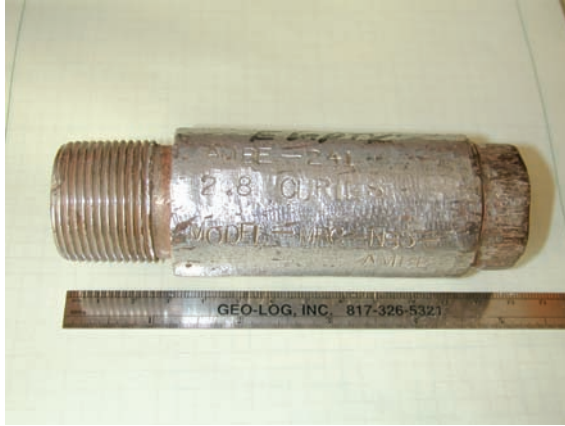
FIG. 37. Source de neutrons ^{241}\text{Am}/\text{Be} typique utilisée en diagraphie pétrolière — endommagée lors de l'utilisation normale.
