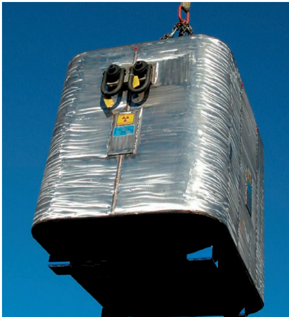
FIG. 17. Suremballage blindé destiné au transport d'un irradiateur de sang (photographie : MDSI Nordion).
