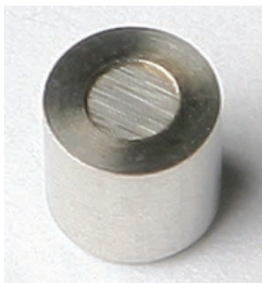
FIG. 127. Exemple typique de source gamma de faible énergie (petit diamètre), vue du côté de la fenêtre en béryllium (photographie : IPL).
