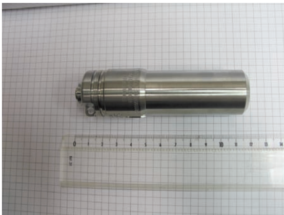
FIG. 34. Source typique de 137 Cs utilisée comme tête de sonde (bull plug) en diagraphie pétrolière (photographie : Schlumberger).
