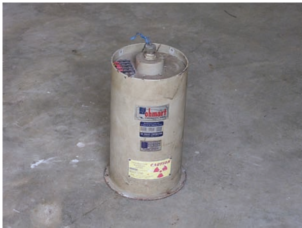
FIG. 67. Exemple typique de conteneur pour source de jauge à rayonnement gamma.
