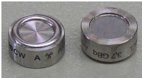
FIG. 126. Exemple typique de source gamma de faible énergie pour travaux d'analyse (diamètre intermédiaire) : on peut voir, à droite, le côté de la fenêtre en béryllium et, à gauche, le côté soudé (photographie : QSA-Global).
