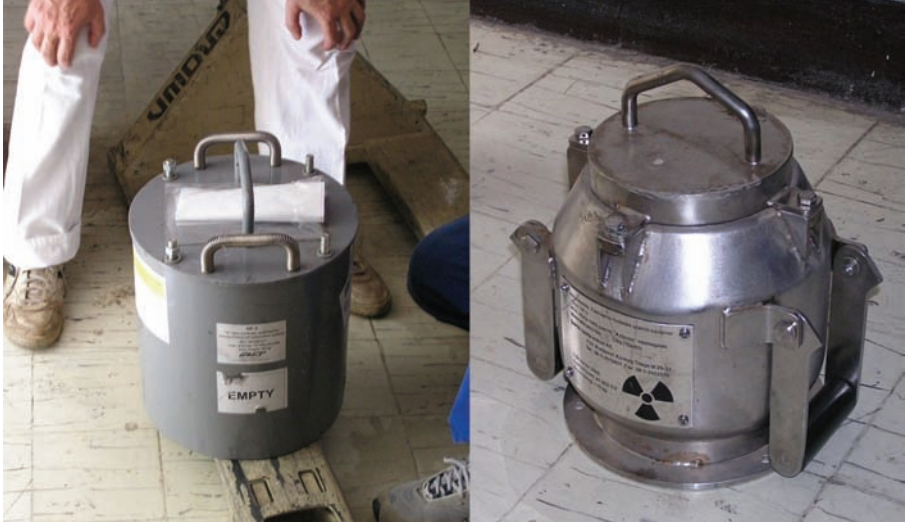
FIG. 142. Enveloppe externe et conteneur blindé interne d'un colis utilisé pour le transport de sources gamma de haute énergie.
