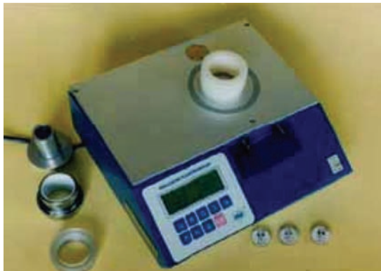
FIG. 81. Appareil d'analyse par fluorescence X de laboratoire.
