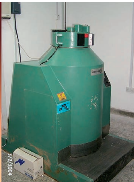
FIG. 19. Modèle ancien d'irradiateur de sang.
