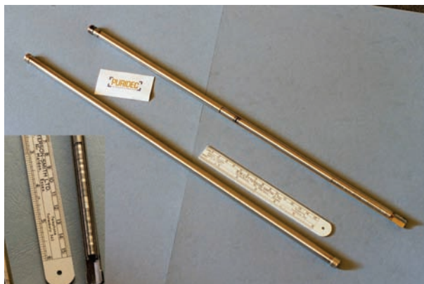
FIG. 102. Exemples typiques de sources de stérilisation industrielle ; les pastilles de cobalt métalliques sont visibles en bas à gauche (photographie : REVISS). Dimensions approximatives : 11 mm de diamètre \times 450 mm de longueur ; activité typique à l'état neuf : 444 TBq (12 kCi) de ^{60}\text{Co} .
