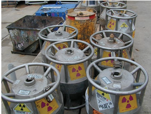
FIG. 41. Conteneurs typiques utilisés pour le transport et le stockage des sources neutroniques de diagraphie pétrolière.
