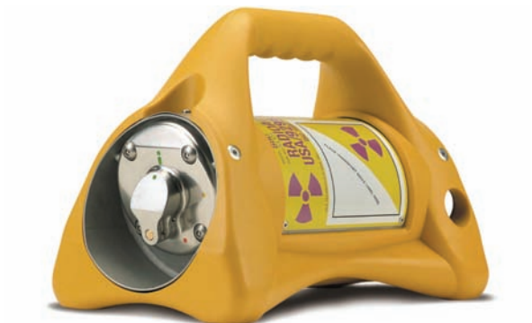
FIG. 47. Exemple typique d'appareil portatif moderne de gammagraphie (photographie : QSA-GLOBAL).
