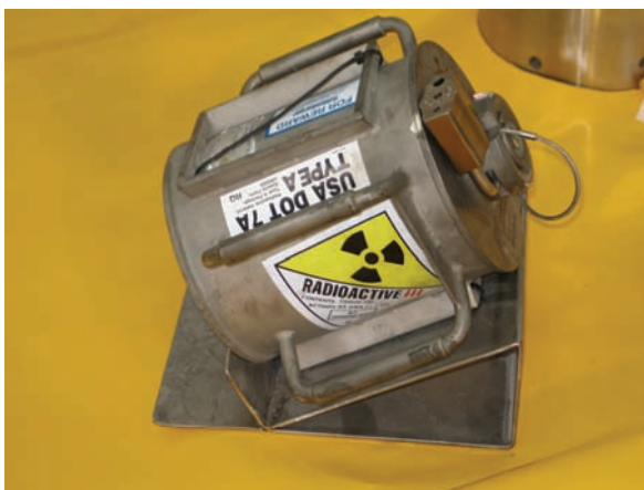
FIG. 35. Conteneur blindé typique servant au transport des sources de 137 Cs utilisées en diagraphie pétrolière, 37 kg × 170 mm de diamètre × 210 mm de longueur (photographie : Schlumberger).
