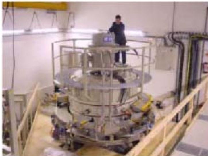
FIG. 8. TT1000 Cavity: Rhodotron.
