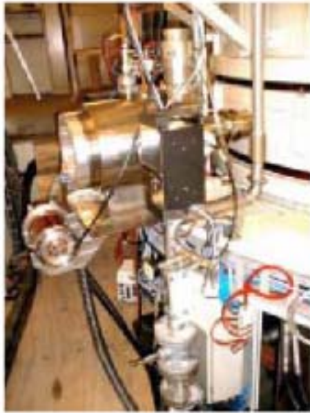
FIG. 10. TT1000 Electron Gun: Rhodotron.
