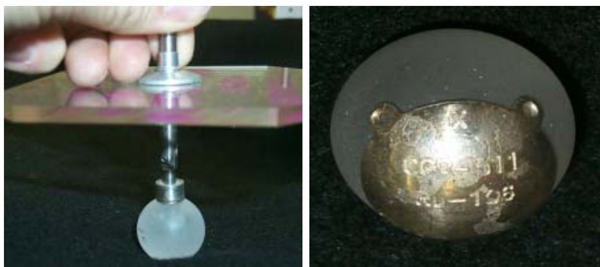
FIG. 2. Izquierda: Placa ocular de ^{90}\text{Sr}/^{90}\text{Y} aplicada a un maniquí plástico de un ojo. Derecha: Aplicador oftalmológico de ^{106}\text{Ru}/^{106}\text{Rh} con dos agujeros para suturar.
