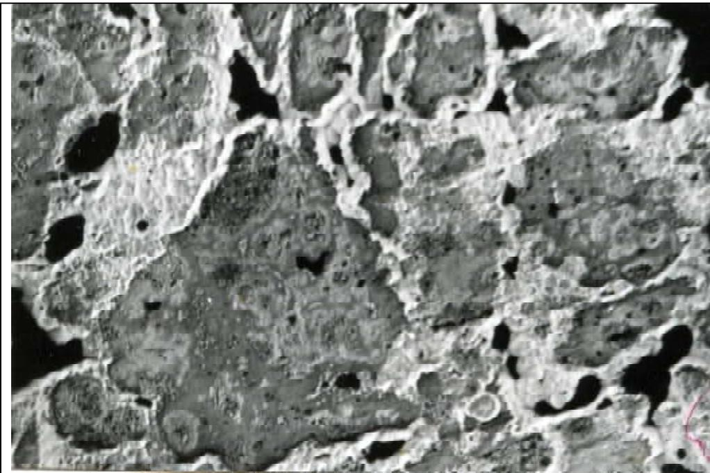
*Fig. 12. GSP graphite structure.*
