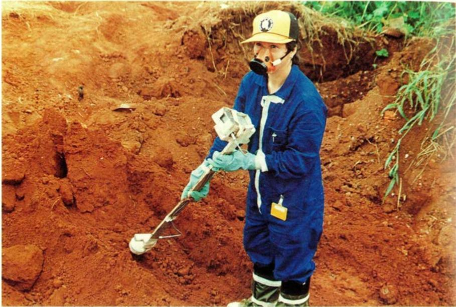
19. Дозиметрический контроль грунта.
