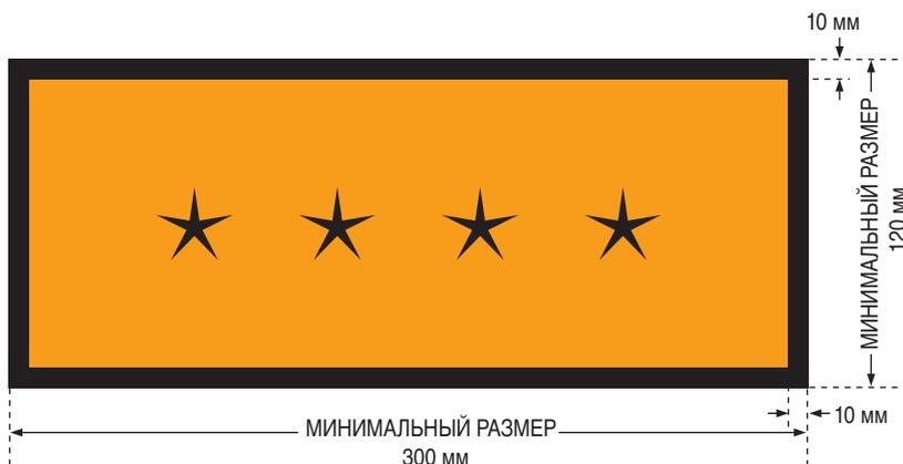
РИС. 7. Предупредительный знак для отдельного изображения номера ООН. Цвет фона знака – оранжевый, рамка и номер ООН – черные. Знак "\*\*\*\*" обозначает место, где должен помещаться соответствующий номер ООН для радиоактивного материала согласно таблице 8.
