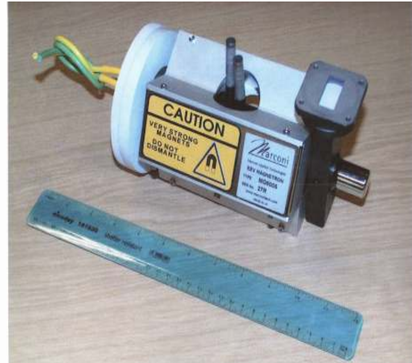
E2V X-band magnetron: 9300MHz, 1.~1.5MW, 4 \mu s, 250Hz
