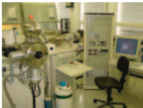
FIG. 21. Thermal ionization mass spectrometer.
