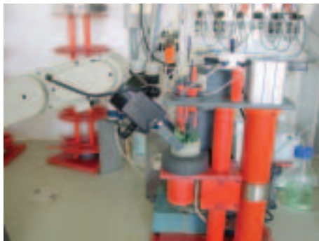
FIG. 16. Automatic U titrator.
