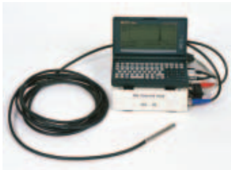
FIG. 4. MMCA: Miniature Multichannel Analyser (MMCA) with CdZnTe detector.
