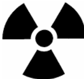
Fig. 11. Símbolo de identificación de material radiactivo
