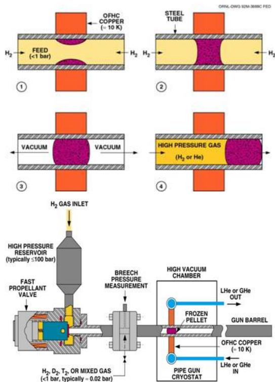
Figure 10 Pipe gun injector for MPI DMS
