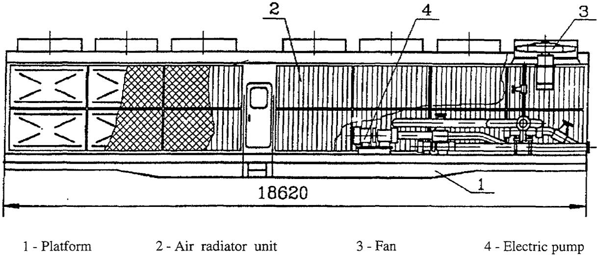
*Fig. 5. Air radiator module.*
