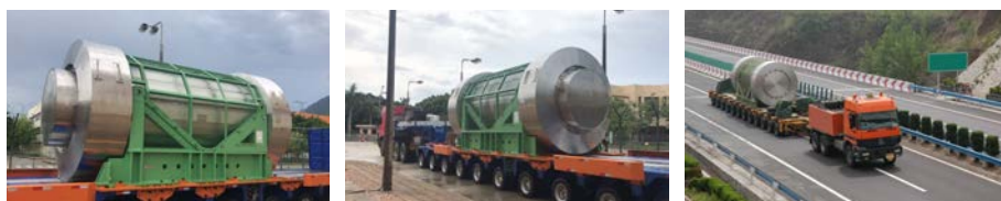
РИС. 52. Транспортно-упаковочный контейнер NAC-STC, перевозимый грузовым автотранспортом по шоссе (публикуется с разрешения НАК).
