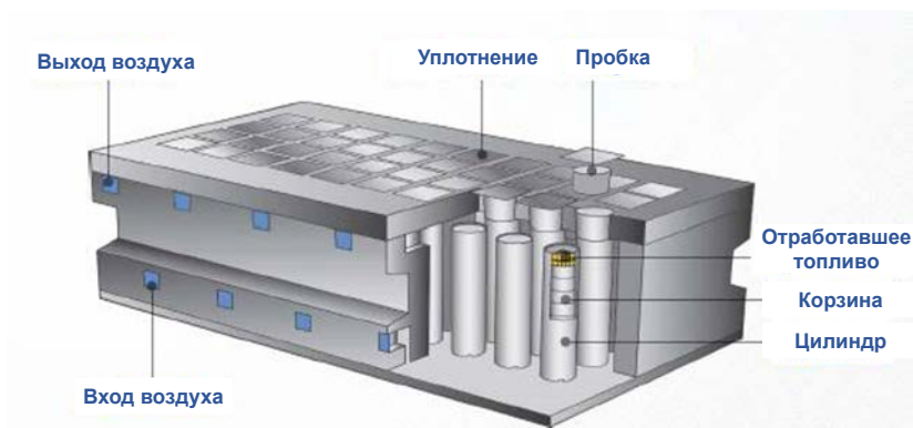
РИС. 32. MACSTOR 400 в разрезе (публикуется с разрешения Корейской компании по гидро- и ядерной энергетике, Республика Корея).
