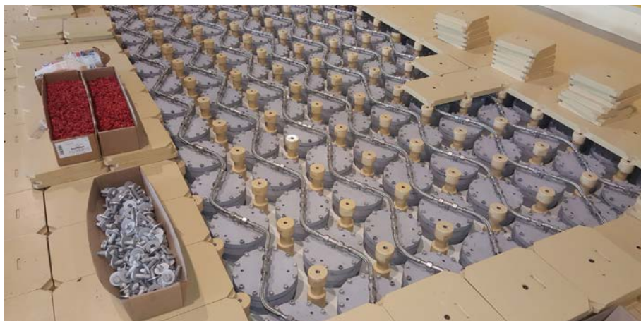
РИС. 41. Вид крупным планом верхней части направляющих трубок для хранения на АЭС «Паки», Венгрия.
