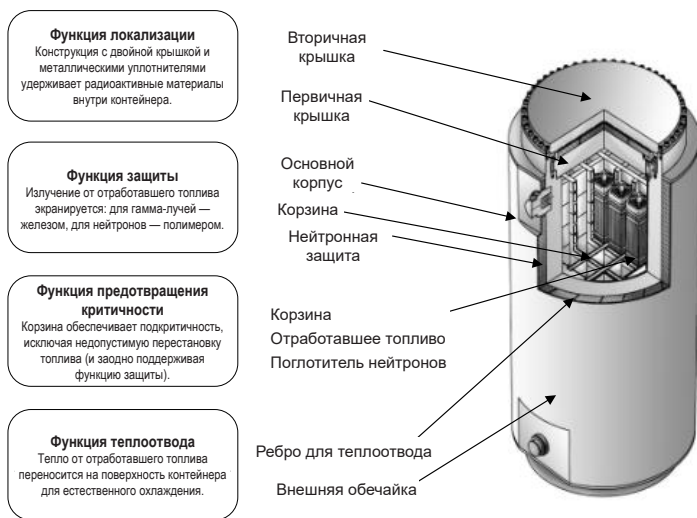
РИС. 44. Принципиальная схема металлического транспортно-упаковочного контейнера и функции безопасности при хранении отработавшего топлива (воспроизводится с разрешения из издания Saegusa, T. (2015). Basis of Spent Nuclear Fuel Storage , ERC Publishing Co., Ltd.).
