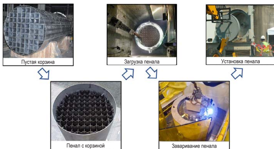
РИС. 10. Пример основных этапов загрузки отработавшего топлива в систему пенального типа (публикуется с разрешения «Орано федерал сервисиз»).
