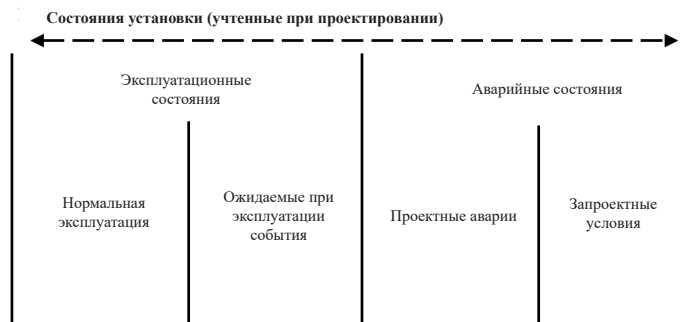
РИС. 45. Состояния установки, учитываемые при проектировании. Воспроизведено из [18].
