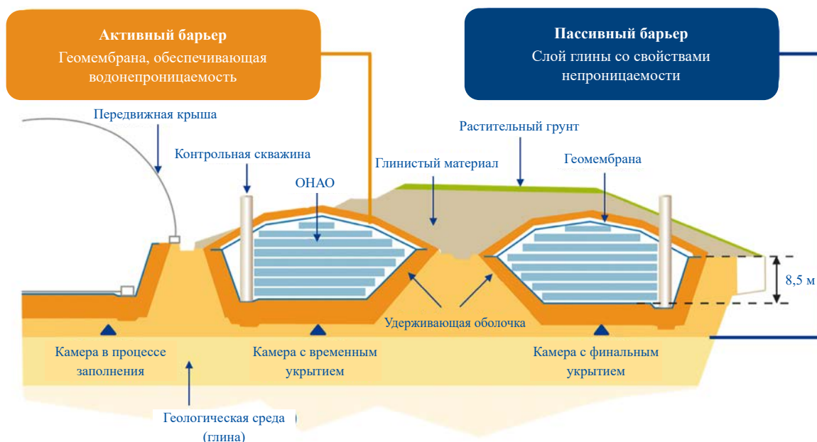
Рис. 19. Поперечный разрез ячеек для захоронения траншейного типа в центре «CIREС» (иллюстрация: «Андра»).
