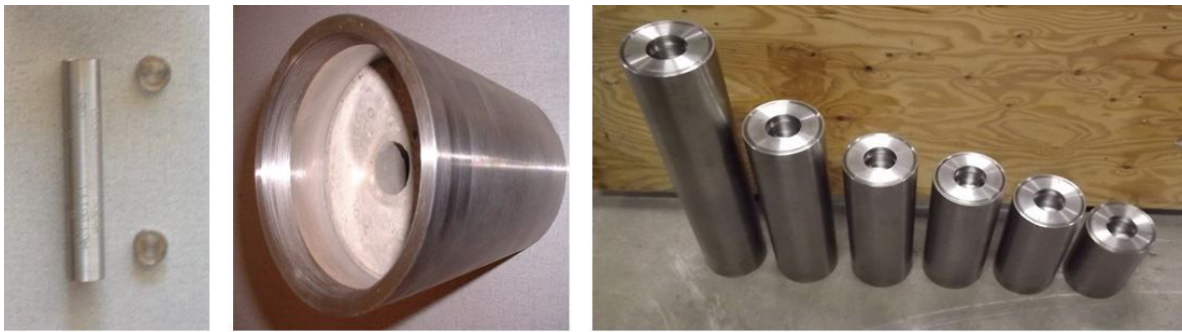
РИС. 51. Стандартизированная конструкция упаковки отходов для ИЗРИ. Капсула из нержавеющей стали (слева) диаметром 7 см; внутренний цементный буфер (в центре) различных размеров (справа).
