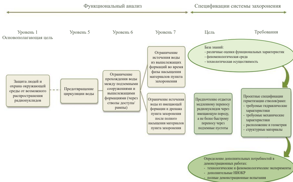
РИС. 8. Схема применения в Промышленном центре геологического захоронения («Сижео») проектных требований, предъявляемых к герметизации шахтного ствола/рампы (иллюстрация: Национальное агентство по обращению с радиоактивными отходами («Андра»)).
