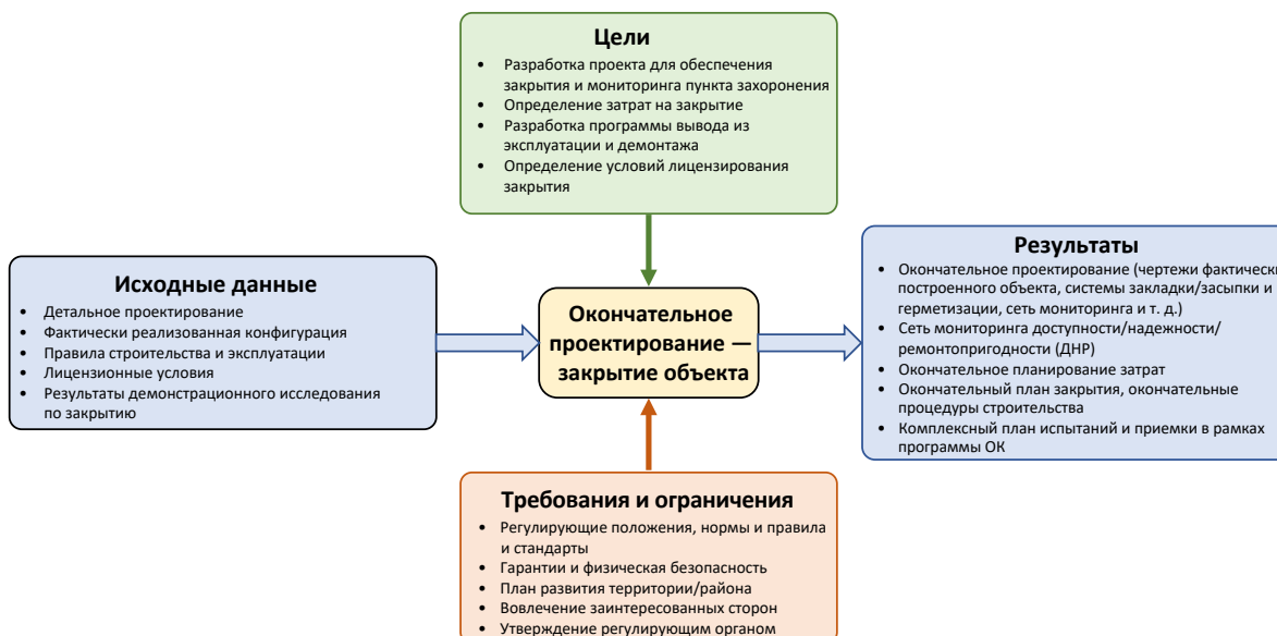
РИС. 15. Окончательное проектирование закрытия пункта захоронения: цели, исходные данные, ограничения, требования и результаты.
