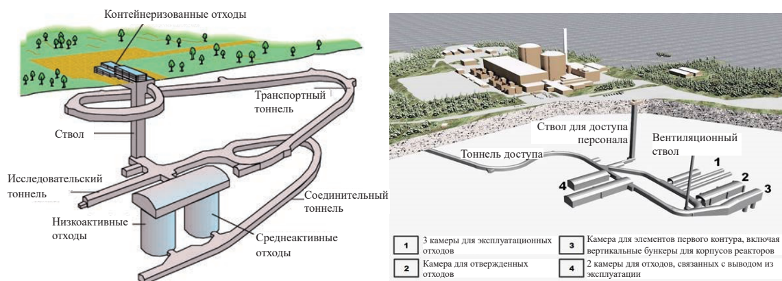
РИС. 29. Концепции проектирования подповерхностного захоронения САО на средней глубине на площадках в Финляндии: концепция захоронения в цилиндрических бункерах (слева) (иллюстрация: «Теоллисууден войма ой») и концепция захоронения в горизонтальных выработках (справа) (иллюстрация: АЭС «Ловиуса»).
