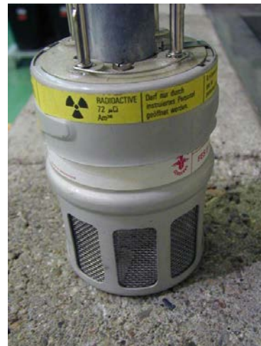
(d) Model with a single radionuclide/multiple SRS, ^{241}\text{Am} .
