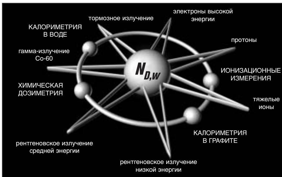
РИС. 1. Согласованная система дозиметрии, основанная на эталонах единицы поглощенной дозы в воде. Первичные эталоны, основанные на калориметрии в воде и графите, химической дозиметрии и ионизационных методах, позволяют калибровать ионизационные камеры в единицах поглощенной дозы в воде, N_{D,w} . Единые практические рекомендации обеспечивают методологию определения поглощенной дозы в воде для пучков фотонов низких, средних, ^{60}\text{C} и высоких энергий фотонов, электронов, протонных пучков и пучков тяжелых ионов используемых в дистанционной лучевой терапии.
