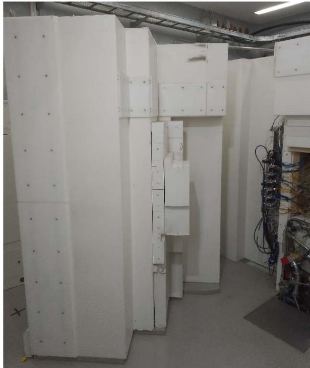
*FIG. 9. Ciclotrón con autoblandaje abierto.*
