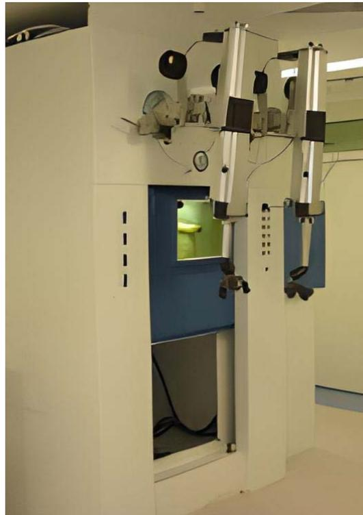
*FIG. 4. Celda caliente con manipuladores reproducida de la Ref. [11] con permiso.*
