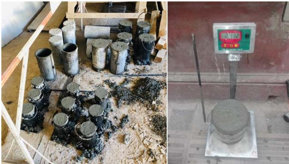
*FIG. 24. Elaboración de probetas y medición de densidad del hormigón a pie de camión.*
