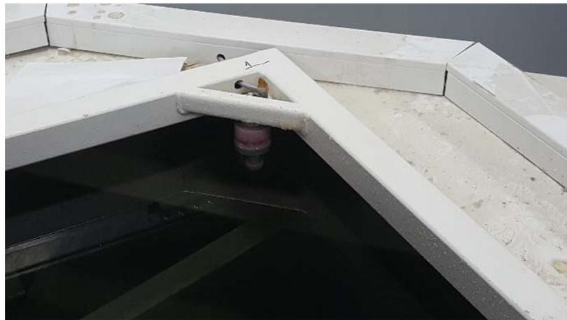
*FIG. 18. Sensor del nivel de líquido del autoblandaje de un ciclotrón.*
