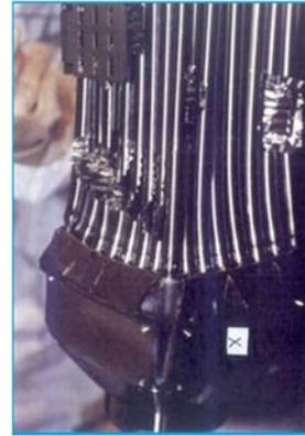
РИС. 35. Свежая ТВС BWR после испытания падением с высоты 9 м (рисунок предоставлен «ТН интернэшнл» и «ИНС, лтд.» [7]).
