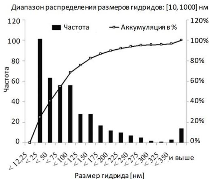
РИС. 22. Гистограмма в диапазоне ТЭМ, показывающая распределение размеров гидридов, с погрешностью, вызванной малыми размерами. Максимальная частота отмечена в диапазоне 20–30 нм (предоставлена НКАЭ [7]).
