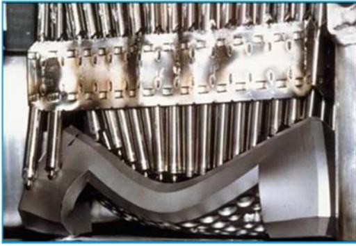
РИС. 34. Свежая ТВС PWR после испытания падением с высоты 9 м (рисунок предоставлен «ТН интернэшнл» и «ИНС, лтд.» [7]).
