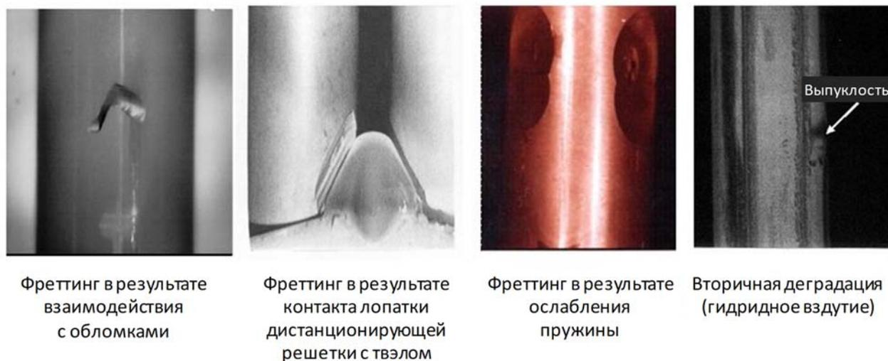
РИС. 56. Повреждение твэлов в результате фреттинга и вторичной деградации (фотографии предоставлены «Фрамотом АНП ГмбХ» [4]).
