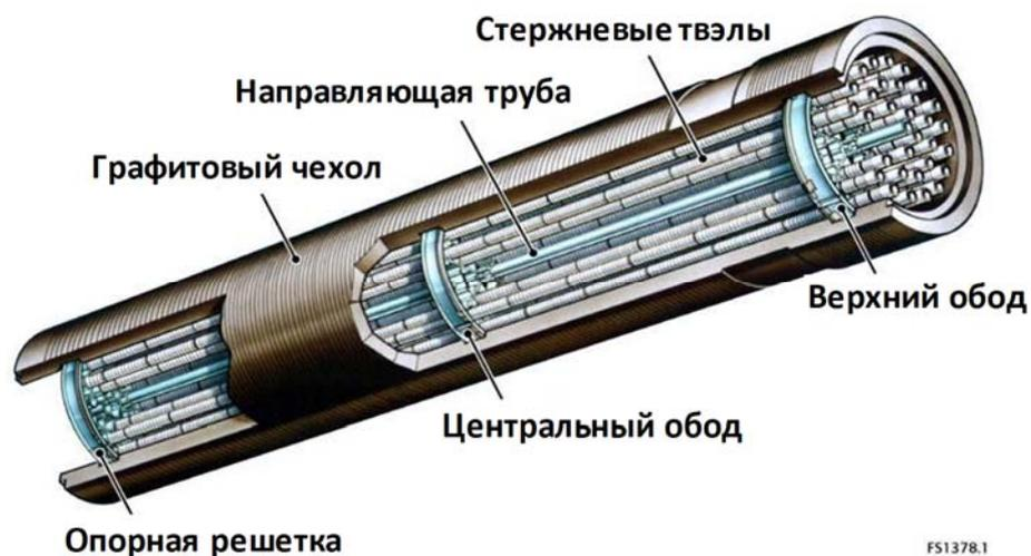
РИС. 4. Тепловыделяющая сборка AGR (рисунок предоставлен «Селлафилд, лтд.»).
