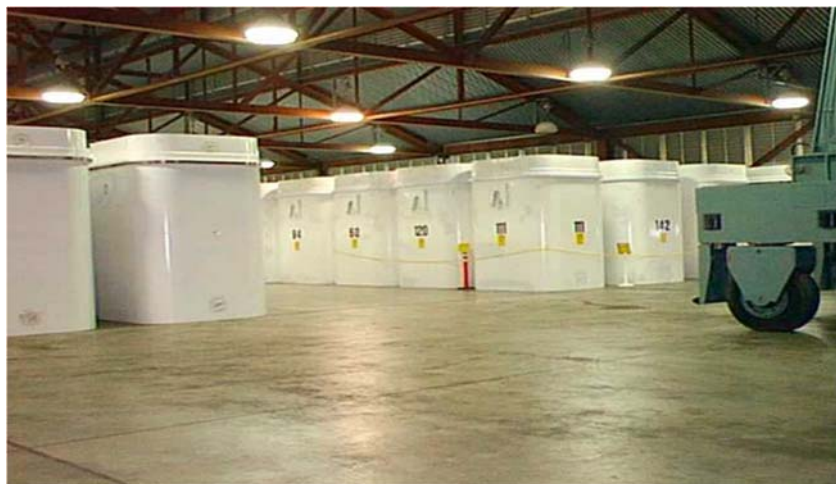
图 11. CANDU 乏燃料干法贮存屏蔽容器（由 OPG 供图）。
