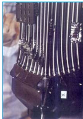
图 35. 做过 9 m 跌落试验的 BWR 新燃料组件（由 TN International 及 INS Ltd 供图[7]）。
