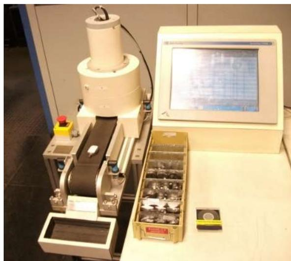
*FIG. 4. Espectrómetro gamma para probetas*
