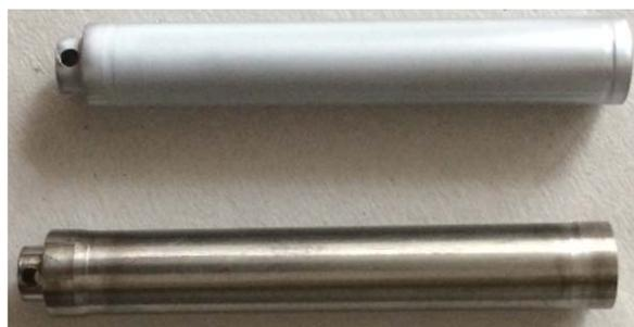
РИС. 127. Образцы с Cr покрытием (вверху) и эталонные образцы из Zr (внизу).
