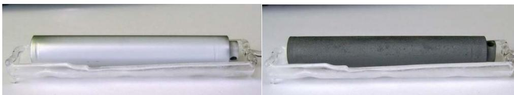
Рис. 131. Образец IAEA-01 с Cr покрытием в кварцевом тигле до (слева) и после (справа) окисления в атмосфере воздуха при 1200°С в течение 3600 с.
