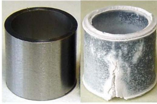
*РИС. 132. Образец из Zr до (слева) и после (справа) окисления в атмосфере воздуха при 1200°C в течение 2700 с с нормализованным привесом массы  $\Delta m/A=491 \text{ г/м}^2$ .*
