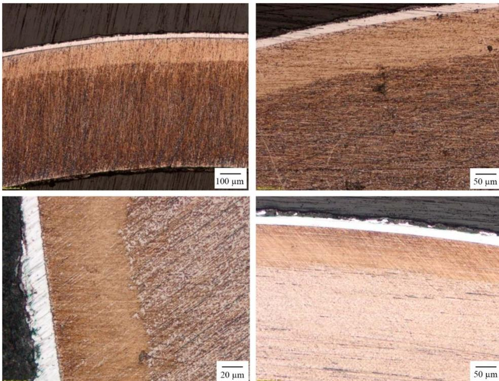
РИС. 144. Металлографические изображения образца IAEA-06 (Zr1Nb с Cr покрытием).
