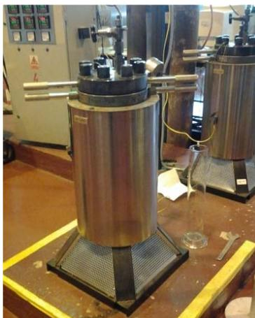
РИС. 10. Автоклав, использовавшийся для проведения статических испытаний.
