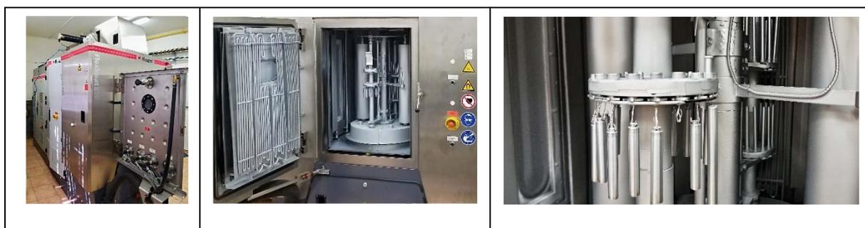
Рис. 2. Фотографии установки «Hauzer Flexicoat 850» в ЧТУ в Праге. Общий вид системы (слева); камера для осаждения (в центре); вращающиеся держатели образцов с Cr мишенью на заднем плане (справа) (воспроизводятся с разрешения компании «Эльсевир»[182]).
