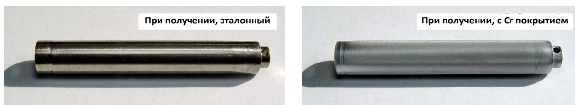
РИС. 128. Эталонный образец из Zr (слева) и образец из Zr с покрытием (справа) по получении и до окисления.
