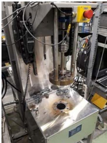
Рис. 11. Схематическая структура контура рециркуляции воды, включая автоклав, (вверху) и фотография автоклава, использованного в данной кампании испытаний (внизу).
