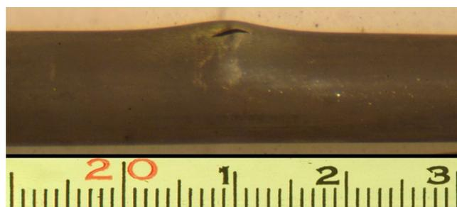
РИС. 34. Отверстие в месте разрыва, IFA-650.11.
