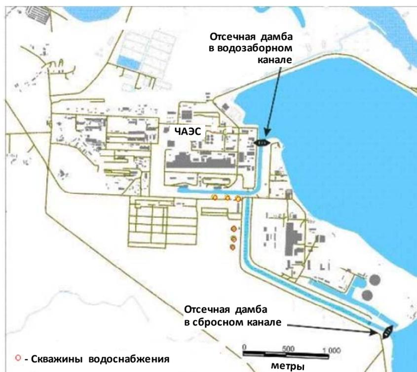
РИС. 9. Схема технологического водохранилища для замены водоема-охладителя с перекрытием водозаборного и сбросного каналов водоема-охладителя.
