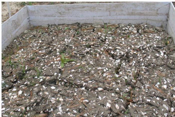
РИС. 65. Кассета с обнаженными донными отложениями водоема-охладителя (октябрь 2012 года) (воспроизведено с разрешения В. Протсака, УкрНИИСХР).
