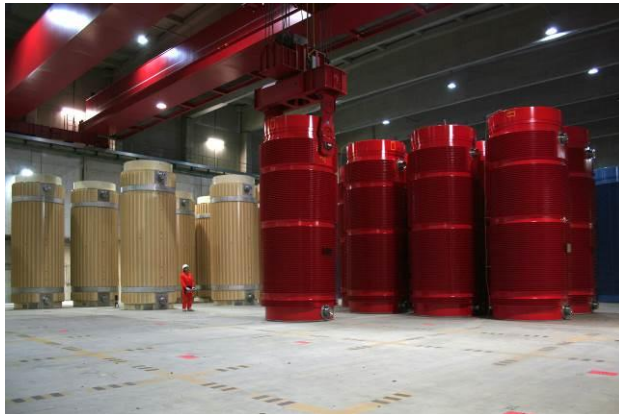
الشكل ١٠ - براميل من نوع CASTOR في مدينتي آهاوس وغورليبين في ألمانيا (الصورتان مقدمتان من شركة GNS).
