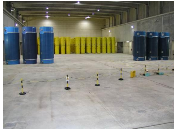
الشكل ١٠ - براميل من نوع CASTOR في مدينتي آهاوس وغورليبين في ألمانيا (الصورتان مقدمتان من شركة GNS).
