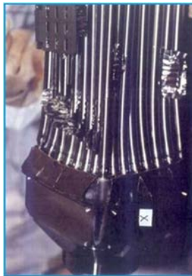
الشكل ٣٥ - قضيب وقود طازج لمفاعل ماء مغلي بعد اختبار سقوط من ارتفاع ٩ أمتار (الصورة مقدمة من شركة TN International وشركة INS Ltd. [٧]).
