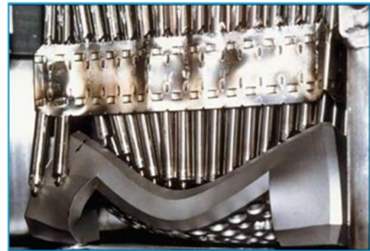
الشكل ٣٤ - قضيب وقود طازج لمفاعل ماء مضغوط بعد اختبار سقوط من ارتفاع ٩ أمتار (الصورة مقدمة من شركة TN International وشركة INS Ltd. [٧]).
