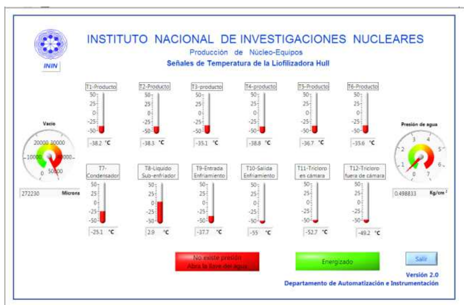
FIG. 13. Falla en el suministro de agua.
