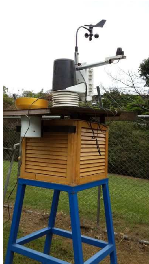
FIG. 2. Estación meteorológica compuesta con pluviómetro, radiómetro, anemómetro, sensor de dirección del viento, presión, temperatura del aire y suelo y humedad. Su programación y extracción de datos se hace mediante comunicación serial bajo protocolo RS-232.
