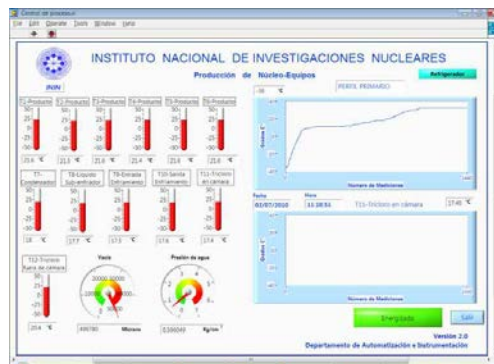
FIG. 7. Ventana del control del proceso de liofilización.
