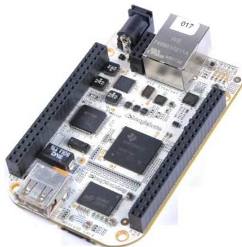
FIG. 4. Módulo Beaglebone basado en tecnología ARM con un micro-procesador Cortex-A8 de 720MHz.
