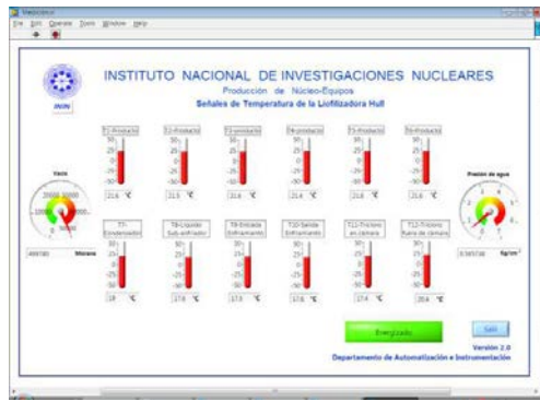
FIG. 5. Ventana que muestra los parámetros de temperatura, vacío y presión.
