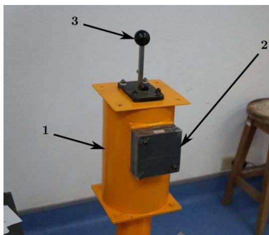
FIG. 1. Fuente de Cs-137 contenida en el blindaje (1) y en la parte superior se muestra el mecanismo de manija (3) que acciona el obturador de la fuente al desplazarlo hacia arriba y exponerla en la ventana de entrada (2).
