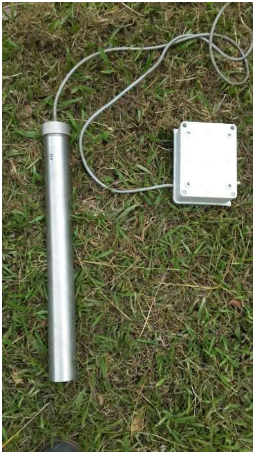
FIG. 1. Sonda de medición de Radón Cliperton II, diseñadas y fabricadas por France Telecom, la extracción de los datos y programación se realiza bajo protocolo RS-232
