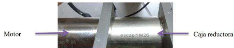
FIG. 3. Figura 3: Motor DC, acoplado a una caja reductora que permiten el movimiento a través de los ejes
