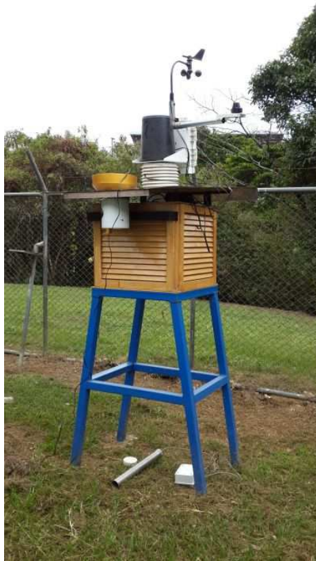
FIG. 3. Estación meteorológica y sonda de radón instaladas en el sitio de prueba en las cercanías al CICANUM.
