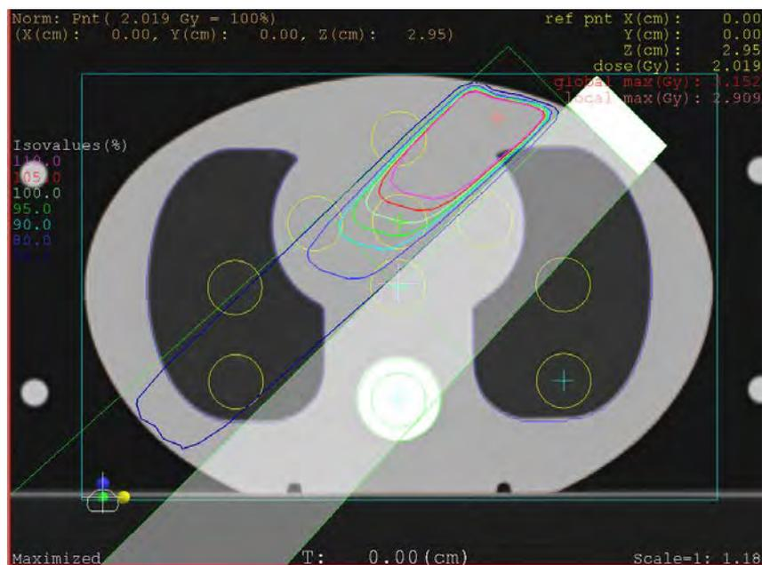
Рис. А.12. Пример распределения доз в центральной плоскости для сценария б.
