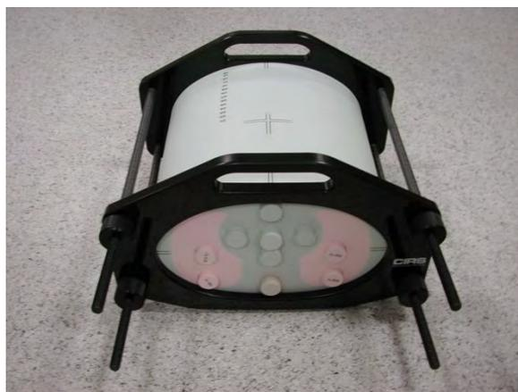
Рис. 1. Фантом грудной клетки (Модель 002LFC CIRS).
