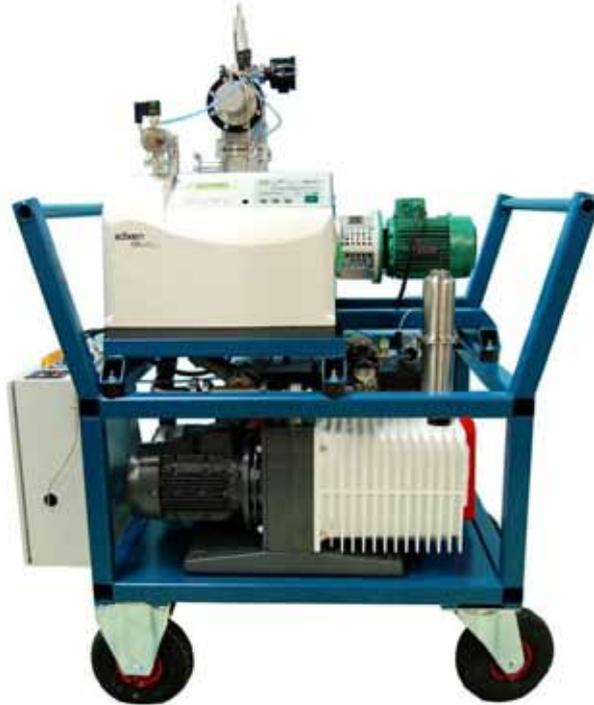
*FIG. 1.10. Portable Helium Leak Testing System.*
