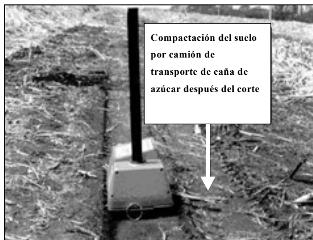
FIG. 18. Evaluación de la compactación del suelo en un campo de caña de azúcar, usando una sonda de neutrones/gamma.
