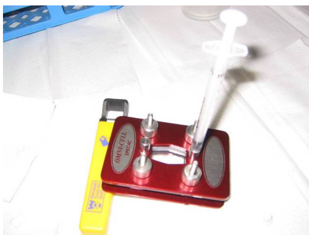
FIG. 24. Cellule de spectromètre IRTF et seringue d'un millilitre insérée dans un des orifices de remplissage. La cellule est soulevée d'un côté à l'aide d'un objet adéquat, par exemple un crayon.
