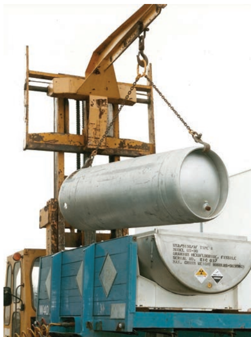
FIG. 19. UF_6 cylinder transfer.
