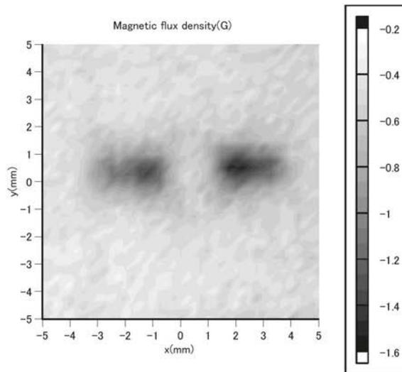
(d) Distribution of normal component around notch (SUS304)
