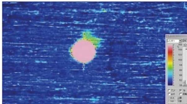
(d) Distribution of temperature increase around notch for 80% fatigue phase (STS410)
