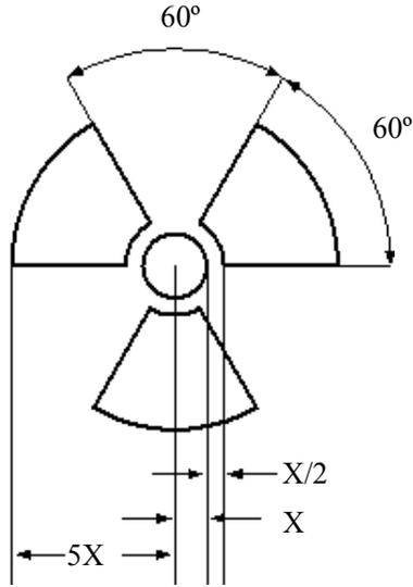
图 1. 基本的三叶形标志。其尺寸比例基于半径为 X 的中心圆。
