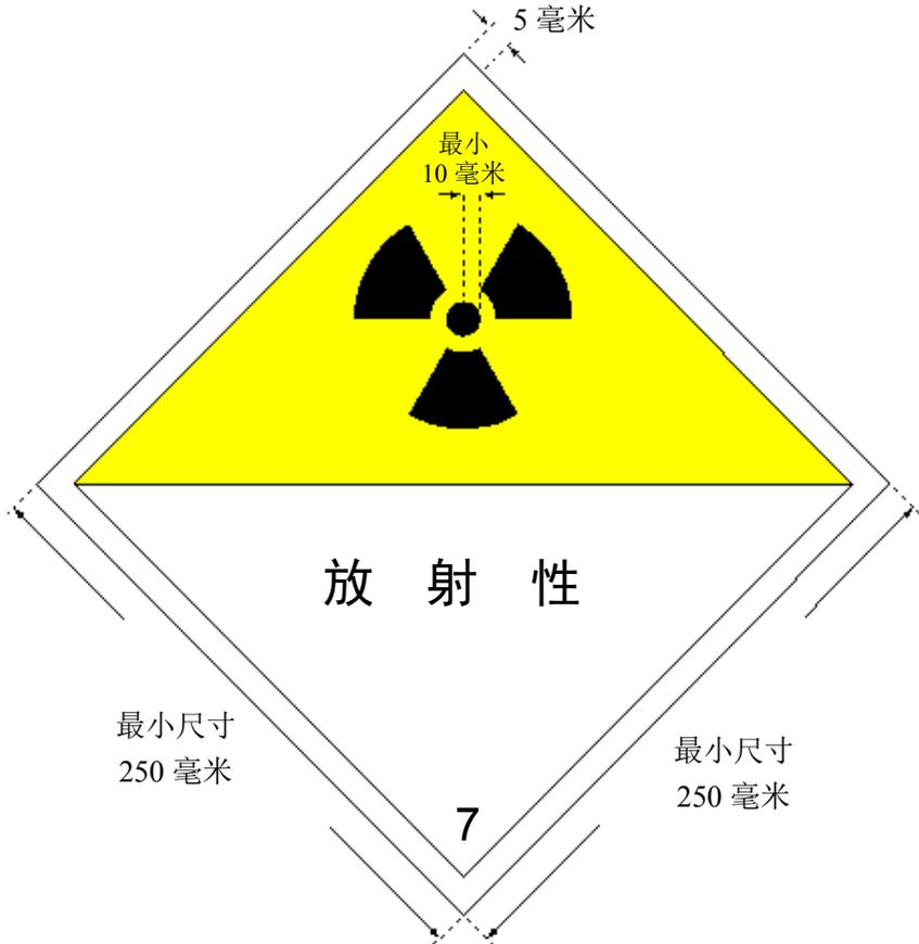
图 6. 标牌。除第 567 条允许的情况外，最小尺寸须如图所示；在采用不同尺寸时，必须保持相应的尺寸比例。数字“7”的高度不得小于 25 毫米。此标牌上半部的衬底须为黄色，下半部的衬底须为白色，三叶形标志和印字须为黑色。其下半部的“放射性”字样，是选择性的，以允许交替使用该标牌来显示与托运货物相应的联合国编号。
