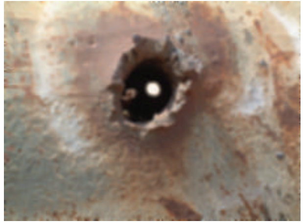
الشكل ٧: فجوة ناجمة عن اصطدام ذخيرة يورانيوم مستنفد بإحدى الدبابات المخزونة في أم القواطي.
