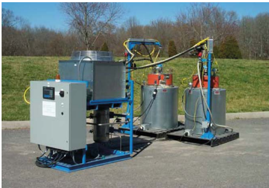
Fig. 19. Unidad de secado dentro del bidón (cortesía de Diversified Technologies Services).
