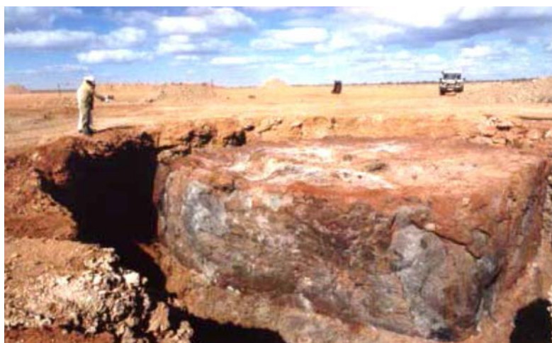
Fig. 37. Fotografía de un monolito vitrificado obtenido por vitrificación in situ (imagen tomada de la referencia [34]).
