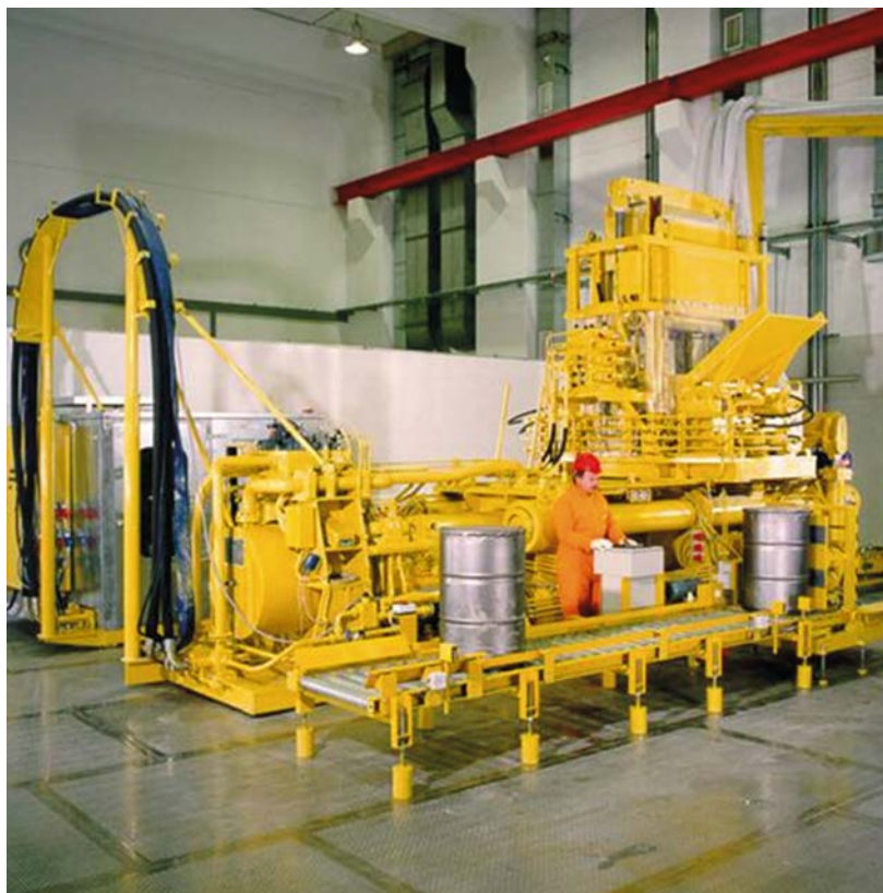
Fig. 29. Supercompactador montado sobre una plataforma (cortesía de GNS Gesellschaft für Nuklear-Service mbH).
