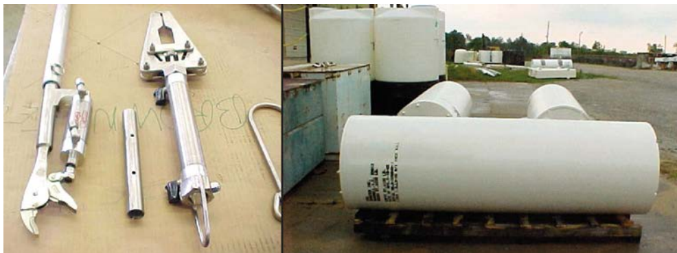
Fig. 35. Herramientas de manipulación a distancia bajo el agua (izquierda) y contenedor de componentes físicos irradiados (derecha) (cortesía de EnergySolutions).
