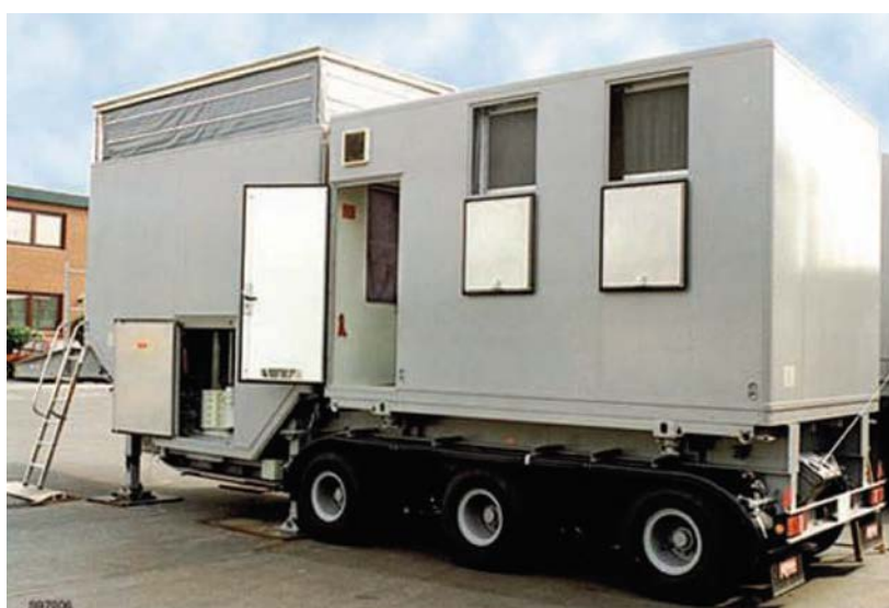
Fig. 30. Supercompactador móvil (cortesía de Nucleco).
