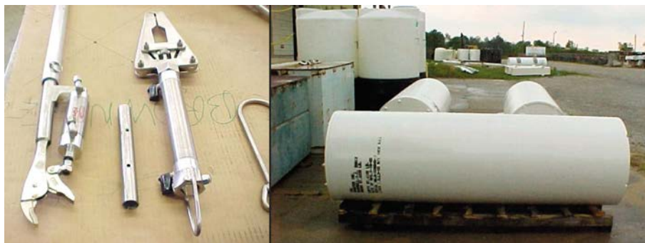
Рис. 35. Инструменты для дистанционного проведения работ под водой (слева) и контейнер для облученного оборудования (справа) (с разрешения компании «Энерджи солюшенз»).
