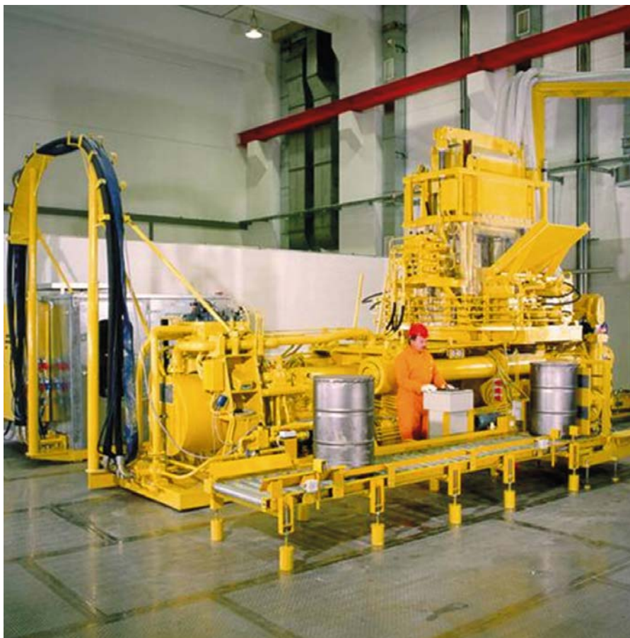
Рис. 29. Суперкомпактор с монтажом на салазках (с разрешения компании «ГНС гезельшафт фюр нуклеар сервис мбХ»).
