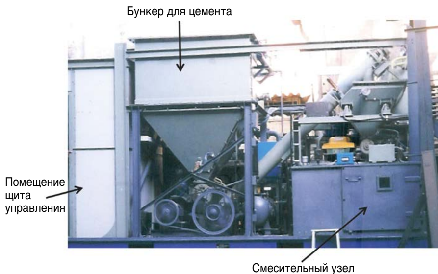
РИС. 26. Мобильный узел цементирования водных жидких отходов (с разрешения ЦАИБ).
