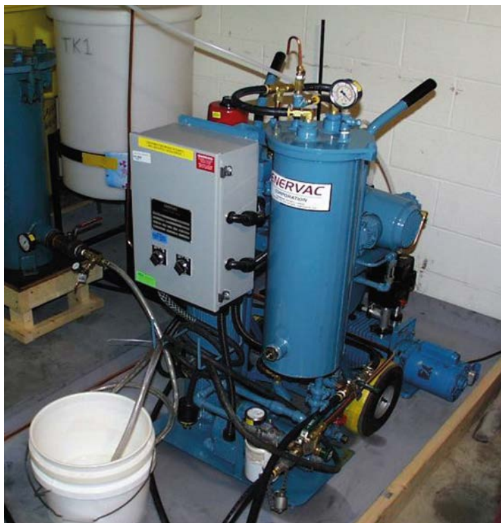
Рис. 10. Система дезактивации масла: блок вакуумного дегазатора и колонка с активированным глиноземом (с разрешения компании «Кинектрикс»).
