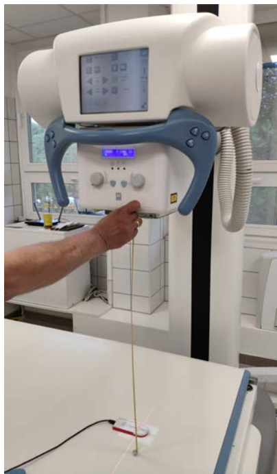
Рис. 9. Компоновка теста для проверки точности киловольтного напряжения с использованием твердотельного неинвазивного киловольтметра.
