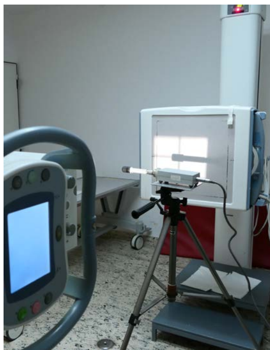
Рис. 10. Компонировка теста с ионизационной камерой для измерения воздушной кермы без аттенуаторов.
