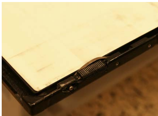
Рис. 7. Неисправная кассета, в которой царапины на экране не позволяют считывающему устройству считывать ее должным образом.
