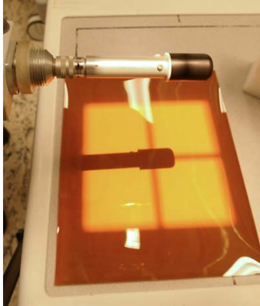
Рис. 11. Компонка теста с использованием ионизационной камеры и самопроявляющейся пленки для определения точности измерителя произведения воздушной кермы на площадь.
