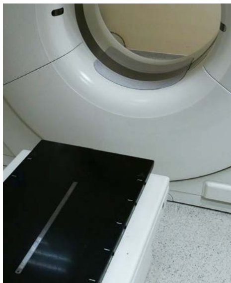
Рис. 48. Стальная линейка длиной 50 см для измерения точности метода сканирующей проекционной рентгенографии (SPR).
