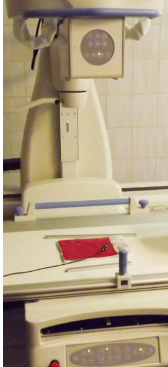
Рис. 20. Компоновка теста для проверки защитного таймера системы АКЭ со свинцовым листом, расположенным под твердотельным дозиметром.
