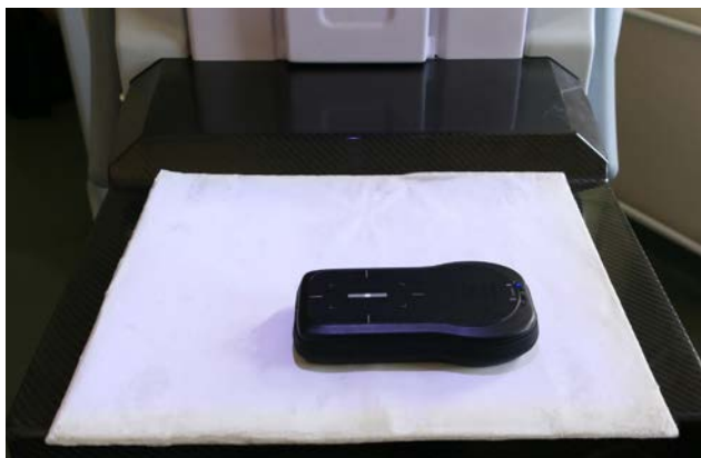
Рис. 34. Компоновка теста для измерения мощности трубки с помощью твердотельного детектора.
