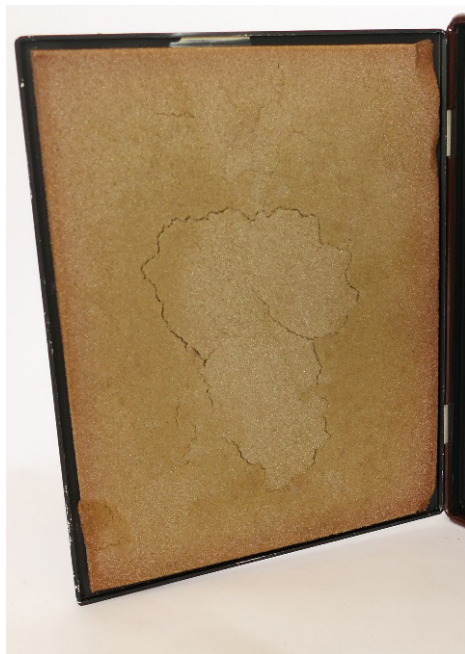
Рис.62. Кассета с высохшей пеной, создающей артефакты из-за плохого контакта пленки с экраном.
