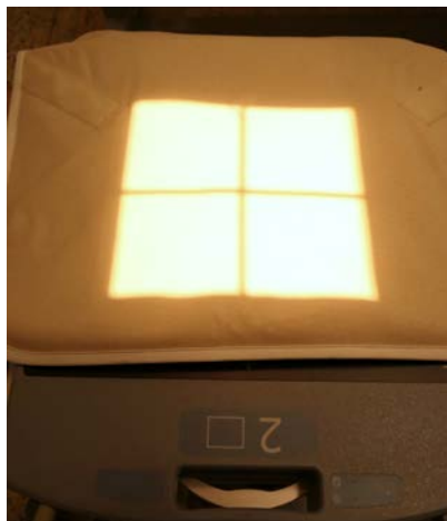
Рис. 17. Приемник цифрового рентгенографического изображения, закрытый свинцовым фартуком для проверки темнового шума.
