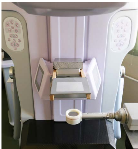
Рис. 35. Конфигурация оборудования для измерения СПО с использованием алюминиевой пластины и ионизационной камеры.
