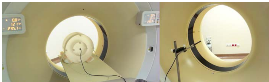
Рис. 56. Измерение дозы на стандартном фантоме тела из ПММА для определения СТДИ (слева) и измерение в свободном воздухе (справа).
