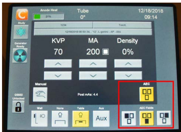
Рис. 8. Система управления, используемая для выбора ионизационных камер автоматического контроля экспозиции (здесь выбрана центральная ионизационная камера).
