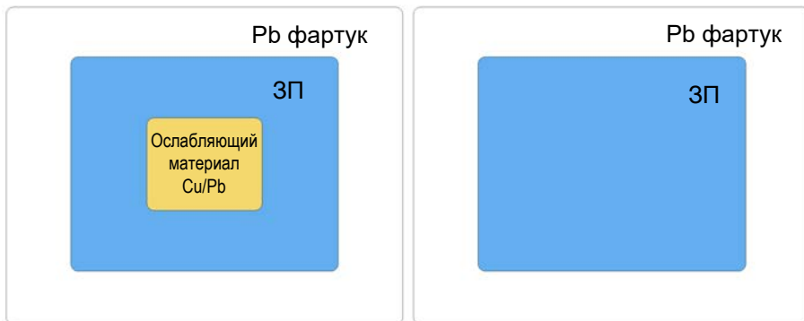
Рис. 21. Схема теста для проверки эффективности стирания изображений на запоминающих пластинах (ЗП) для компьютерной рентгенографии. (а) Экспозиция пластины для компьютерной рентгенографии с ослабляющим материалом; (б) экспозиция пластины для компьютерной рентгенографии без ослабляющего материала.
