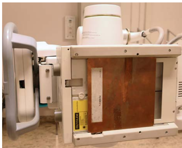
Рис. 5. Схема расположения оборудования для проверки постоянства работы датчика автоматического контроля экспозиции с использованием медного аттенюатора.
