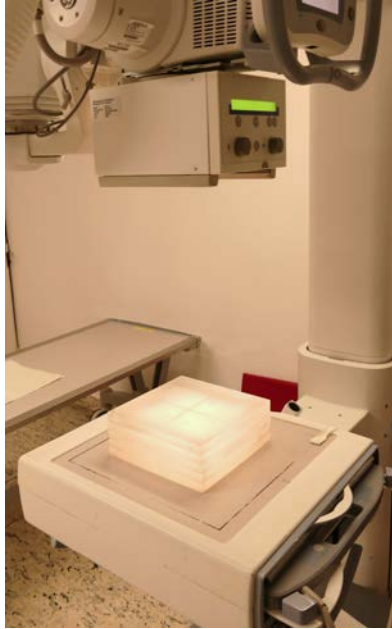
Рис. 4. Схема теста для проверки однородности изображения с использованием блока ПММА.
