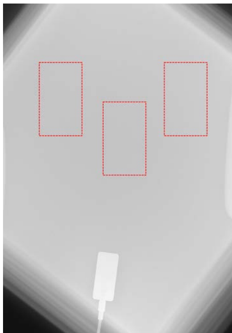
Рис. 12. Рентгеновское изображение, показывающее схему измерения дозы на приемнике изображения. Положения твердотельного детектора и ионизационной камеры системы АКЭ указаны под блоками ПММА во время измерения.
