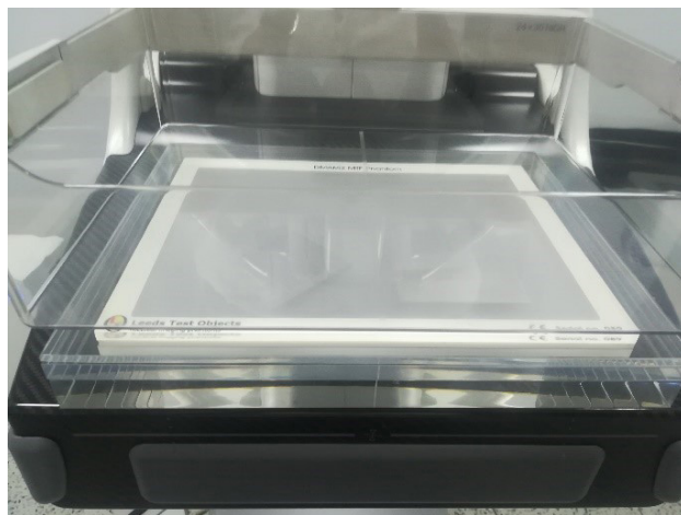
Рис. 42. Схема теста для определения функции передачи модуляции (ФПМ) с использованием фантома толщиной 10 мм, размещенного над блоком ПММА толщиной 35 мм.
