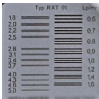
Рис. 16. Изображение штрихового шаблона, используемого для визуального определения ограниченного пространственного разрешения.
