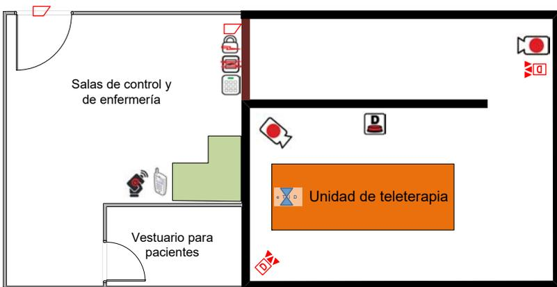
Fig. IV-5. Sistema de seguridad física que protege la unidad de teleterapia.
