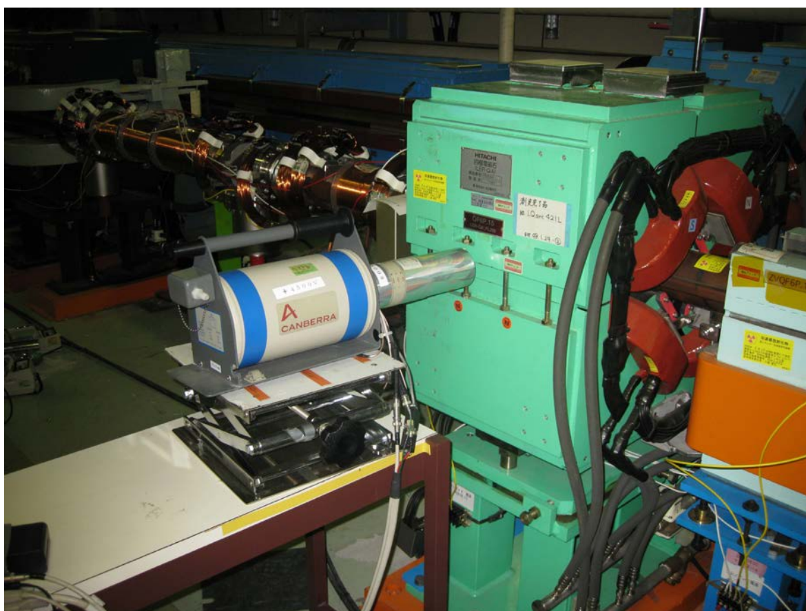
РИС. I-33. Анализ нуклидов и активности, наведенной в магнитах, с использованием германиевого детектора (воспроизведено из [I-18] с любезного разрешения К. Масумото).
