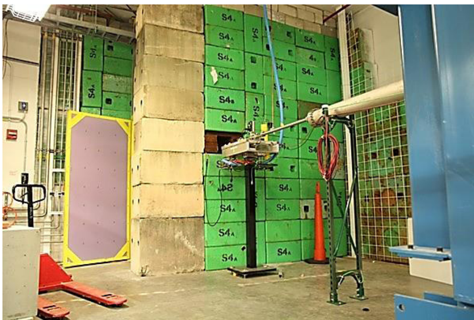
РИС. 17. Модульное защитное экранирование лабиринта, ведущего к корпусу Hall D Tagger в Лаборатории Джефферсона (любезно предоставлено компанией Jefferson Science Associates, LLC).
