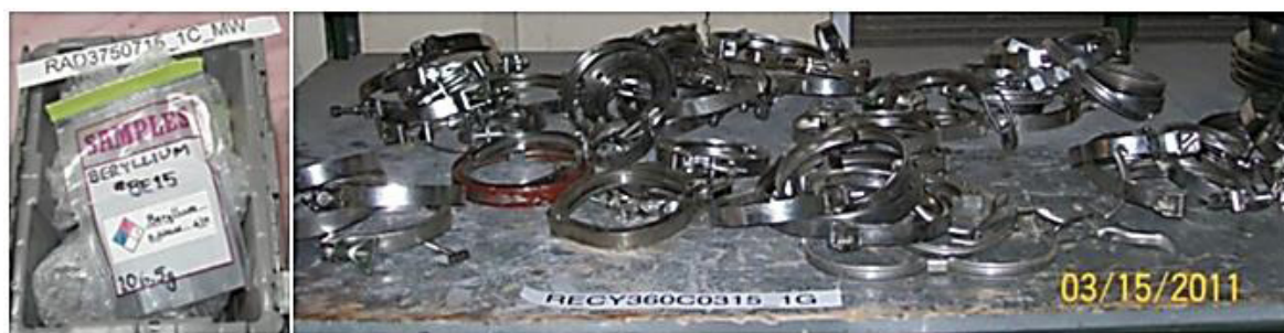
РИС. I-4. Все удаляемые предметы были сфотографированы и каталогизированы. Обратите внимание на использование на фотографии идентификационной маркировки с инвентарным номером, что позволило избежать необходимости проставлять номера или маркировку на множестве фотографий впоследствии (любезно предоставлено Аргоннской национальной лабораторией).
