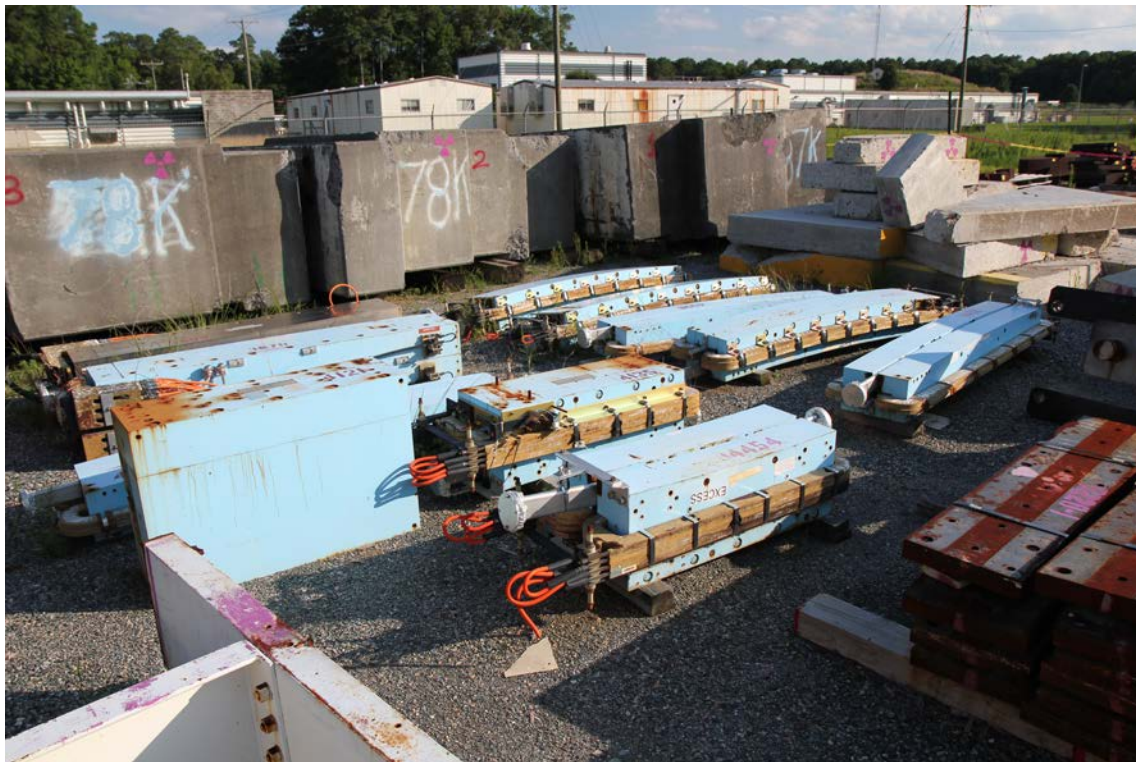
РИС. I–8. Неиспользованные излишние дипольные магниты на переднем плане, бетонные экранирующие блоки на заднем плане и фрагменты бетонной плиты перекрытия из экспериментального зала С справа на заднем плане (любезно предоставлено компанией Jefferson Science Associates, LLC).
