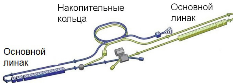
РИС. 14. Схематическое изображение Международного линейного коллайдера без соблюдения масштаба (любезно предоставлено проектом «Международный линейный коллайдер»).
