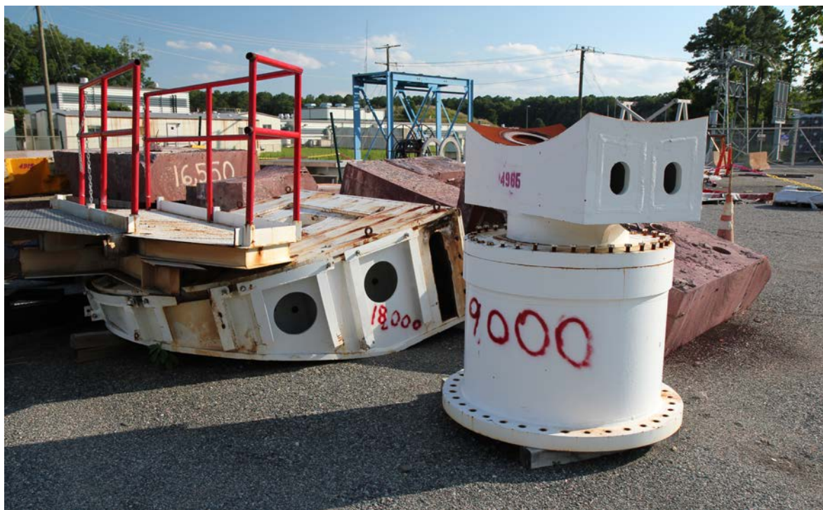
РИС. I-7. Поворотный механизм из экспериментального зала С с маркировкой веса в фунтах (любезно предоставлено компанией Jefferson Science Associates, LLC).
