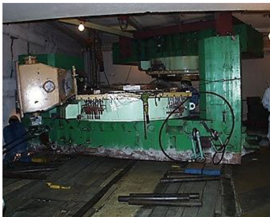
РИС. I-27. Разделение нижней части ярма (воспроизведено из [I-18] с любезного разрешения К. Масумото).
