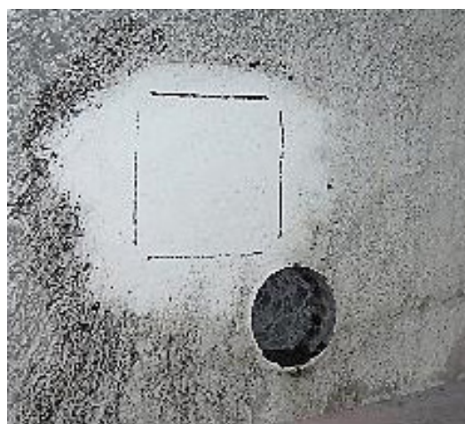
РИС. I-16. Отбор проб/образцов из точки максимальной измеренной скорости счета (воспроизведено из [I-14] с любезного разрешения К. Пешеля).
