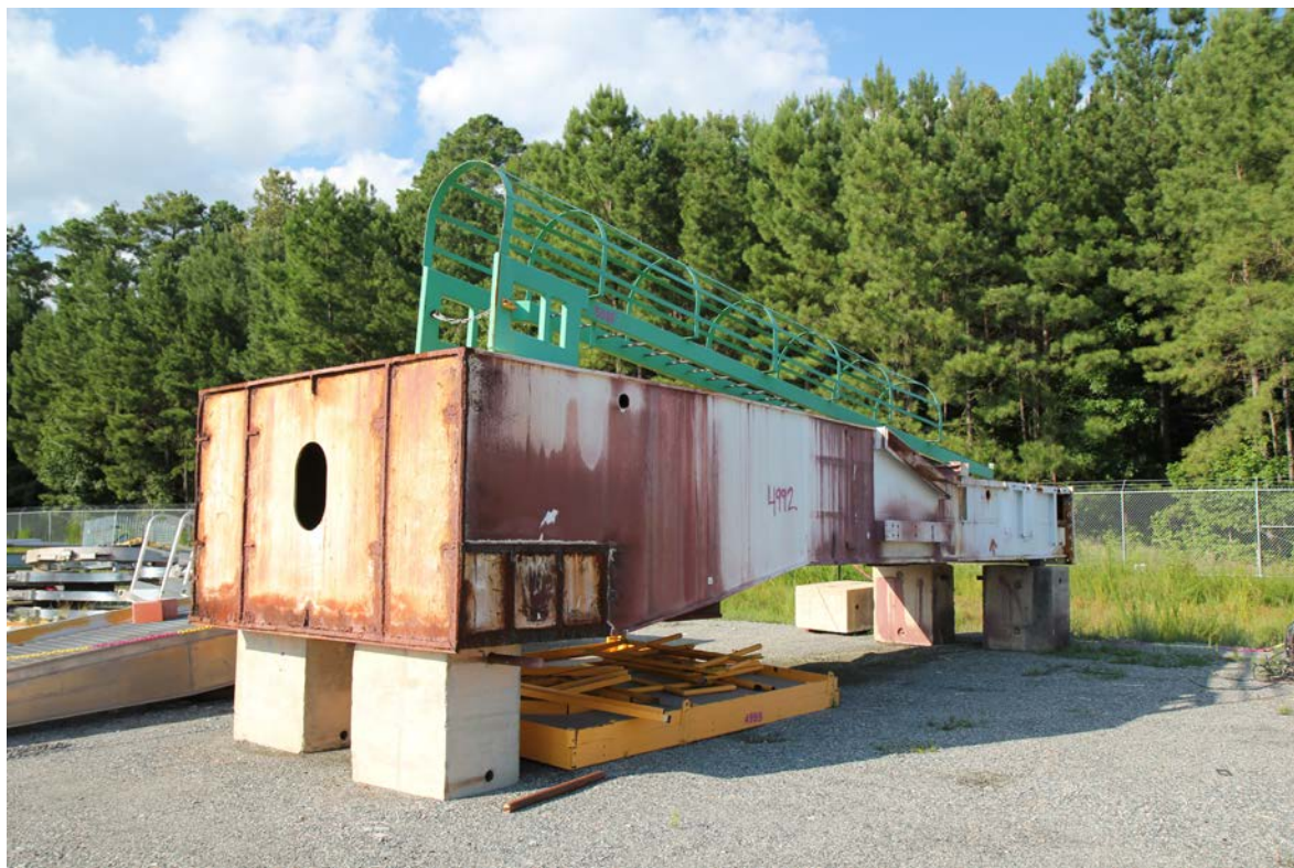
РИС. I-6. Каркас короткоорбитального спектрометра из экспериментального зала С с маркировкой веса в фунтах (любезно предоставлено компанией Jefferson Science Associates, LLC).
