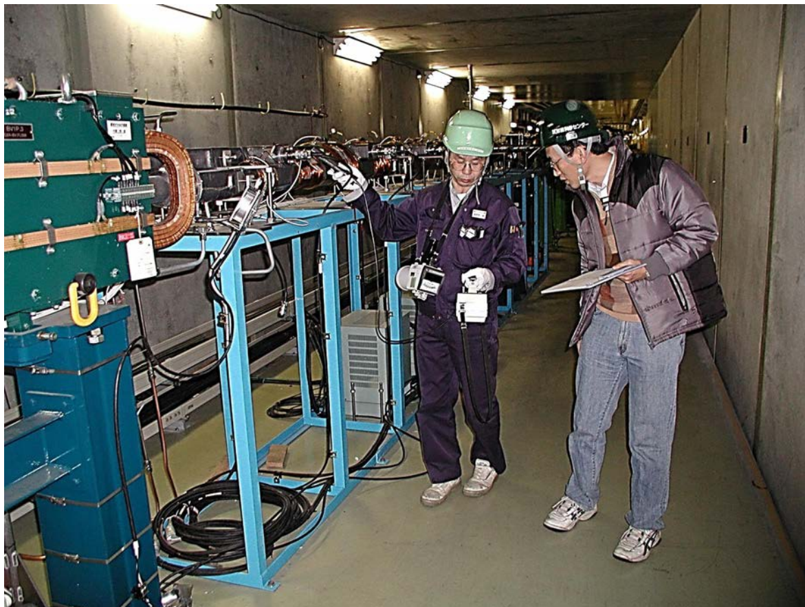
РИС. I–34. Измерения мощности дозы (воспроизведено из [I–18] с любезного разрешения К. Масумото).
