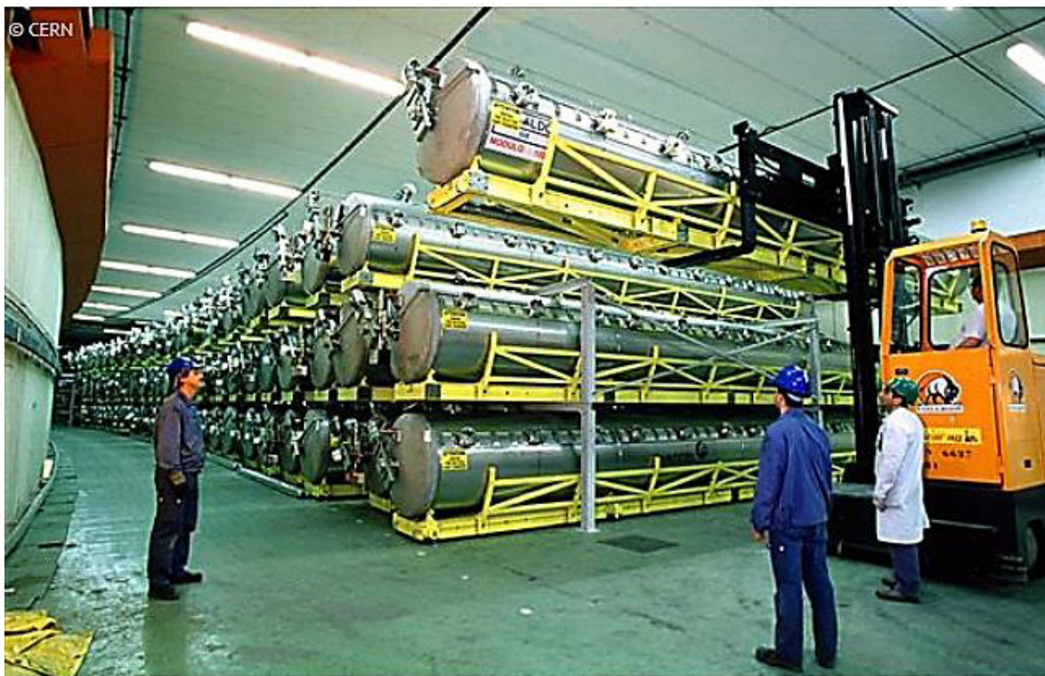
РИС. I-10. Семьдесят два сверхпроводящих резонатора ускорителя на хранении после демонтажа. Длина каждого модуля около 12 м (любезно предоставлено ЦЕРН).
