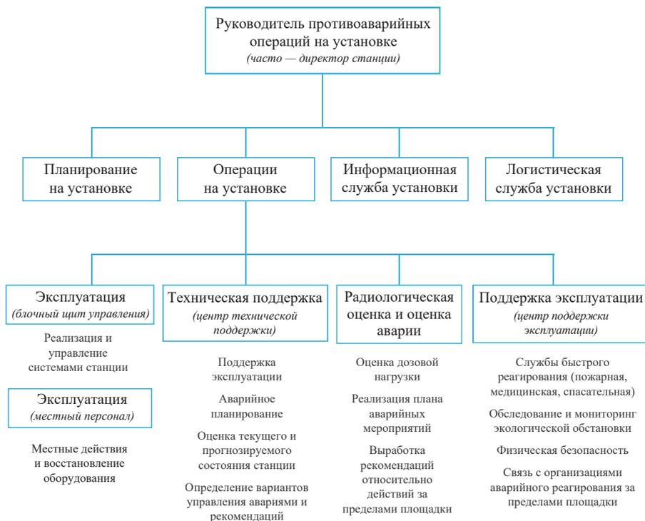
РИС. 2. Пример организационной структуры организации аварийного реагирования на площадке.
