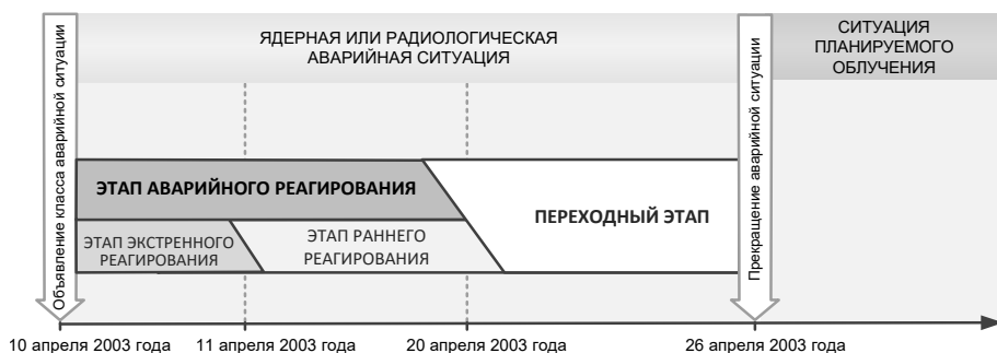
РИС. I–12. Ретроспективная последовательность событий и этапы инцидента с повреждением топлива на АЭС «Пакш».
