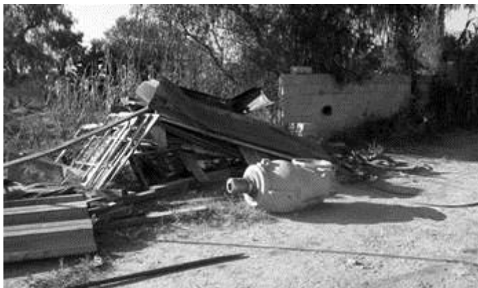
РИС. I–14. Пустой защитный кожух радиоактивного источника (предоставлено НКЯБГ).
