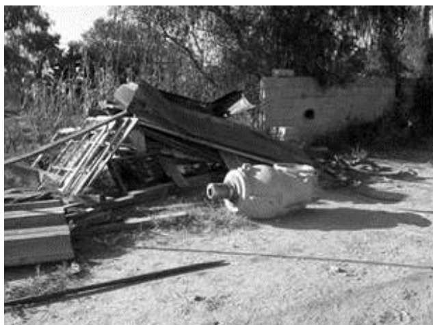
FIG. I-14. Le blindage vide de la source radioactive (avec l'aimable autorisation de la CNSNS).
