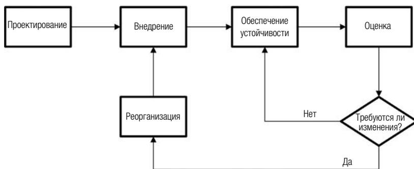
РИС. 3. Жизненный цикл системы физической защиты.
