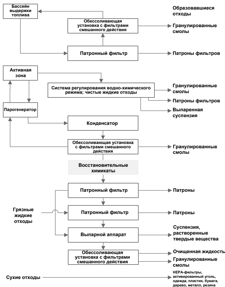
РИС. III-1. Пример карты технологического процесса обращения с радиоактивными отходами на реакторе с водой под давлением (полнопоточная доочистка конденсата). Рисунок взят из публикации NUREG/CR1759 1 .
