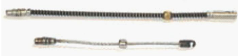
Fig. 20. Típicos ensamblajes antiguos de cola/fuente de gammagrafía.
