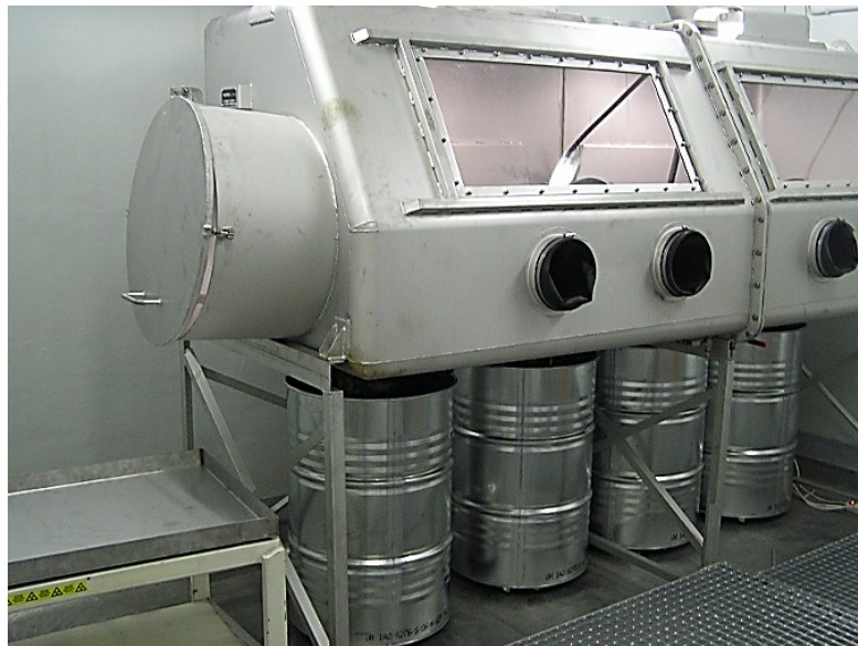
Fig. 51. Manipulación de fuentes selladas de actividad baja en una caja de guantes.
