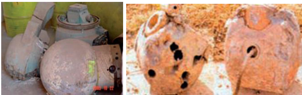
Fig. 15. Cabezales de teleterapia viejos y dañados.
