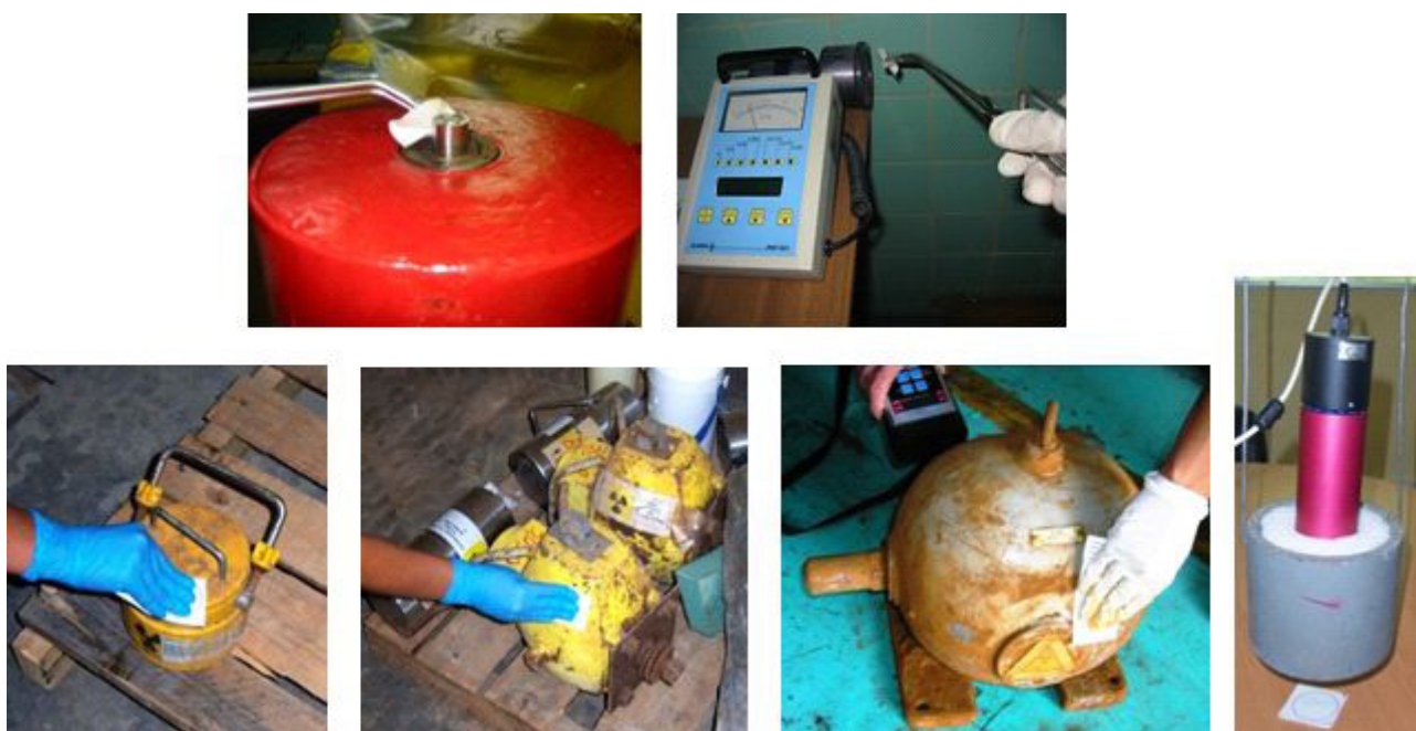
Fig. 45. Ensayo de frote para el control de la contaminación.
