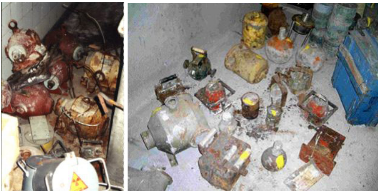
Fig. 73. Almacenamiento inadecuado de fuentes DSRS.
