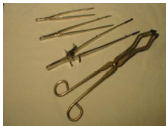
Fig. 48. Instrumentos de corto alcance para la manipulación manual de fuentes.
