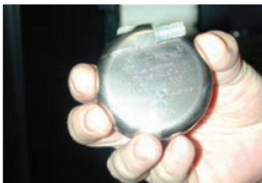
Fig. 6. Marcapasos alimentado por un generador termoelectrico de radioisotopos.
