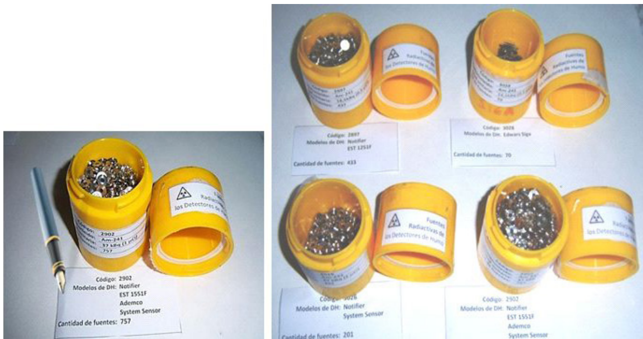
Fig. 87. Centenares de fuentes retiradas de detectores de humo.
