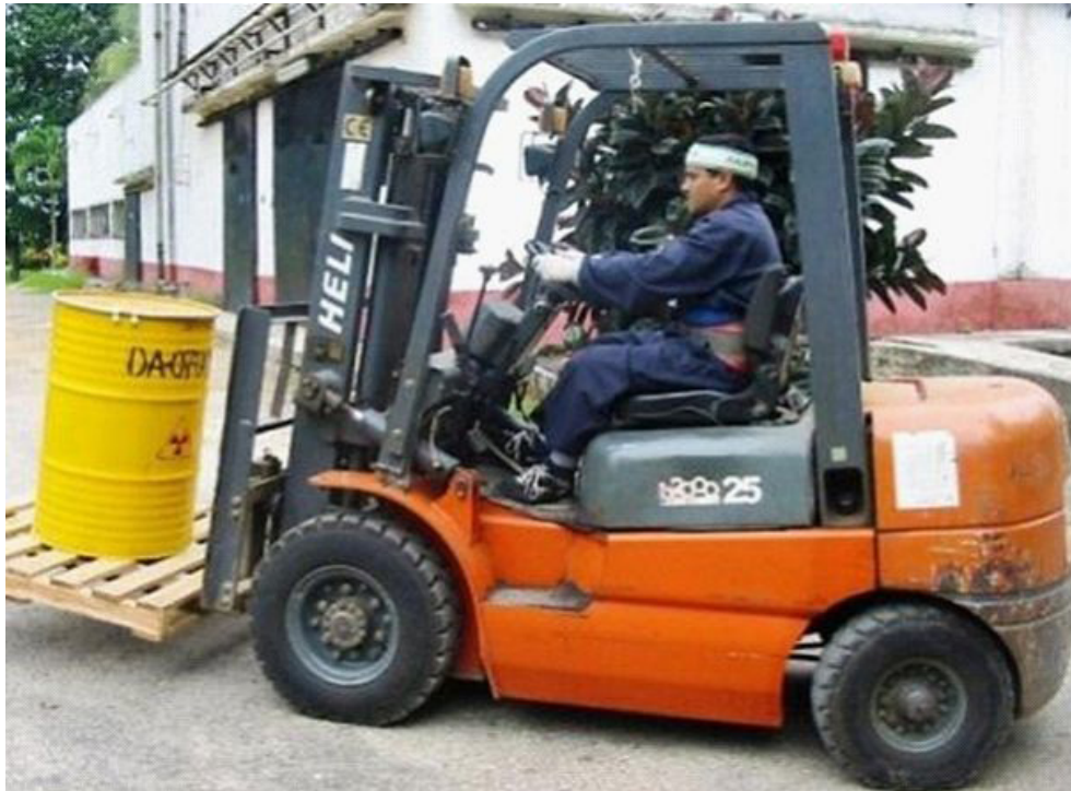
Fig. 57. Manipulación de un bidón de desechos de 200 l con carretilla de horquilla elevadora.
