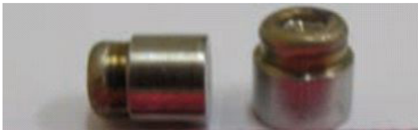
Fig. 22. Cápsula interior de una fuente de gammagrafía típica antes de ser encapsulada en la cola.
