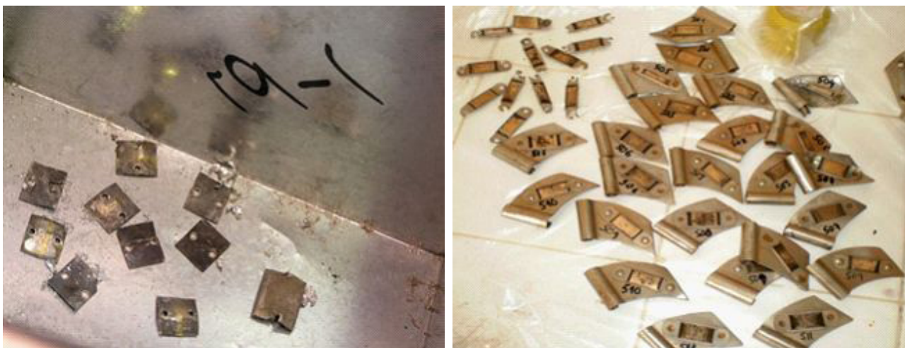
Fig. 88. Placas de ^{226}\text{Ra} y ^{241}\text{Am} retiradas de pararrayos.
