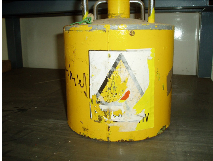
Fig. 71. Deterioro de la etiqueta del contenedor de una fuente.
