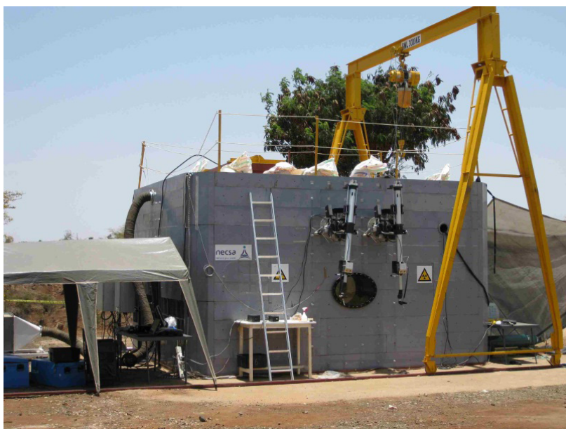
Fig. 92. La instalación de celda caliente móvil del OIEA, completamente montada y lista para su uso.
