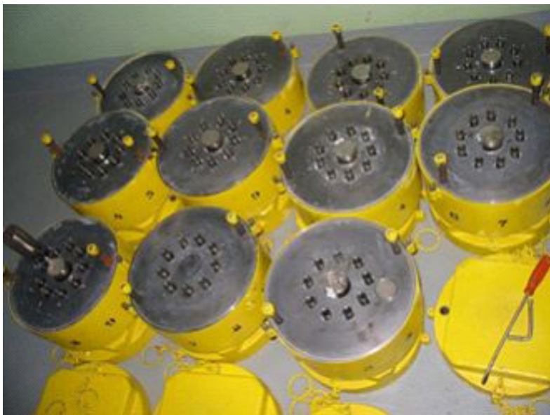
Fig. 85. Escudos de plomo para el almacenamiento a largo plazo.
