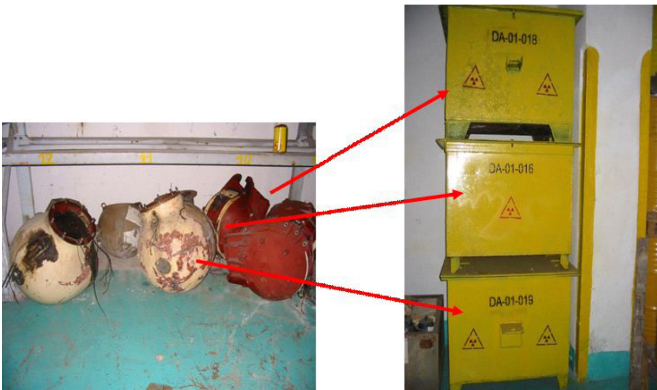
Fig. 91. Unidades de teleterapia antes y después de ser acondicionadas en el interior de cajas metálicas.
