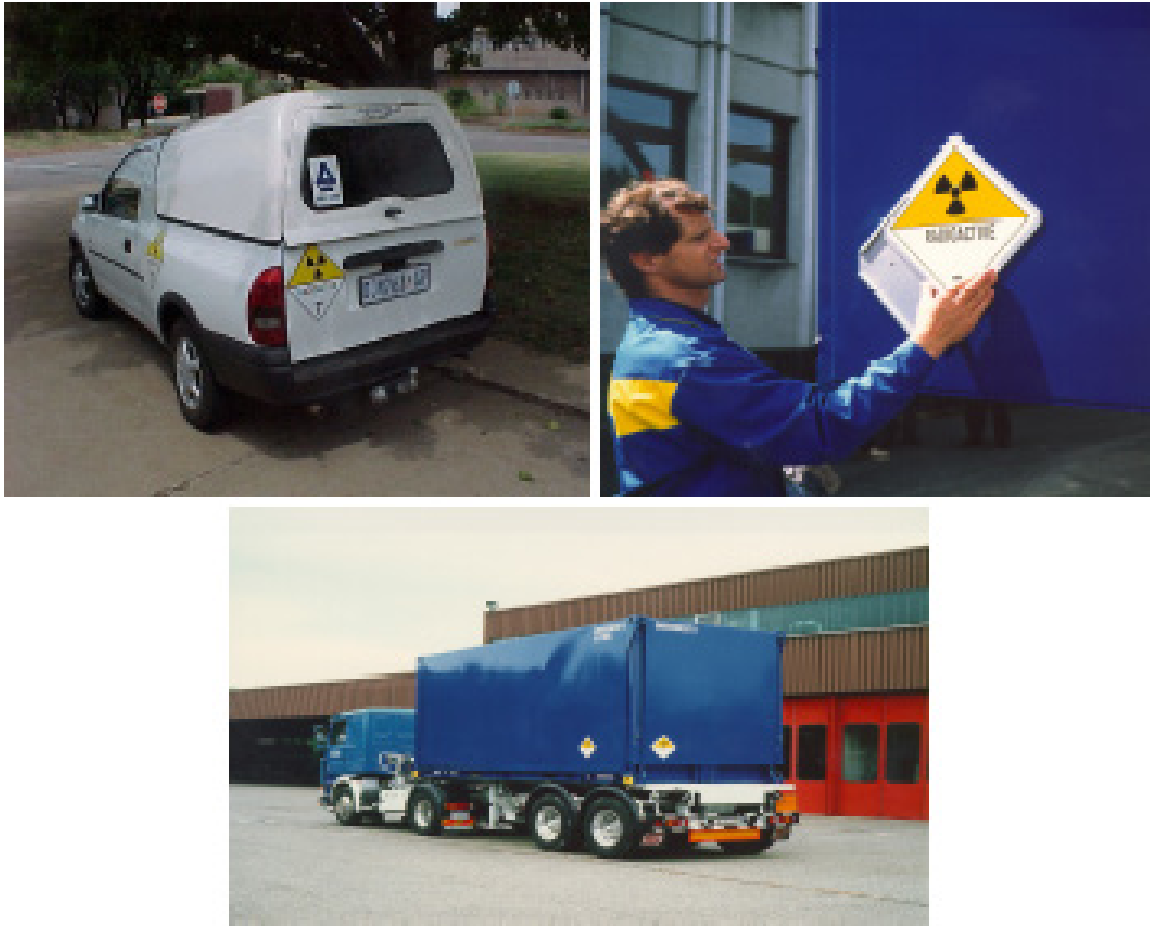
Fig. 95. Rotulación de vehículos utilizados para transportar fuentes radiactivas selladas.
