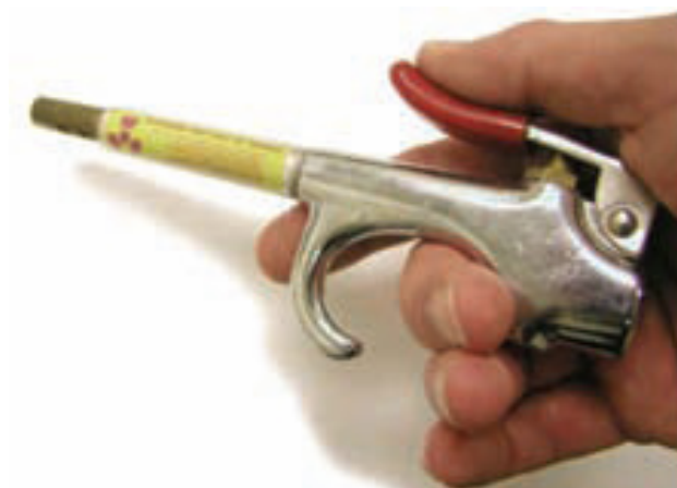
Fig. 38. Pistola de aire típica de eliminador de electricidad estática.
