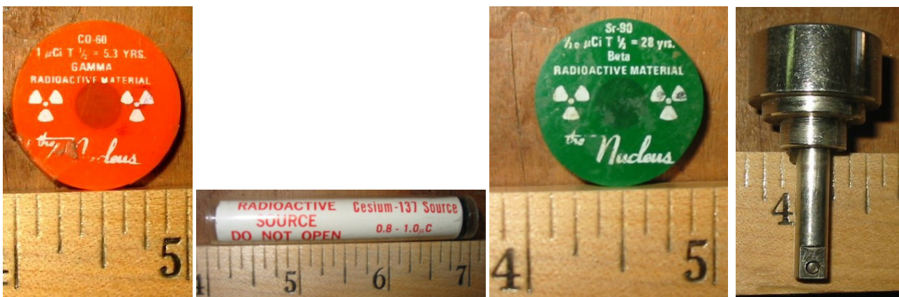
Fig. 25. Ejemplos de fuentes de calibración de actividad baja de ^{60}\text{Co} , ^{137}\text{Cs} , ^{90}\text{Sr} y ^{226}\text{Ra} .
