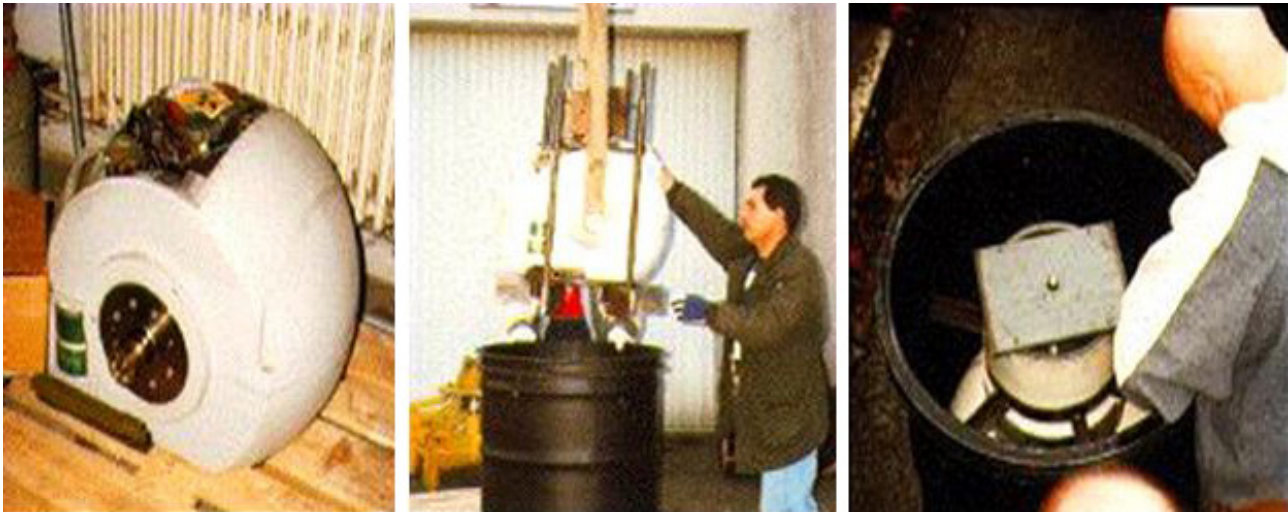
Fig. 90. Cabezal de teleterapia antes de ser acondicionado en el interior de un bidón metálico.
