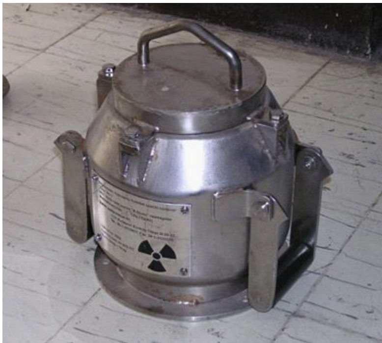
Fig. 54. Contenedor para fuentes selladas beta-gamma.
