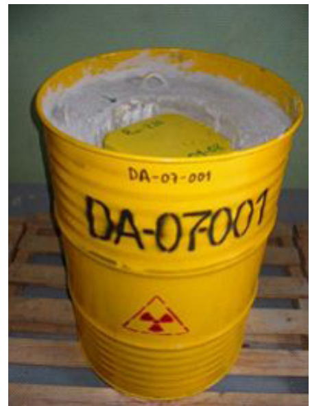
Fig. 86. Bulto de radio antes de ser cerrado.
