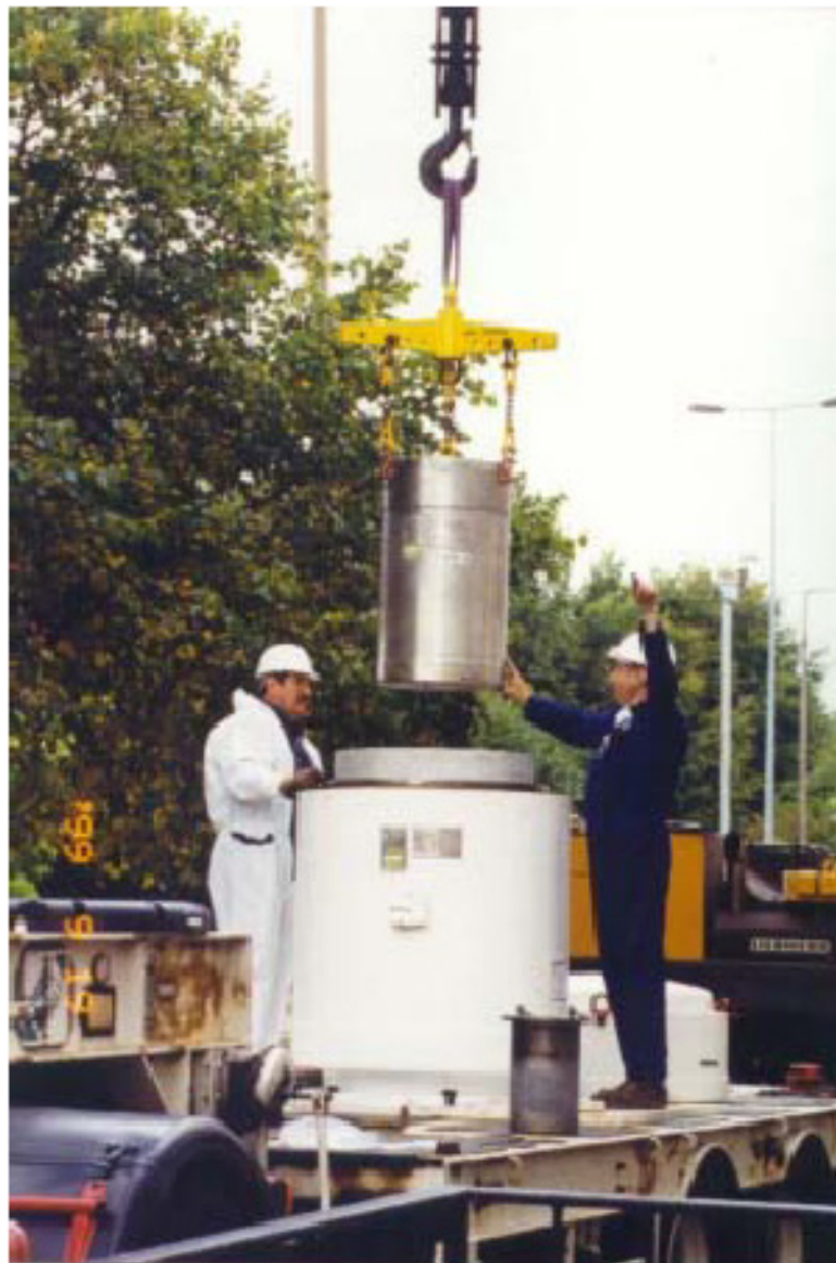
Fig. 104. Carga de un contenedor interior blindado de ^{137}\text{Cs} en un bulto del Tipo B después de haber retirado las fuentes de ^{137}\text{Cs} de un irradiador de investigación.
