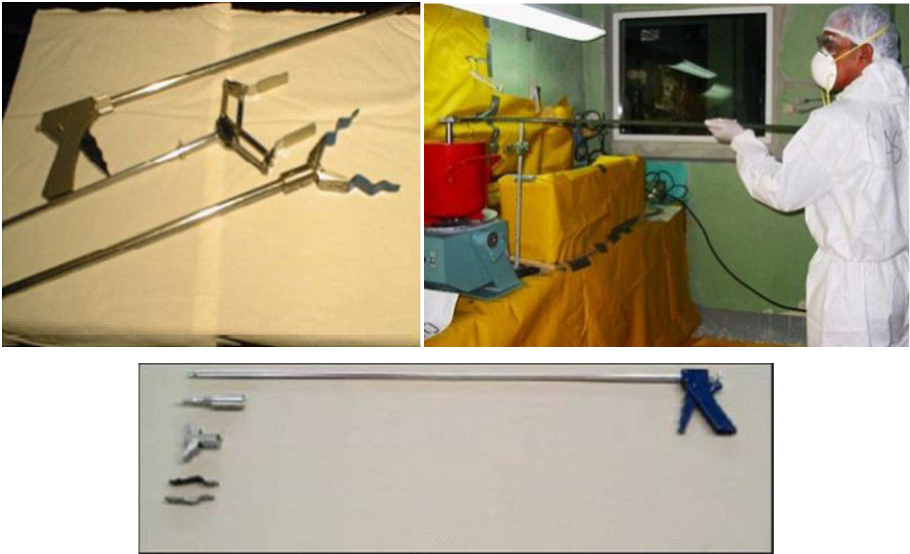
Fig. 49. Pinzas largas y su empleo en manipulación de fuentes.
