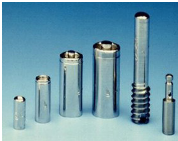
Fig. 34. Ejemplos de fuentes de Cs extraídas de los calibradores.
