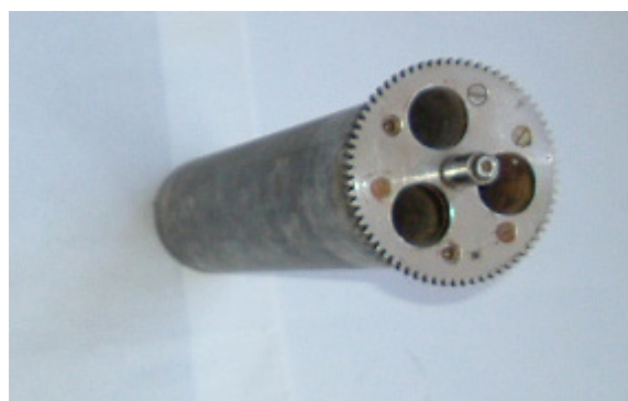
Fig. 81. Pieza rotatoria interna de un contenedor de carga y descarga del tipo B(U).
