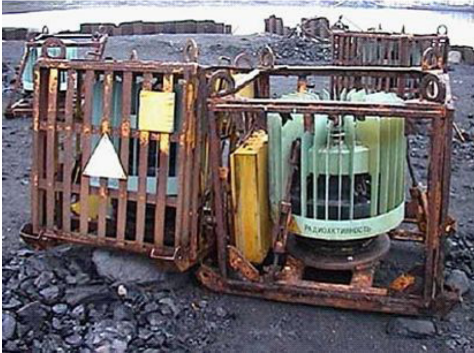
Fig. 74. Inadecuado almacenamiento abierto de generadores termoeléctricos de radioisótopos.
