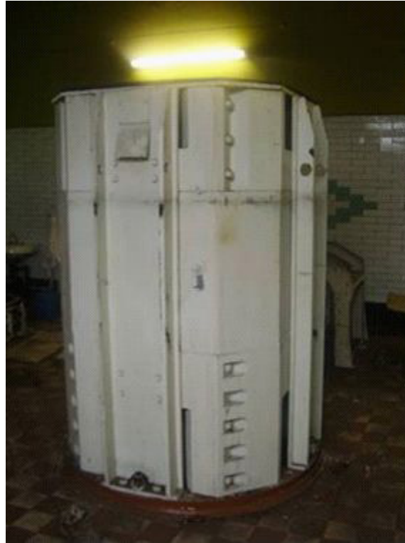
Fig. 106. Irradiador cargado con fuentes DSRS de ^{137}\text{Cs} listo para su transporte a la instalación de disposición final.
