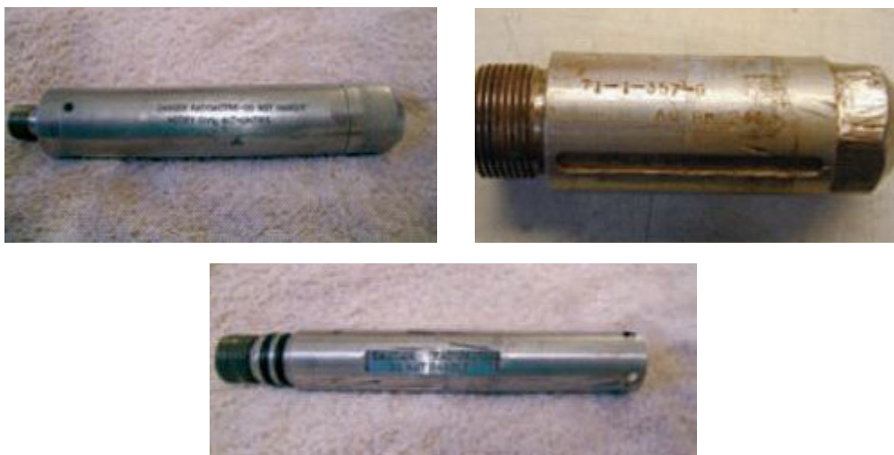
Fig. 30. Fuentes de neutrones de ^{241}\text{Am-Be} para diagrafía de pozos petrolíferos.
