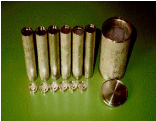
Fig. 83. Típicas cápsulas de acero inoxidable.
