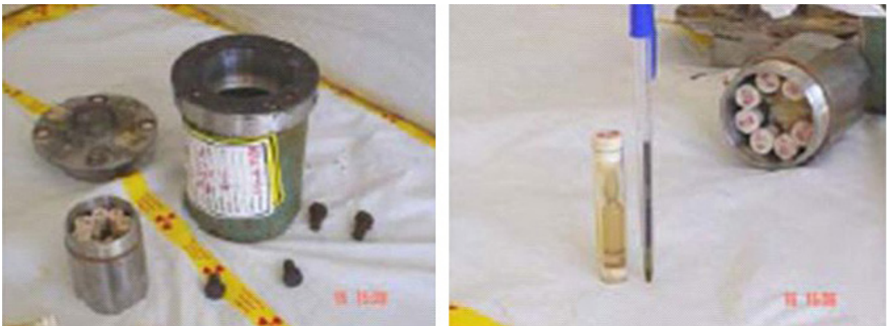
Fig. 4. Fuentes líquidas de ^{226}\text{Ra} en viales de vidrio.
