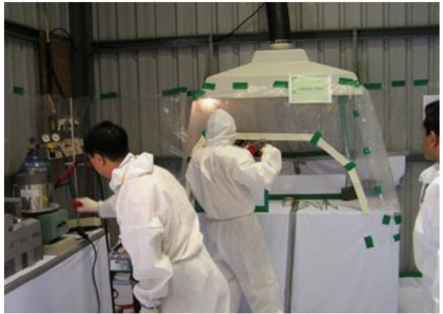
Fig. 84. Encapsulamiento de fuentes de radio.
