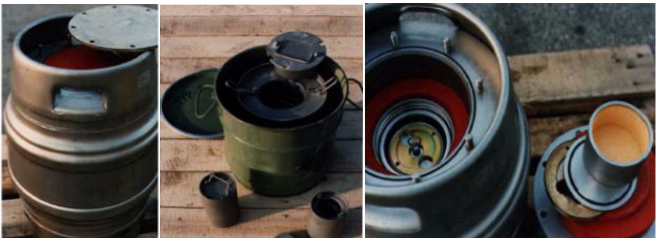
Fig. 98. Para fuentes pequeñas, según el tamaño, la geometría y la actividad de la fuente, debería utilizarse un contenedor especial para transporte.
