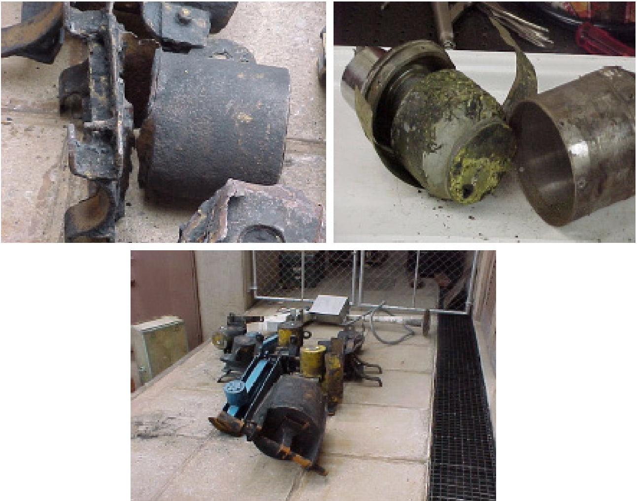
Fig. A-1. Equipo fuera de servicio que contiene fuentes en desuso.
