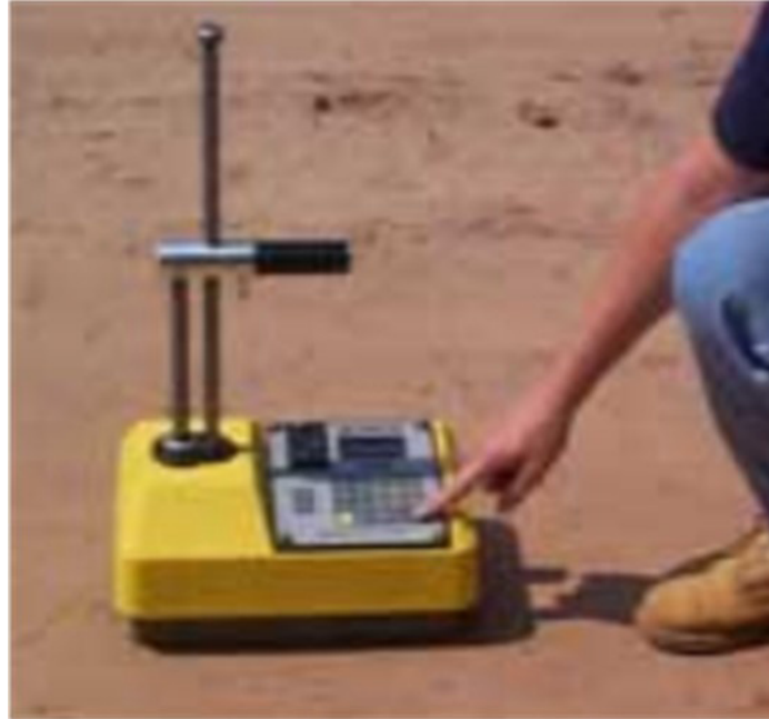
Fig. 36. Medidor portátil de ^{241}\text{Am}/\text{Be}^{137}\text{Cs} .
