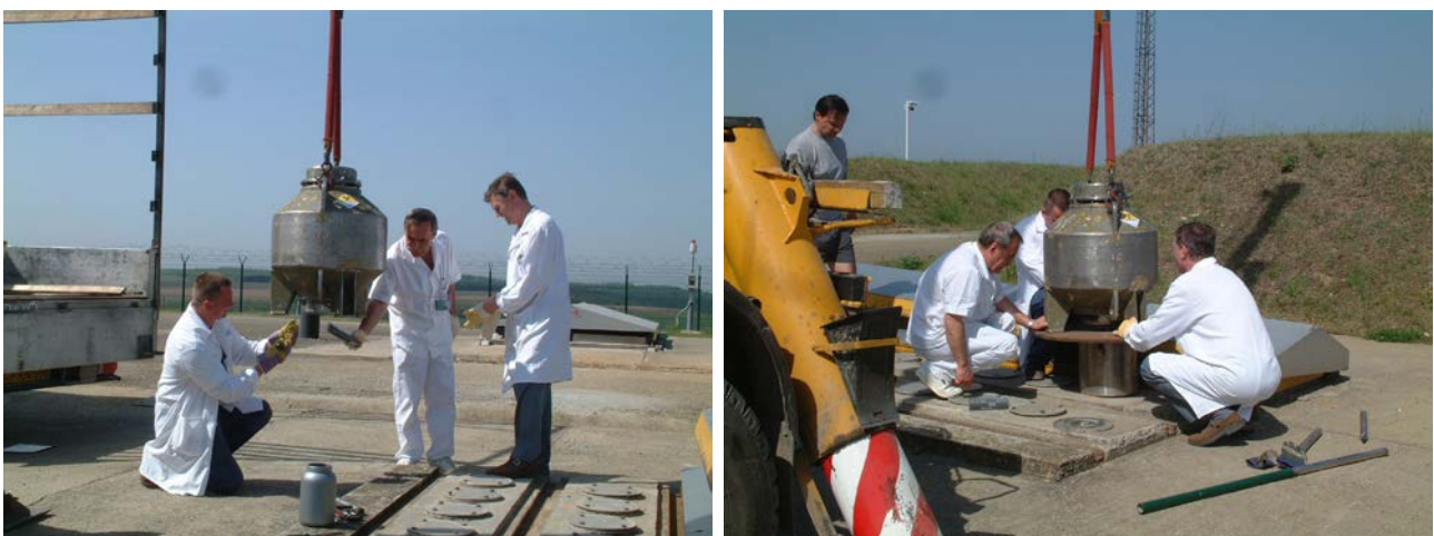
Fig. 75. Preparación y carga de fuentes DSRS de ^{60}\text{Co} en una unidad de almacenamiento tipo pozo.
