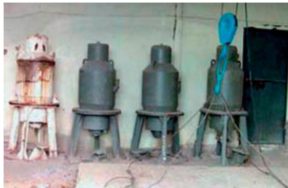
Fig. 13. Irradiadores móviles de cesio utilizados en la antigua Unión Soviética.
