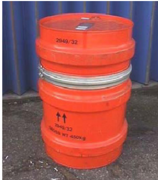
Fig. 99. Bulto de transporte del Tipo A con gran volumen interior y capacidad de carga (aproximadamente 300 kg).
