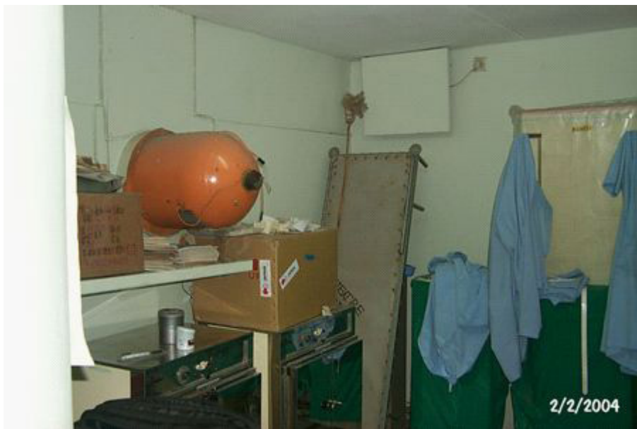
Fig. 68. El cajón que contiene una fuente de ^{60}\text{Co} no ha sido retirado de la máquina de teleterapia.
