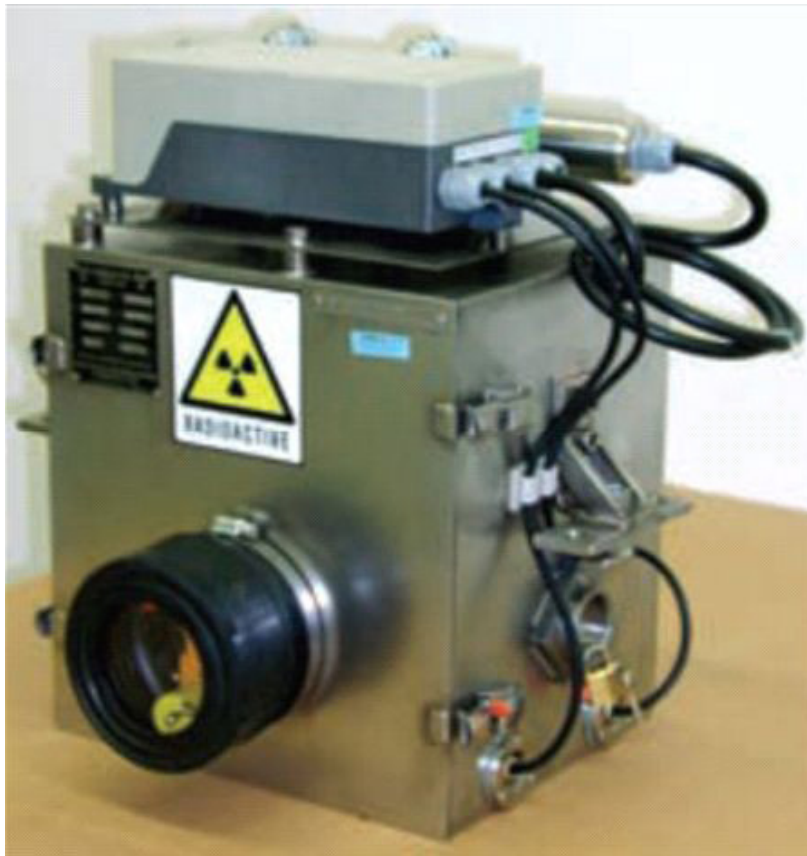
Fig. 35. Medidor de humedad de material a granel.
