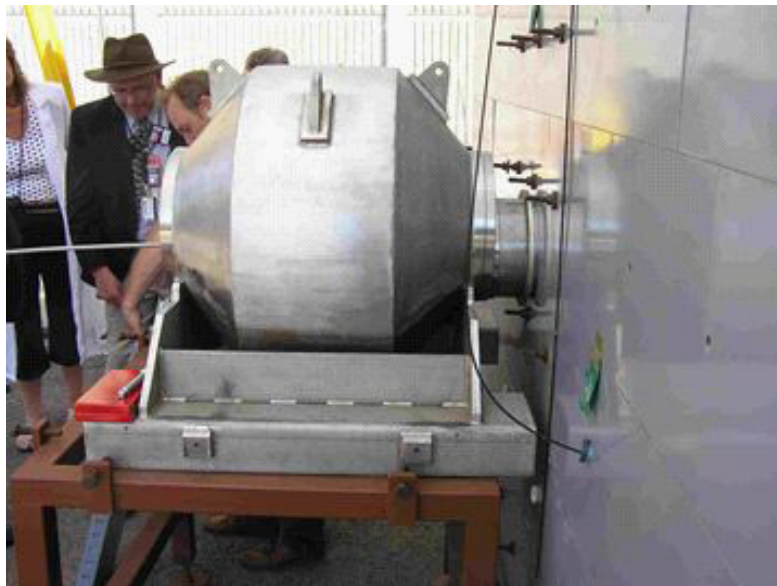
Fig. 94. Cofre blindado de almacenamiento a largo plazo completamente fijado a la escotilla de transferencia de la instalación de celda caliente móvil del OIEA.
