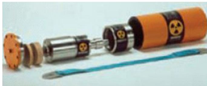
Fig. 29. Cabezal de fuente de equipo de gammagrafía "crawler" en contenedor de transporte.
