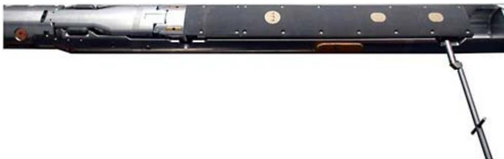
Fig. 31. Atlas Densilog, que utiliza una fuente vitrificada de ^{137}\text{Cs} para mediciones de densidad con cable guía. La varilla que se extiende hacia abajo es un dispositivo de manejo de la fuente. Los círculos de color claro son ventanas para la fuente y los detectores.
