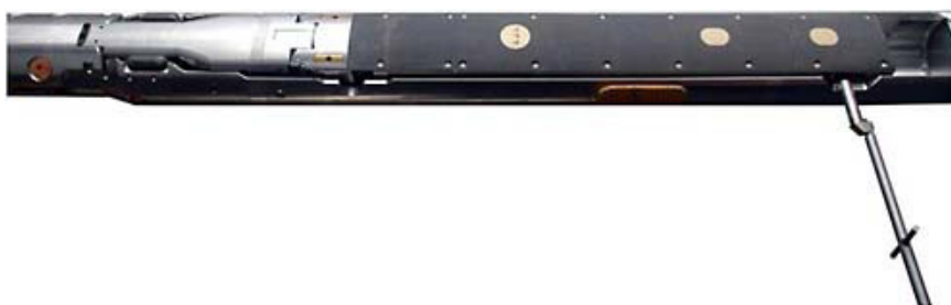
РИС. 31. Прибор Atlas Densilog, в котором для измерения плотности кабельным методом используется остеклованный источник ^{137}\text{Cs} . Выступающий снизу стержень — это устройство для работы с источником. Круги светлого цвета — это окошки для источника и детекторов.
