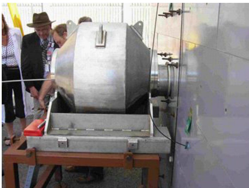
РИС. 94. Экранированный контейнер для длительного хранения, полностью присоединенный к люку для перемещения источников передвижной горячей камеры МАГАТЭ.
