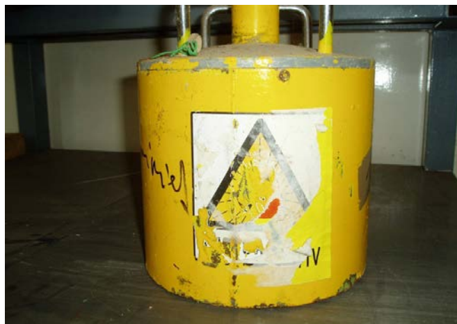
РИС. 71. Повреждение маркировки на контейнере с источником.
