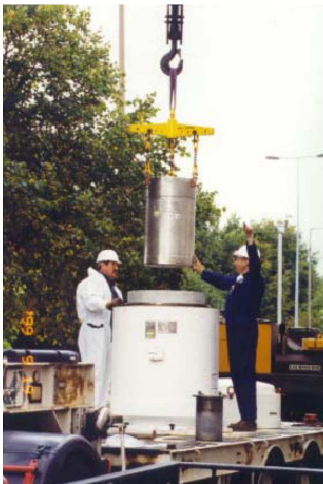
РИС. 104. Экранированный внутренний контейнер с ^{137}\text{Cs} загружается в транспортную упаковку типа В после того, как источник ^{137}\text{Cs} был извлечен из исследовательской облучательной установки.
