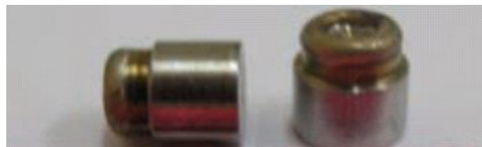
РИС. 22. Типичная внутренняя капсула с источником для гамма-радиографии до установки внутрь кабеля.
