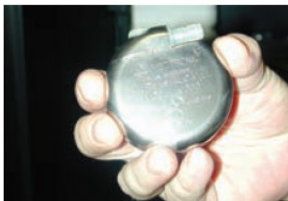
РИС. 6. Кардиостимулятор, работающий от РИТЭГ.
