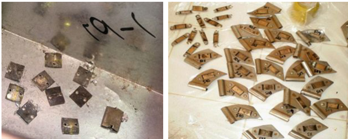
РИС. 88. Пластины ^{226}\text{Ra} и ^{241}\text{Am} , извлеченные из молниеотводов.
