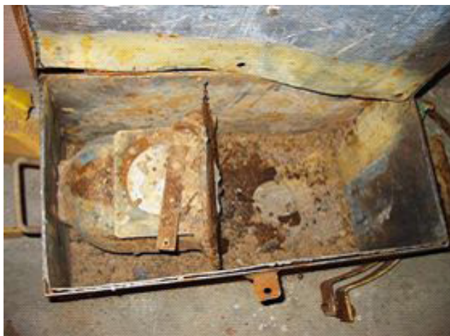
РИС. 70. Контейнеры, подвергшиеся коррозии.
