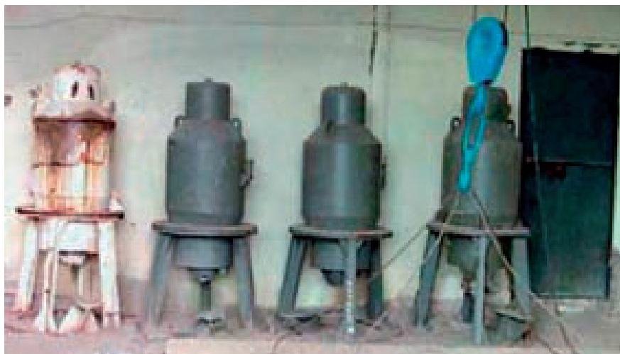
РИС. 13. Мобильные цезиевые облучатели, которые использовались в бывшем СССР.
