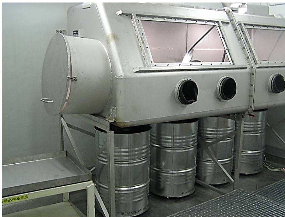
Рис. 51. Перчаточный бокс для манипулирования с низкоактивными источниками.
