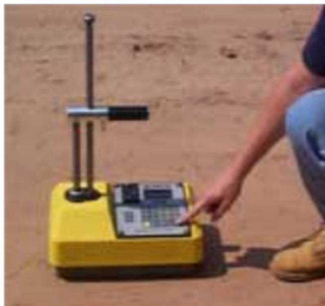
РИС. 36. Портативный измерительный прибор на основе ^{241}\text{Am}/\text{Be}^{137}\text{Cs} .
