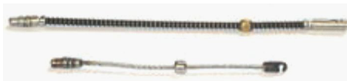
РИС. 20. Типичные старые источники для гамма-радиографии в комплекте с кабелем.
