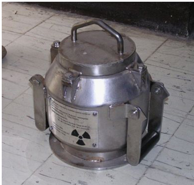
РИС. 54. Контейнер для закрытых источников бета-гамма-излучения.
