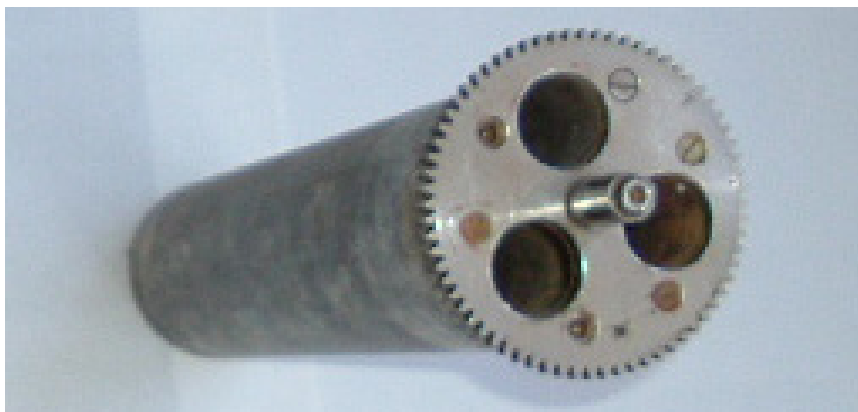
РИС. 81. Внутренняя вращающаяся часть погрузочно-разгрузочного контейнера типа В(У).
