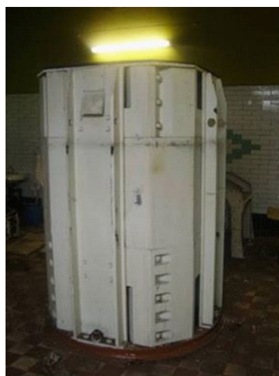
РИС. 106. Готовая к перевозке в пункт захоронения облучательная установка, в которую загружены ИЗРИ на основе ^{137}\text{Cs} .
