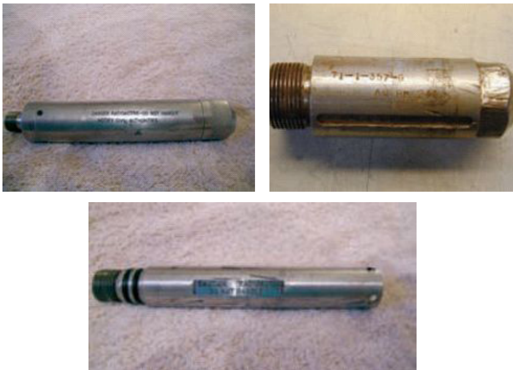
РИС. 30. Типичные источники нейтронов для каротажа нефтяных скважин на основе ^{241}\text{Am-Be} .
