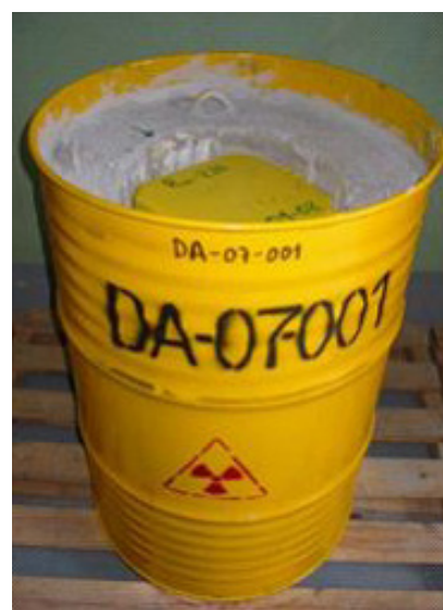
РИС. 86. Упаковка радиевого источника перед закрытием.
