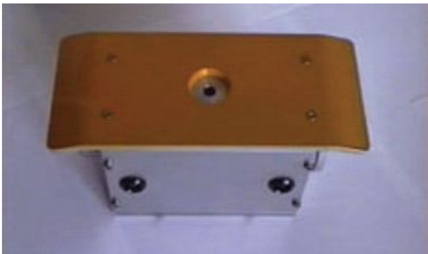
РИС. 32. Деталь держателя источника бета-излучения, используемого в измерительном приборе.
