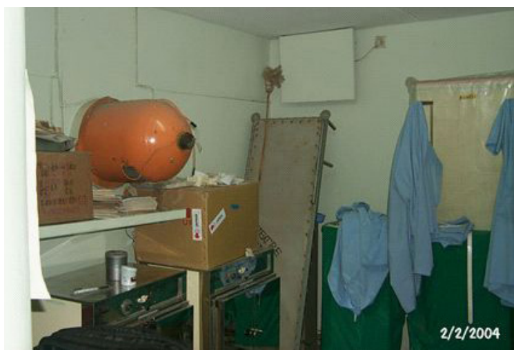
РИС. 68. Пенал с источником на основе ^{60}\text{Co} не был извлечен из аппарата дистанционной лучевой терапии.
