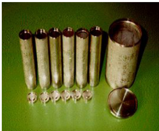
РИС. 83. Стандартные капсулы из нержавеющей стали.
