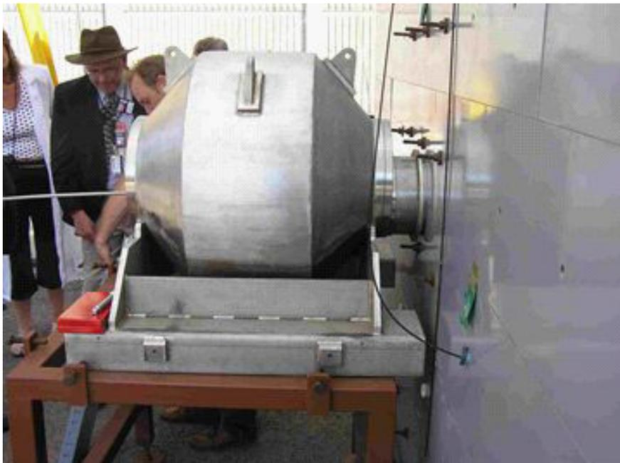
*FIG. 94. Enceinte d'entreposage à long terme entièrement fixée au port de transfert de l'installation de cellules chaudes mobiles de l'AIEA.*
