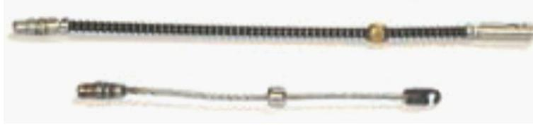
FIG. 20. Anciens assemblages de source/queue-de-cochon courants de gammagraphie.
