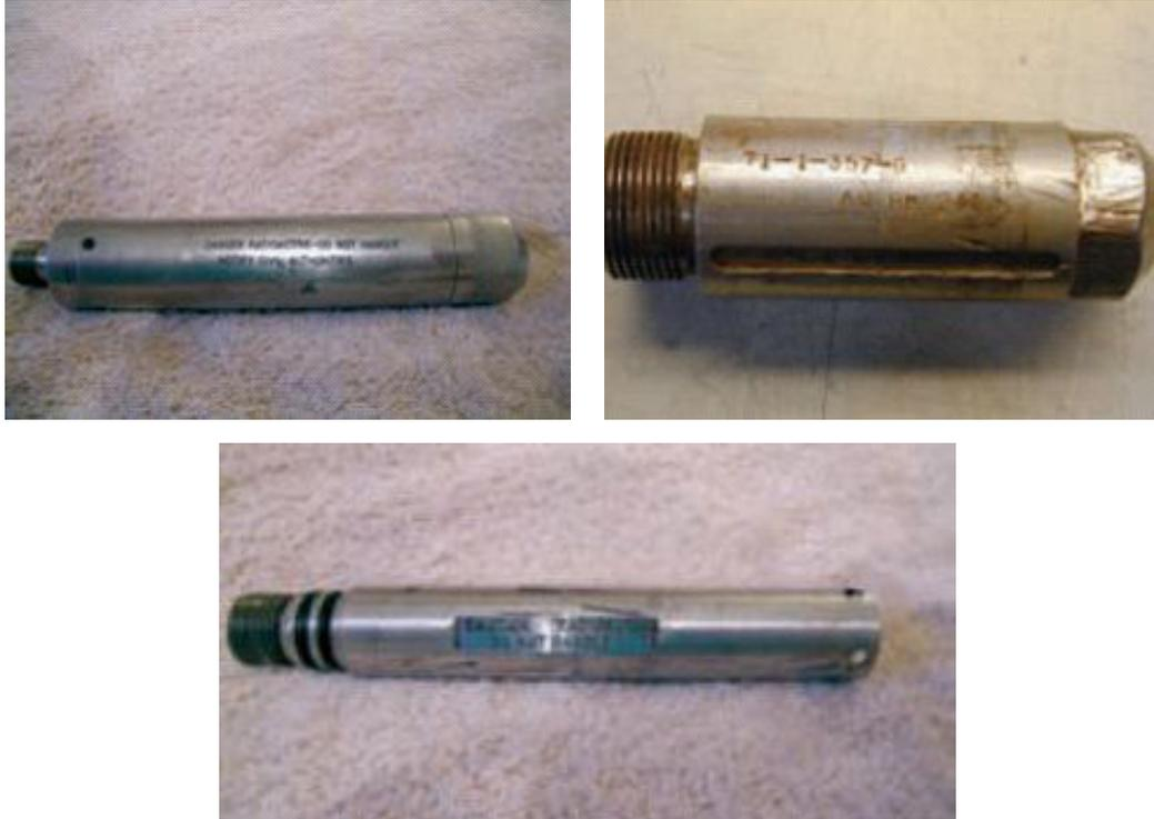
FIG. 30. Sources courantes de neutrons d' $^{241}\text{Am-Be}$  utilisées en diagraphe pétrolière.
