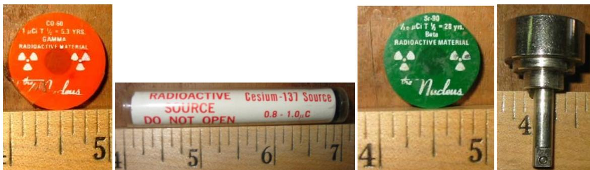
FIG. 25. Exemples de sources d'étalonnage de faible activité au  $^{60}\text{Co}$ , au  $^{137}\text{Cs}$ , au  $^{90}\text{Sr}$  et au  $^{226}\text{Ra}$ .
