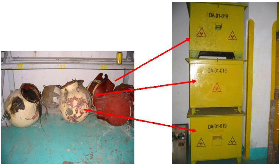
FIG. 91. Dispositifs de téléthérapie avant et après leur conditionnement dans des boîtes métalliques.
