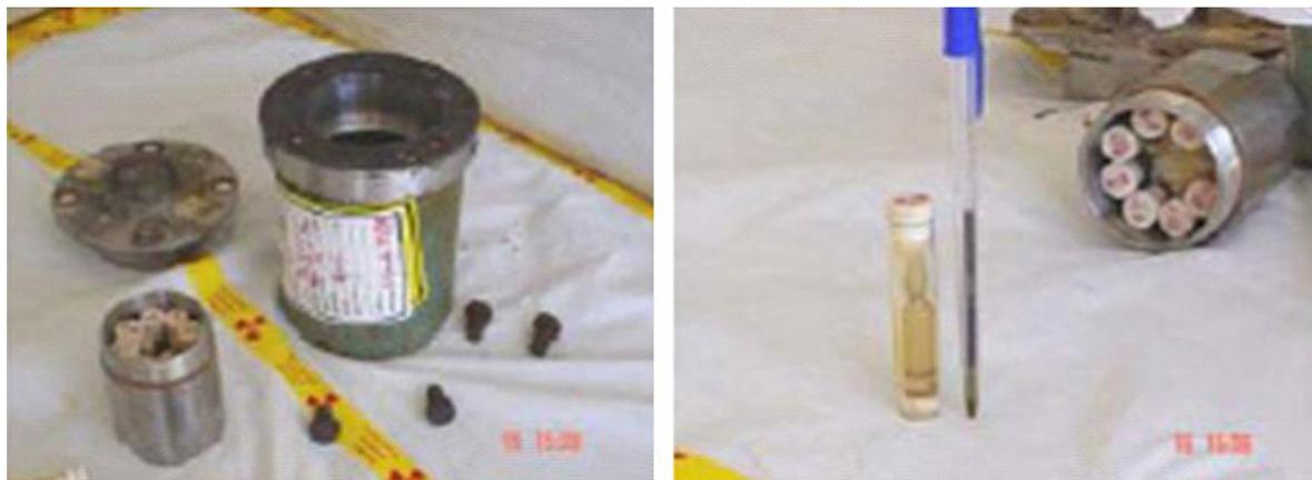
FIG. 4. Sources liquides au  $^{226}\text{Ra}$  dans des flacons de verre.
