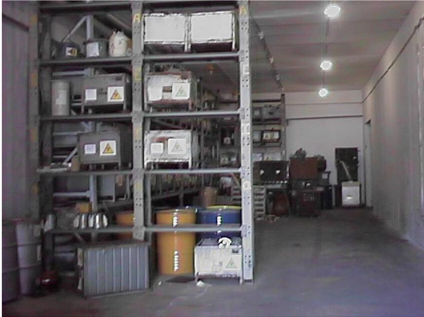
FIG. 63. Entreposage de sources radioactives scellées retirées du service sur des étagères.
