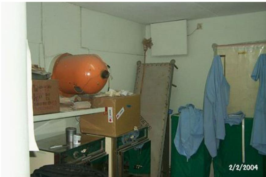
FIG. 68. Le tiroir contenant une source au  $^{60}\text{Co}$  n'a pas été retiré de ce dispositif de téléthérapie.
