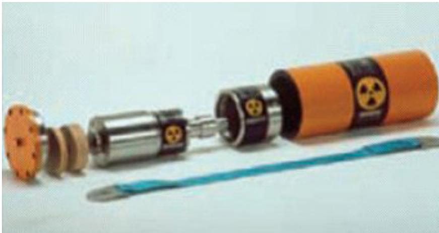
FIG. 29. Tête d'une source de chenille de canalisation dans un conteneur d'expédition.
