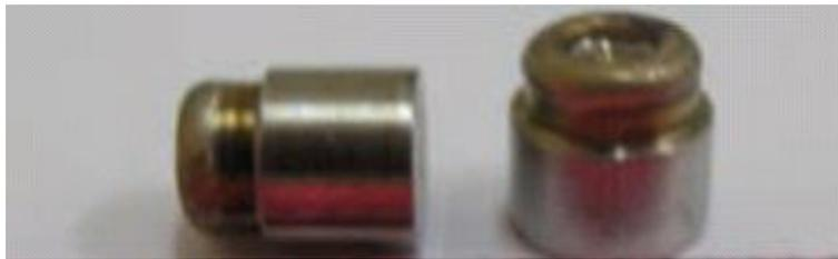
FIG. 22. Capsule interne courante de source de gammagraphie avant encapsulation dans la queue-de-cochon.
