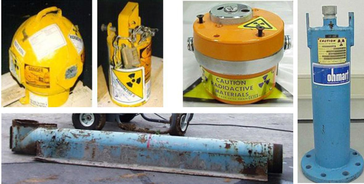
FIG. 27. Exemples de différents types de jauges.
