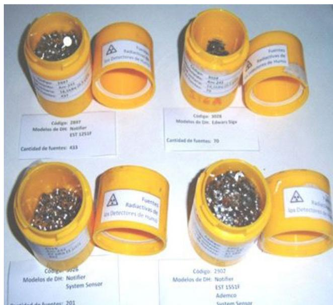
FIG. 87. Centaines de sources retirées de détecteurs de fumée.
