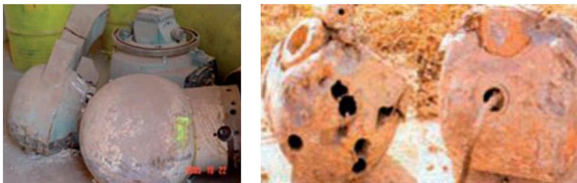
FIG. 15. Anciennes têtes de téléthérapie et têtes de téléthérapie endommagées.
