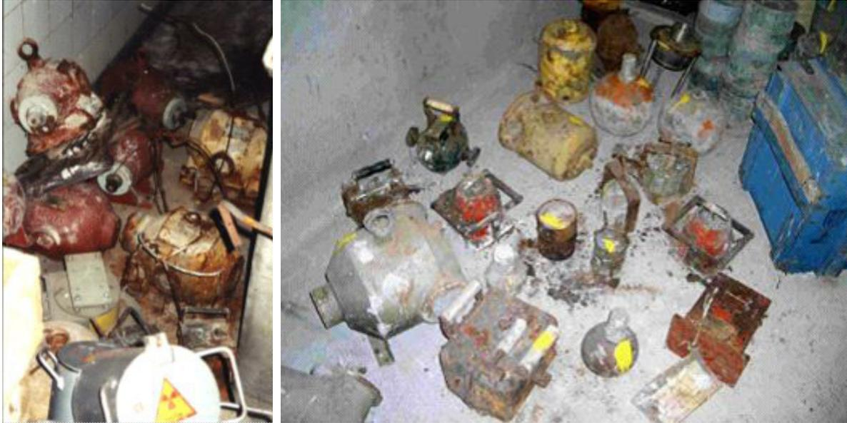
FIG. 73. Entreposage inadéquat de sources radioactives scellées retirées du service.
