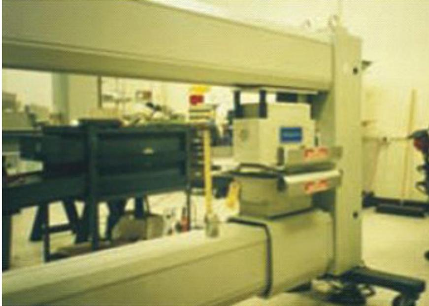
FIG. 33. Jauge bêta sur une unité de traitement en ligne.
