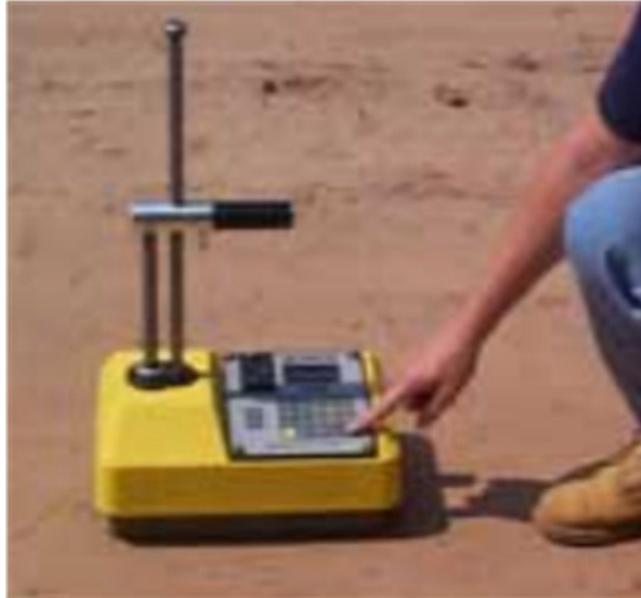
FIG. 36. Jauge portable à l' $^{241}\text{Am}/\text{Be}^{137}\text{Cs}$ .
