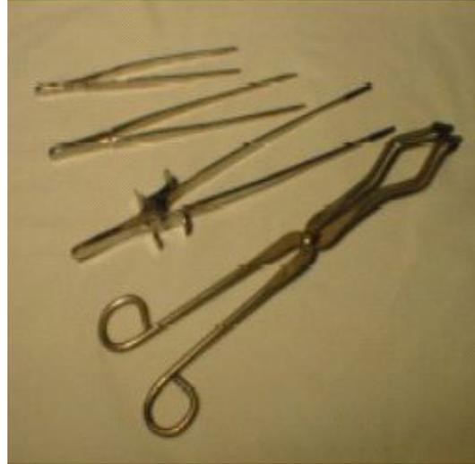
FIG. 48. Outils de courte taille pour la manutention manuelle des sources.
