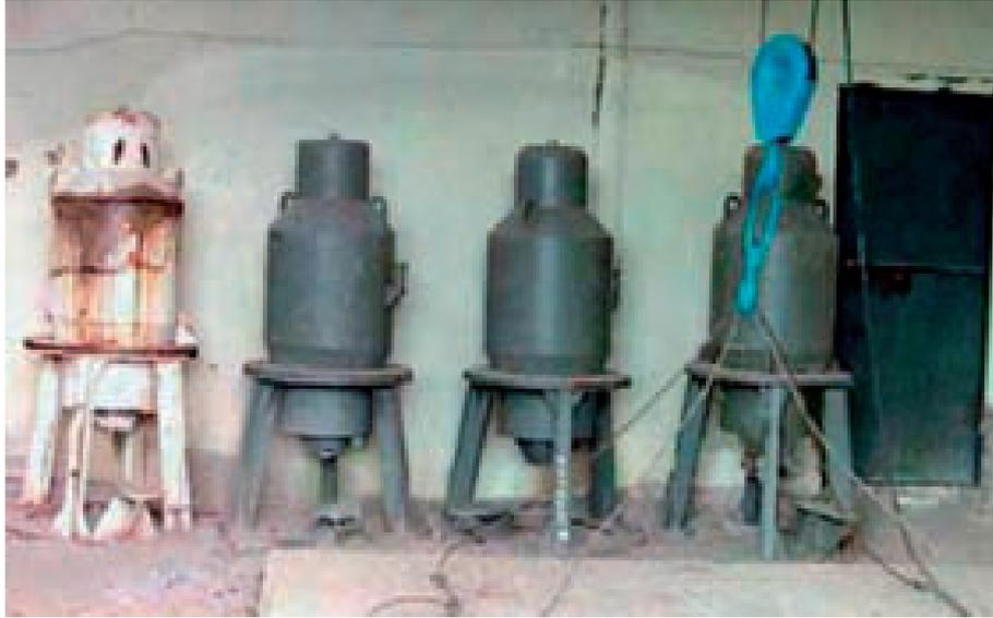
FIG. 13. Irradiateur portatif au césium utilisé en ex-URSS.
