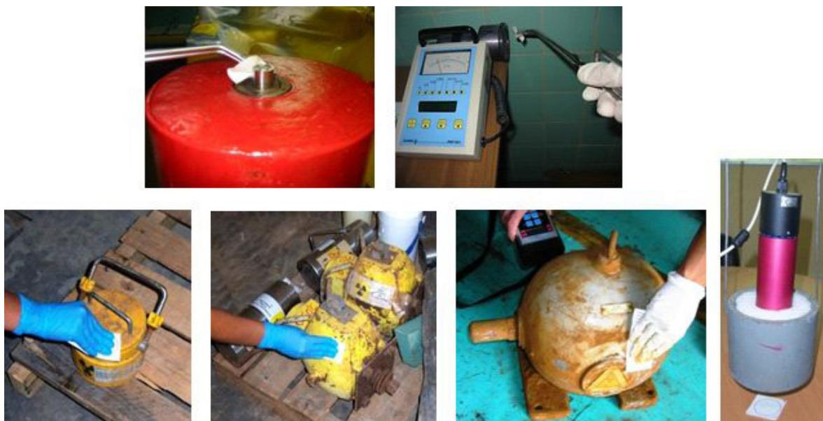
FIG. 45. Tests de frottis pour le contrôle de la contamination.
