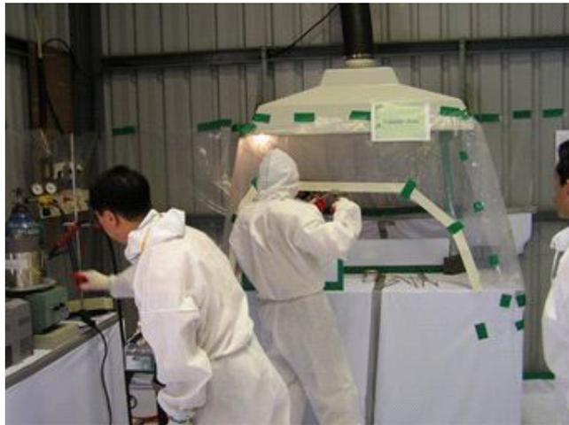
FIG. 84. Encapsulation de sources au radium.
