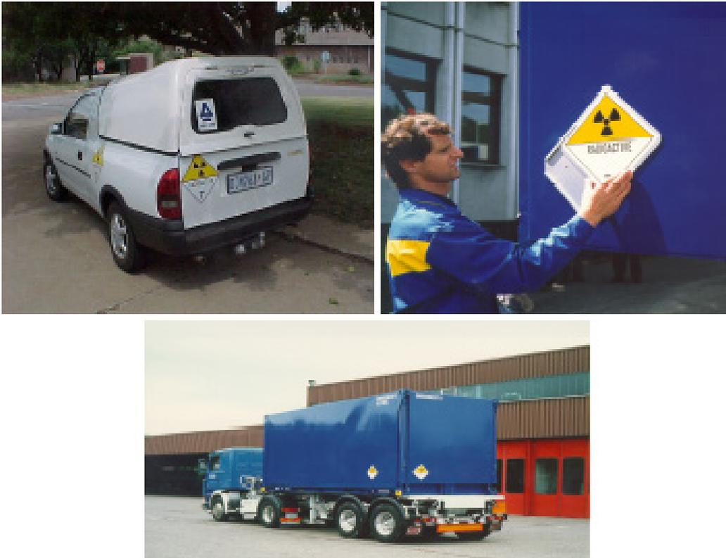
FIG. 95. Placardage des véhicules utilisés pour le transport des sources radioactives scellées.
