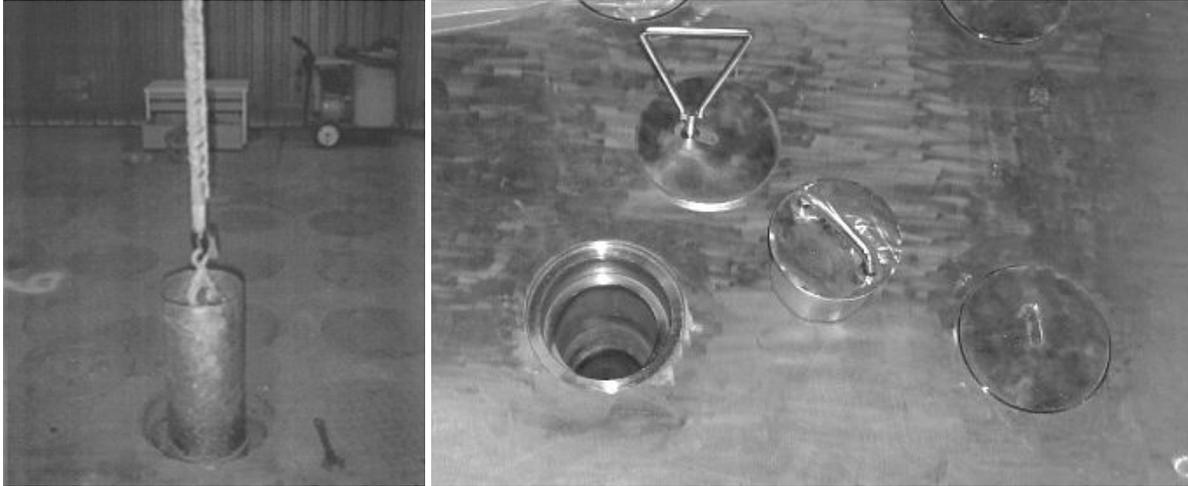
FIG. 76. Entreposage de sources scellées dans des tubes.
