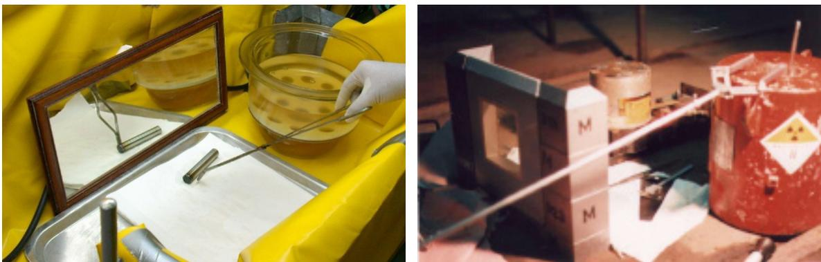
FIG. 52. Déplacement d'une source scellée à l'aide de tenailles à long manche.
