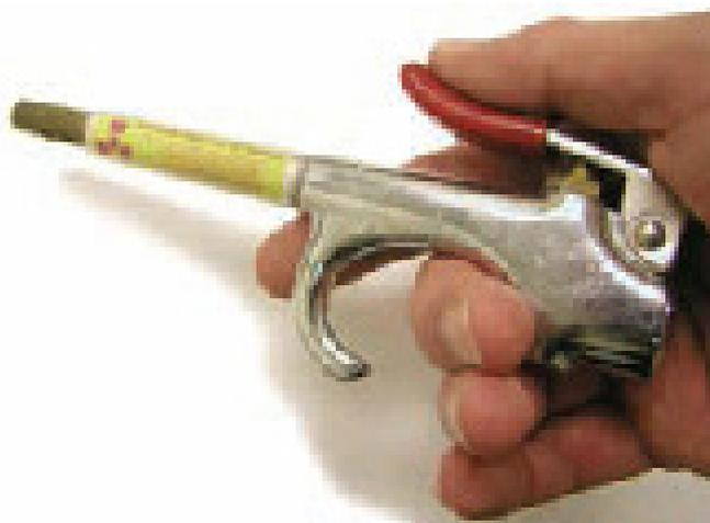
FIG. 38. Pistolet à air courant pour l'élimination de l'électricité statique.
