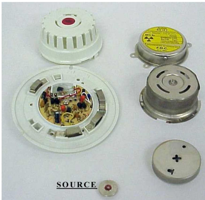
FIG. 39. Détecteur de fumée démonté.
