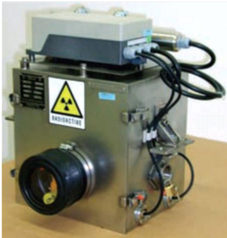
*FIG. 35. Dispositif de mesure de l'humidité de matériaux en vrac.*
