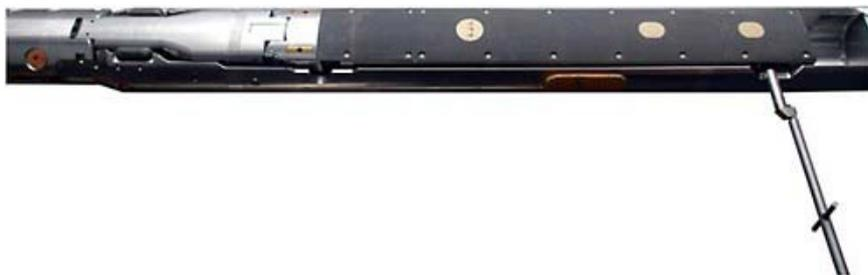
FIG. 31. Atlas Densilog utilisant une source vitrifiée au  $^{137}\text{Cs}$  pour mesurer la densité de câbles. La tige dirigée vers le bas sert à manipuler la source. Les cercles de couleur claire sont des fenêtres prévues pour la source et les détecteurs.
