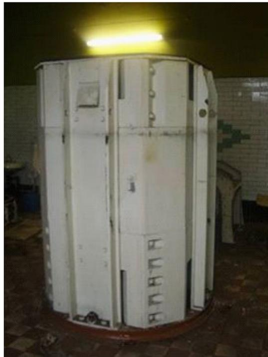
FIG. 106. Irradiateur chargé de sources radioactives scellées retirées du service au  $^{137}\text{Cs}$  prêt pour le transport dans une installation de stockage définitif.
