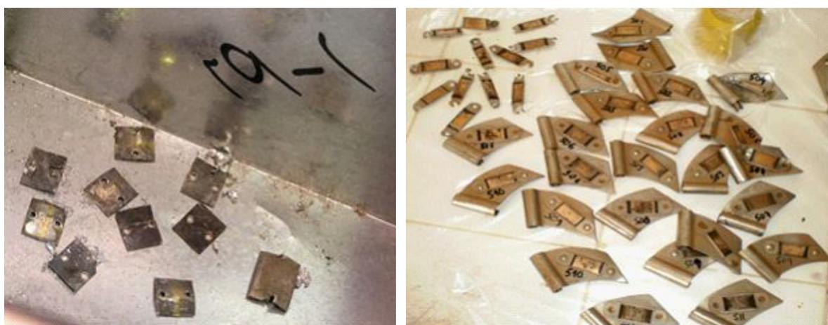
FIG. 88. Plaques au  $^{226}\text{Ra}$  et à  $^{241}\text{Am}$  retirées de paratonnerres.
