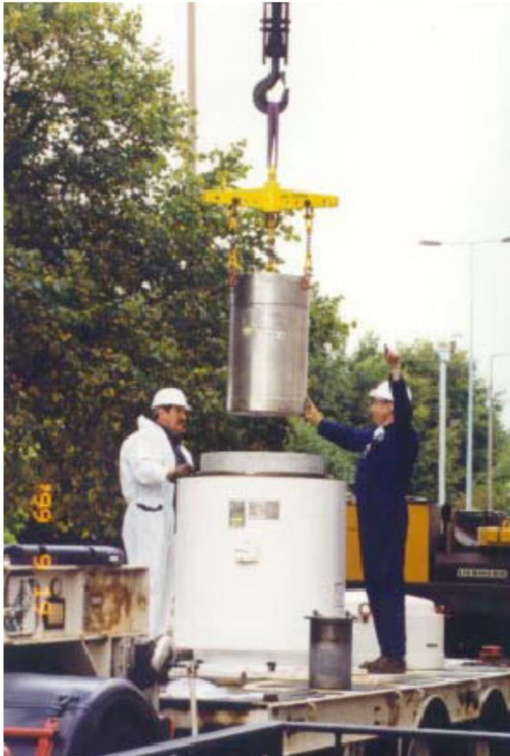
FIG. 104. Chargement d'un conteneur intérieur blindé pour sources au  $^{137}\text{Cs}$  dans un colis de type B, après le retrait des sources d'un irradiateur de recherche.
