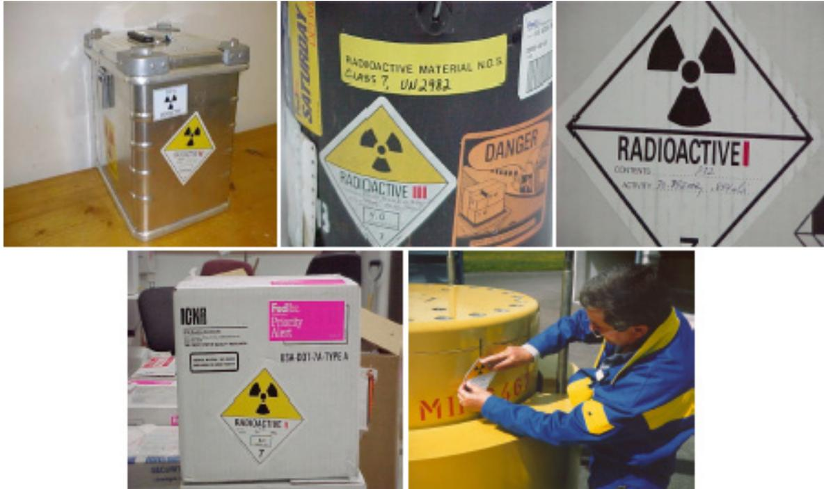
FIG. 59. Étiquetage de colis préparés pour l'entreposage et le transport.
