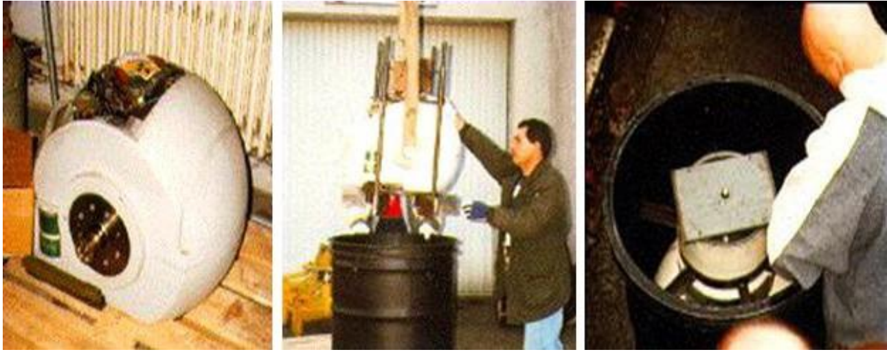
الشكل ٩٠- رأس معالجة بُعادية قبل تكييفه داخل أسطوانة معدنية.
