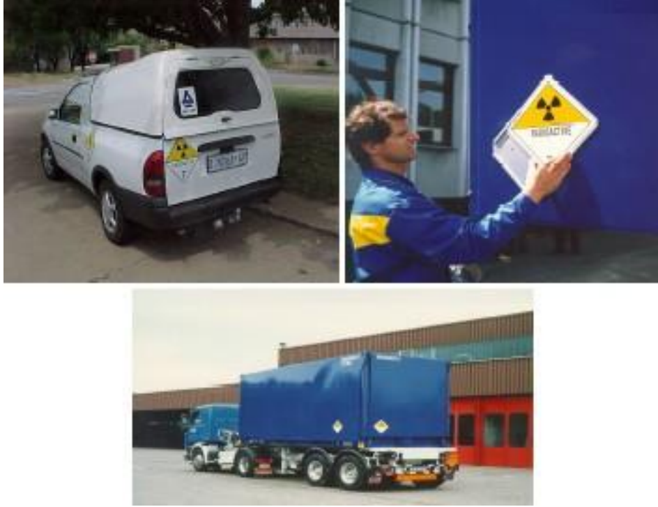
الشكل ٩٥- وضع الملصقات على المركبات المستخدمة في نقل المصادر المشعة المختومة.
