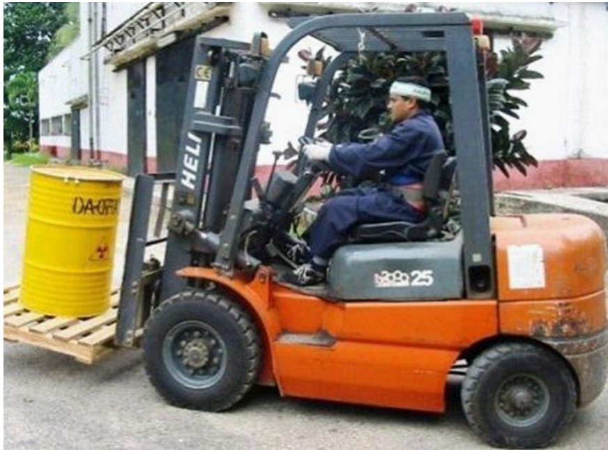
الشكل ٥٧ - التعامل مع برميل نفائات سعة ٢٠٠ لتر باستخدام رافعة شوكية.
