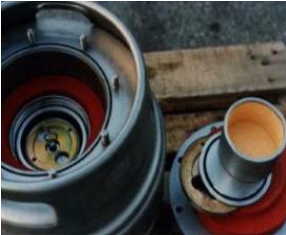
الشكل ٩٨- بالنسبة للمصادر الصغيرة، اعتماداً على حجم المصدر وهندسته ونشاطه، يجب استخدام حاوية خاصة للنقل.
