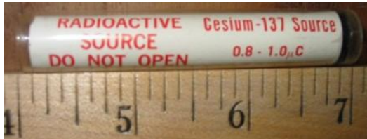
الشكل ٢٥ - أمثلة على مصادر المعايرة ذات النشاط المنخفض: الكوبالت-٦٠، والسييزيوم-١٣٧، والسترونشيوم-٩٠، والرااديوم-٢٢٦.
