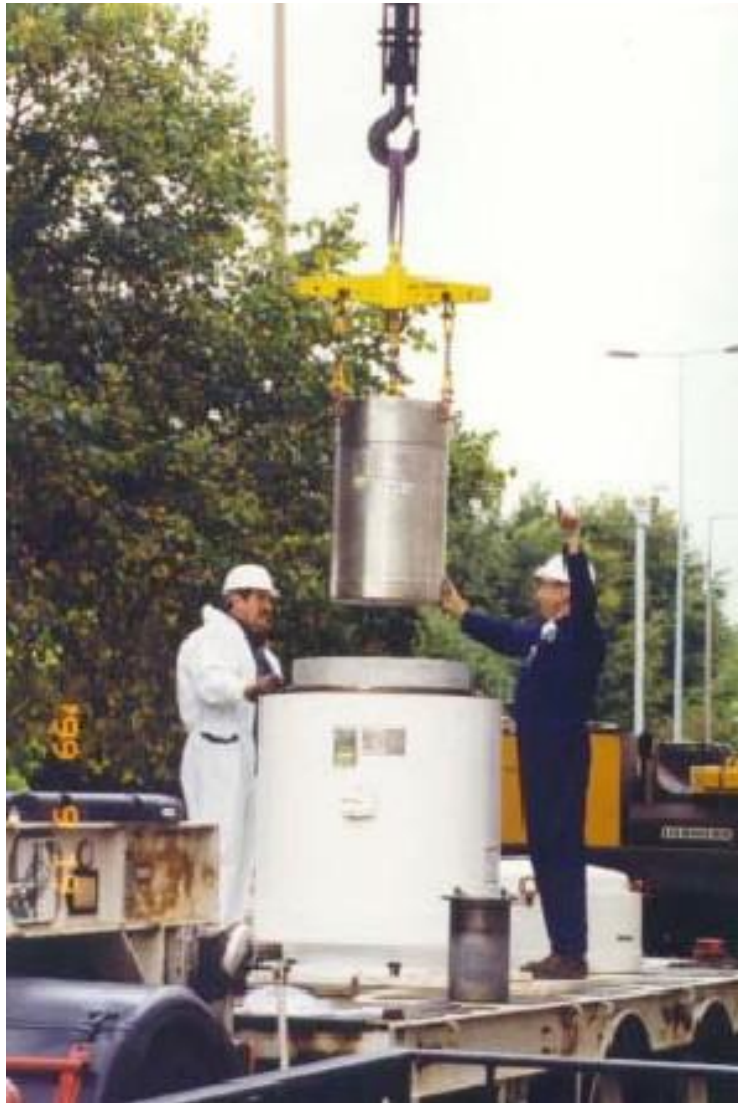
الشكل ١٠٤ - تحميل حاوية داخلية مدرّعة للسيزيوم-١٣٧ في عبوة من النوع B، بعد إزالة مصادر السيزيوم-١٣٧ من جهاز تشعيع بحثي.
