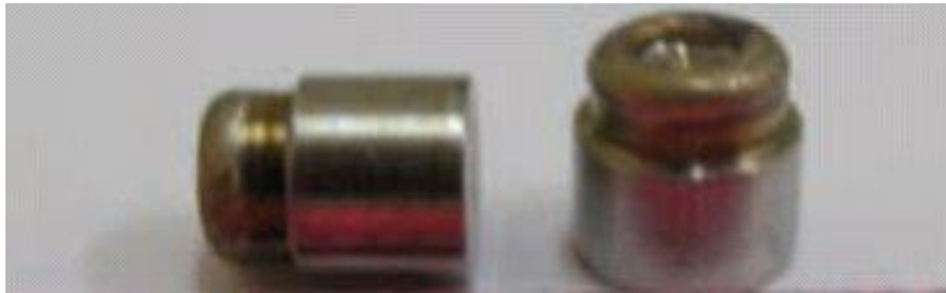
الشكل ٢٢ - كبسولة مصدر داخلي نموذجية للتصوير بأشعة غاما قبل تغليفها في الطرف.
