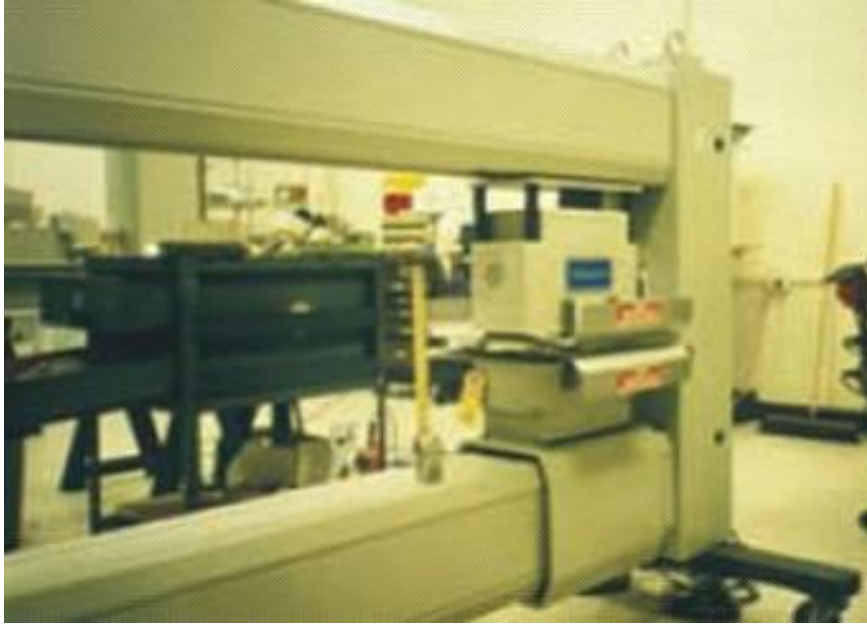
الشكل ٣٣- جهاز قياس قائم باستخدام مصدر بيتا في ماكينة معالجة ويب.
