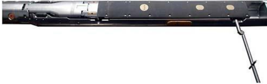
الشكل ٣١- جهاز Atlas Densilog يستخدم مصدراً مزججاً للسيزيوم-١٣٧ لقياسات كثافة الأسلاك. والقضيب الممتد للأسفل هو جهاز للتعامل مع المصدر. والنوائر ذات الألوان الفاتحة عبارة عن نوافذ للمصدر وكاشفات.
