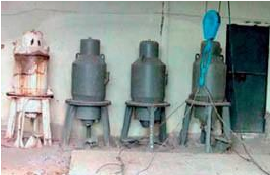
الشكل ١٣ - أجهزة التشعيع المتنقلة العاملة بالسييزيوم المستخدمة في الاتحاد السوفياتي السابق.
