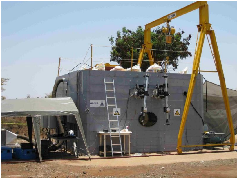
الشكل ٩٢ - الخلية الساخنة المتنقلة التابعة للوكالة - مجمعة بالكامل وجاهزة للاستخدام.
