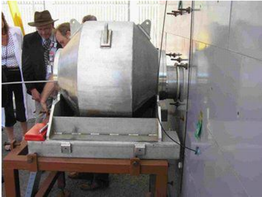
الشكل ٩٤ - درع الخزن الطويل الأجل الملحق بالكامل بمنفذ النقل في مرفق الخلية الساخنة المتنقل التابع للوكالة.
