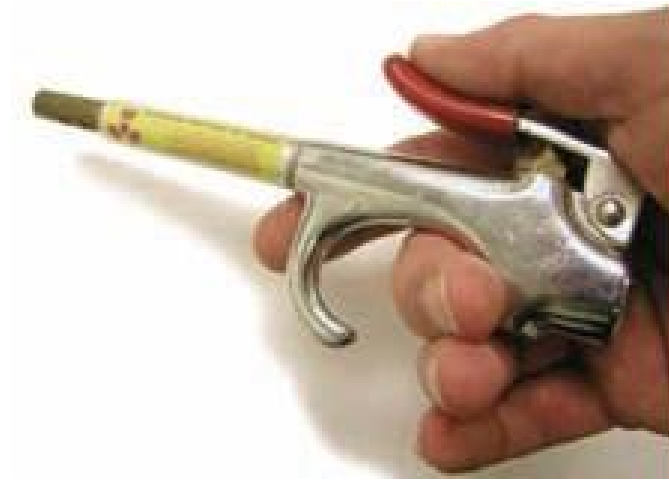
الشكل ٣٨ - قاذف هواء نموذجي في جهاز إزالة الكهرباء الاستاتيكية.
