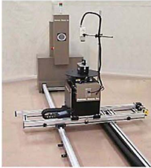
الشكل ٢٤ - التكوين النموذجي لجهاز معايرة باستخدام أشعة غاما لمعايرة أداة المسح.
