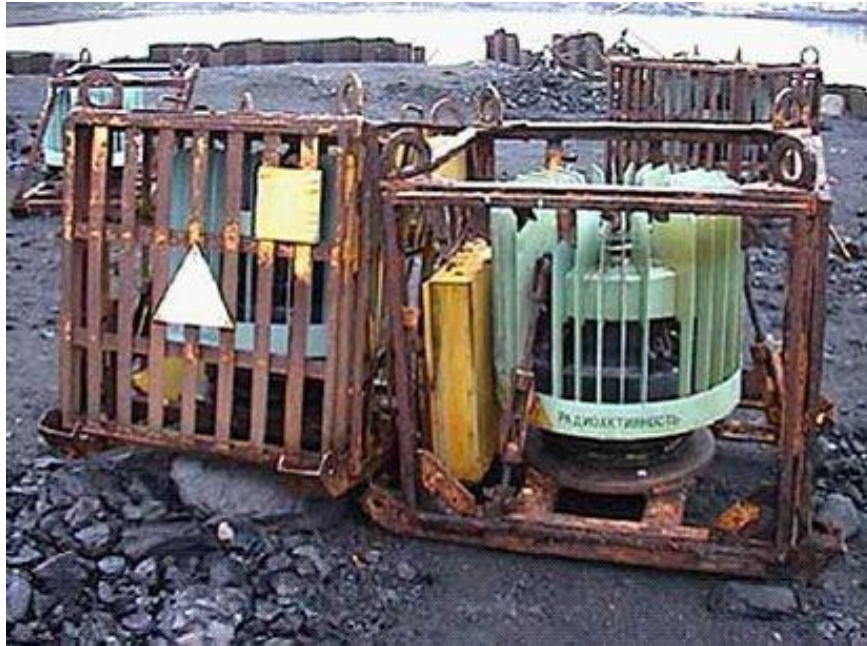
الشكل ٧٤- مكان خزن غير مناسب للمولدات الكهربائية الحرارية العاملة بالنظائر المشعة.
