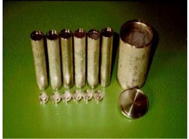
الشكل ٨٣- كبسولات نموذجية من الفولاذ غير القابل للصدأ.
