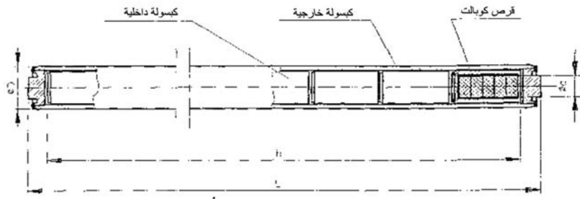
الشكل ٩- مصدر من نوع القلم الرصاص من الكوبالت-٦٠.
