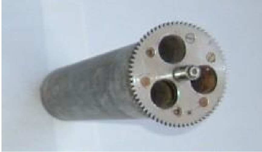
الشكل ٨١- جزء دوار داخلي لحاوية تحميل/تفريغ من النوع B(U).
