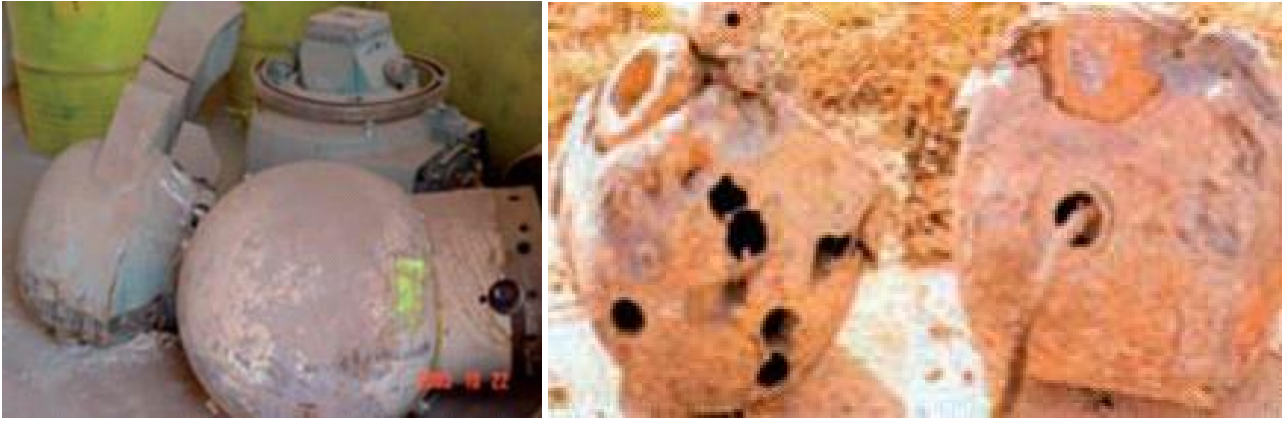
الشكل ١٥ - رؤوس قديمة وتالفة من أجهزة المعالجة البُعادية.
