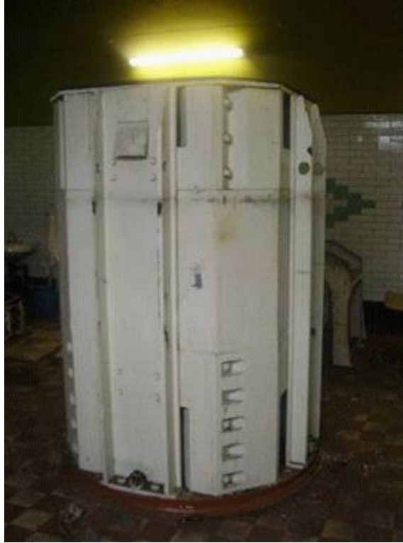
الشكل ١٠٦ - جهاز تشعيع محمل بمصادر مشعة مختومة مهمة من السيزيوم-١٣٧ جاهز للنقل إلى مرفق التخلص.
