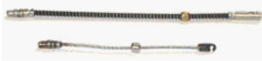
الشكل ٢٠ - مصدر/مجمعات طرفية نموذجية قديمة تستعمل في التصوير بأشعة غاما.
