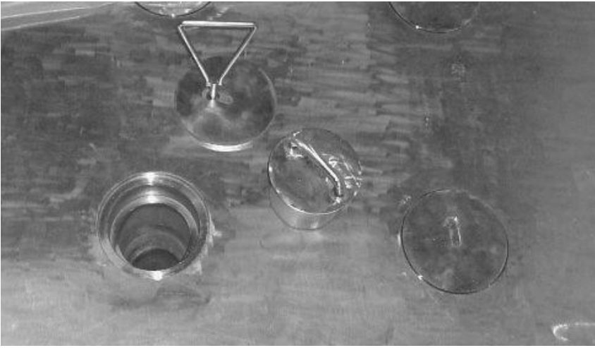
الشكل ٧٦- مخزن أنابيب للمصادر المختومة.
