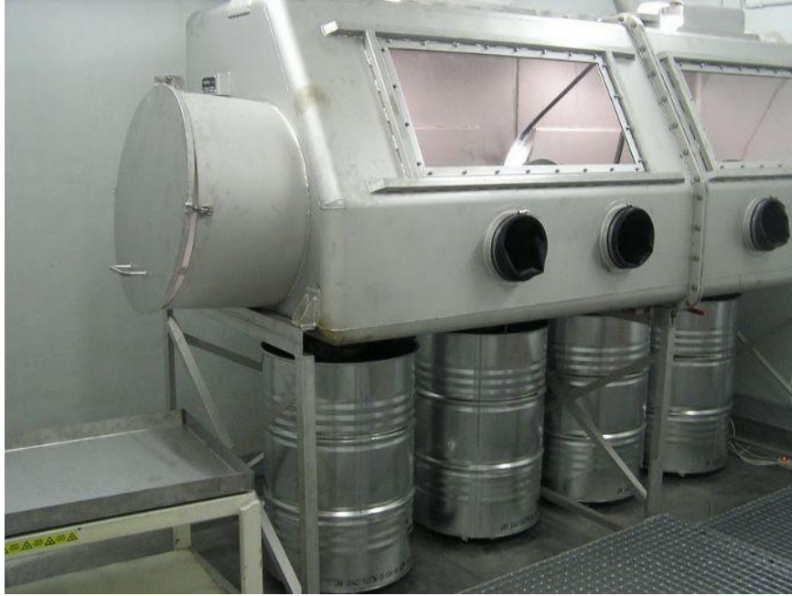
الشكل ٥١ - التعامل مع المصادر المختومة منخفضة النشاط في صندوق مغلق.
