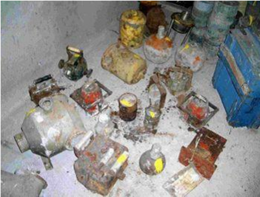
الشكل ٧٣- خزن غير مناسب للمصادر المشعة المختومة المهملة.
