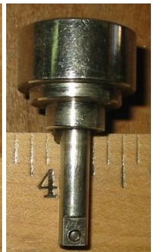
الشكل ٢٥ - أمثلة على مصادر المعايرة ذات النشاط المنخفض: الكوبالت-٦٠، والسييزيوم-١٣٧، والسترونشيوم-٩٠، والرااديوم-٢٢٦.
