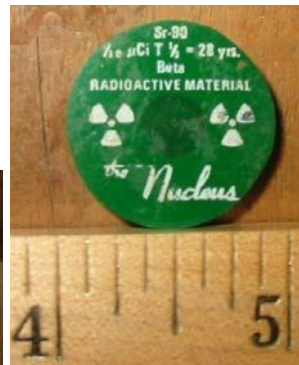
الشكل ٢٥ - أمثلة على مصادر المعايرة ذات النشاط المنخفض: الكوبالت-٦٠، والسييزيوم-١٣٧، والسترونشيوم-٩٠، والرااديوم-٢٢٦.
