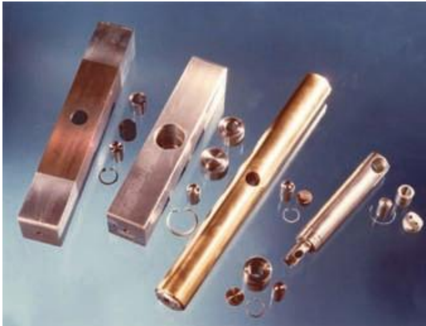
الشكل ١٦ - مصادر مختلفة للكوبالت-٦٠ تستخدم في المعالجة البُعادية مع التركيبات المرتبطة للتحميل في رؤوس أجهزة المعالجة البُعادية.
