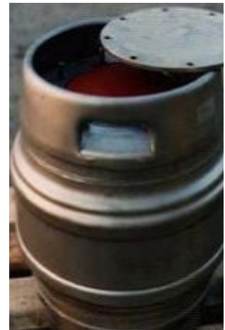
الشكل ٩٨- بالنسبة للمصادر الصغيرة، اعتماداً على حجم المصدر وهندسته ونشاطه، يجب استخدام حاوية خاصة للنقل.
