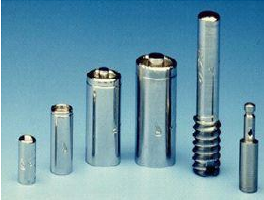
الشكل ٣٤- أمثلة على مصادر السيزيوم التي أُزيلت من أجهزة القياس.
