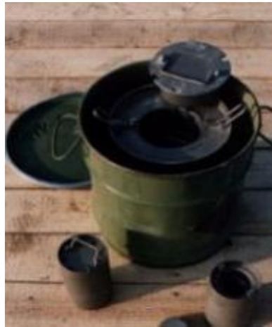
الشكل ٩٨- بالنسبة للمصادر الصغيرة، اعتماداً على حجم المصدر وهندسته ونشاطه، يجب استخدام حاوية خاصة للنقل.
