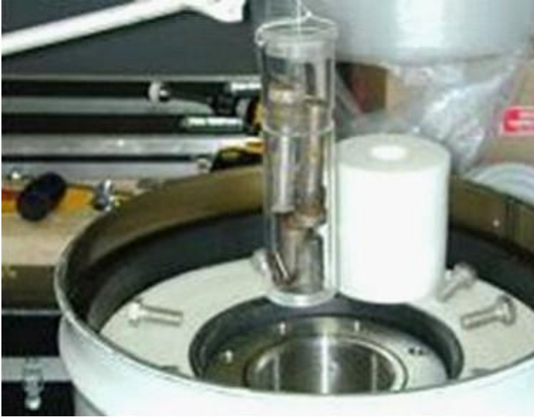
الشكل ٨٩ - حاوية تغليف أنبوبي مجمّع من النوع S100.
