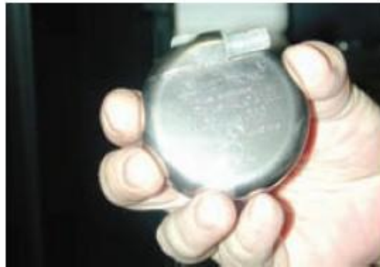
الشكل ٦- جهاز تنظيم ضربات القلب يعمل بالقوى المتولدة من مولد كهربائي حراري يعمل بالنظائر المشعة.
