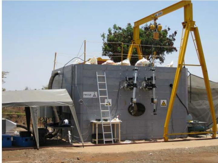
Fig. 5.34. Instalación de acondicionamiento de fuentes selladas en desuso montada en un emplazamiento.
