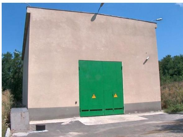
*Fig. 10.2. Edificio con armazón de hormigón armado y techo inclinado construido in situ.*
