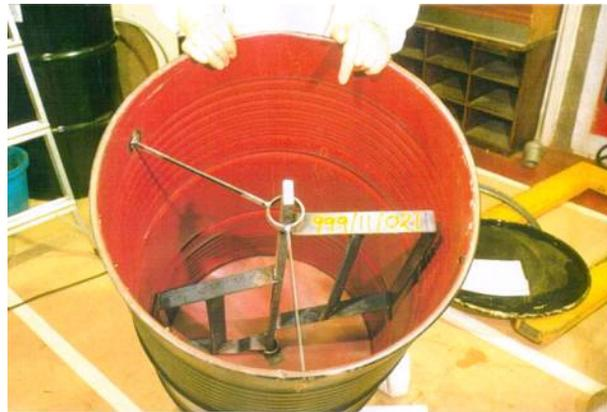
*Fig. 5.23. Bidón típico con agitador de paleta descartable.*
