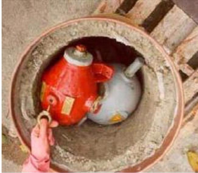
*Fig. 4.4. Colocación de fuentes selladas en desuso en un bidón de 200 L con blindaje anular.*
