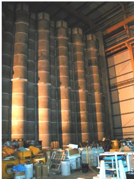
Fig. 8.6. Almacenamiento en tuberías de hormigón.
