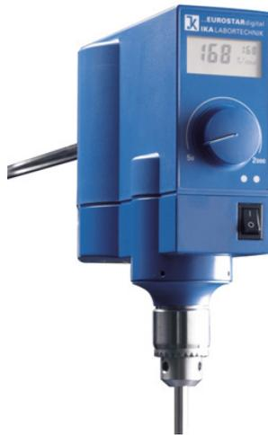
*Fig. 5.3. Mezclador de sobremesa de gran par.*
