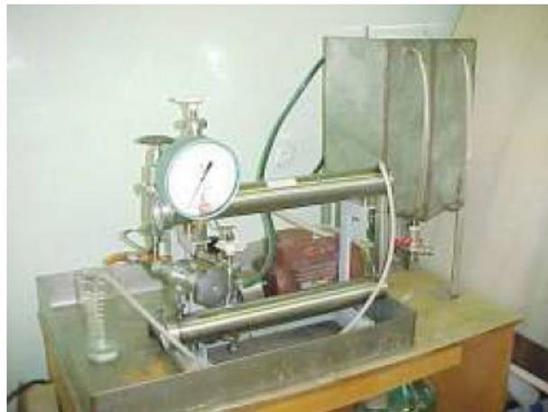
*Fig. 5.14. Módulo B3—Ósmosis inversa de sobremesa.*
