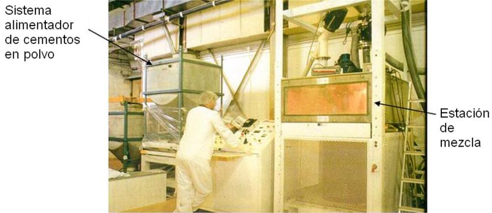
*Fig. 5.22. Ilustración fotográfica del Módulo B6-Solidificación.*
