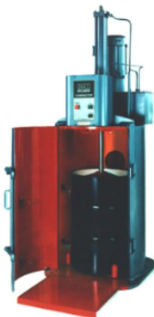
*Fig. 5.27. Fotografía de un Módulo D2–Compactador de baja fuerza.*
