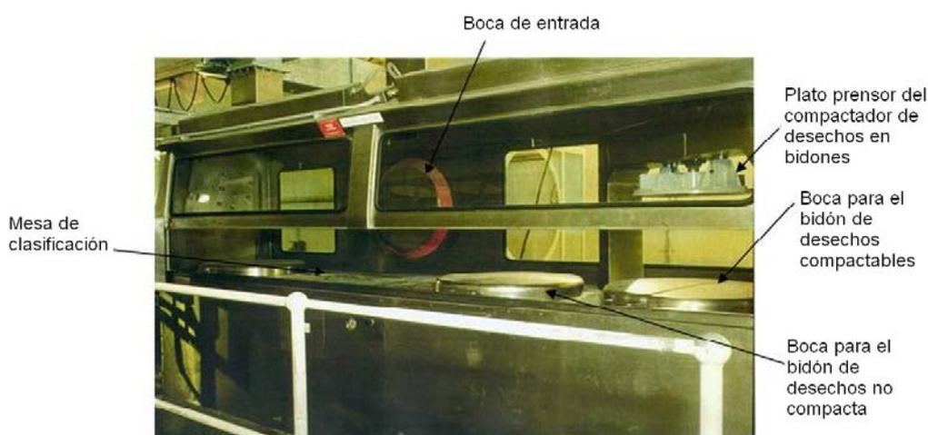
Fig. 5.29. Ejemplo de una cabina sin blindaje para la clasificación de desechos sólidos.
