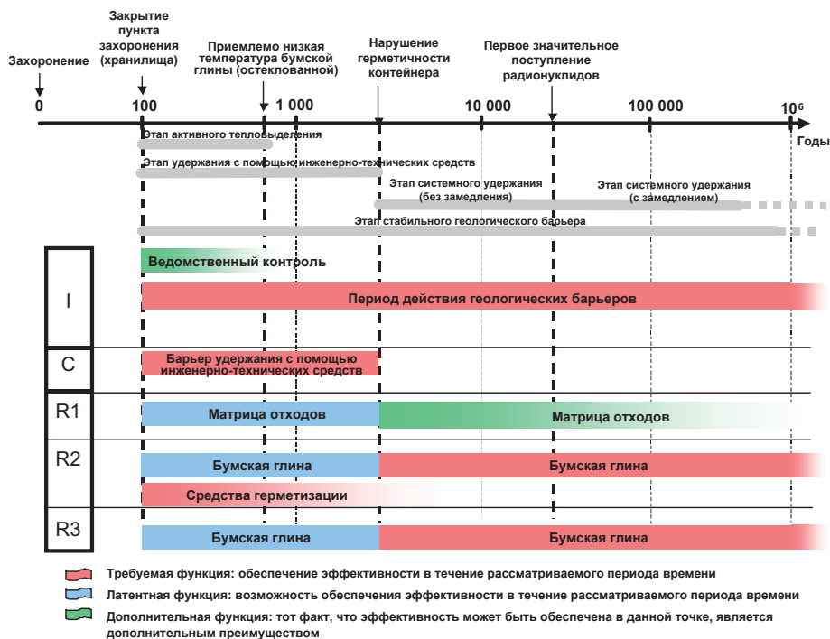
РИС. 5. Иллюстрация связи между функциями безопасности и временем для одной концепции захоронения отработавшего ядерного топлива и высокоактивных отходов [11]. I = изоляция; C = удержание; R = замедление.
