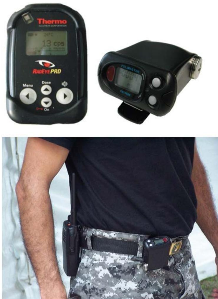
图 V-1. 个人辐射探测器典型示例。
