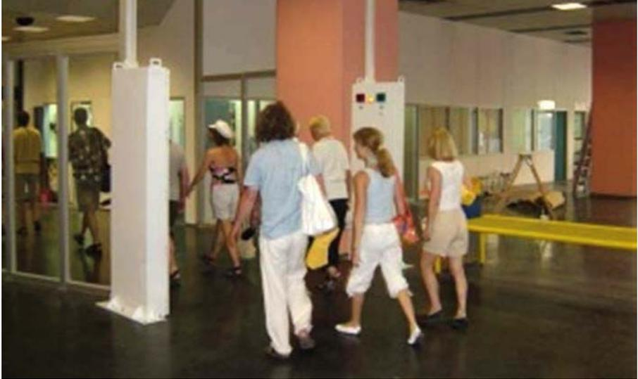
图 V-4. 安装在港口的典型门式行人辐射监测系统示例。
