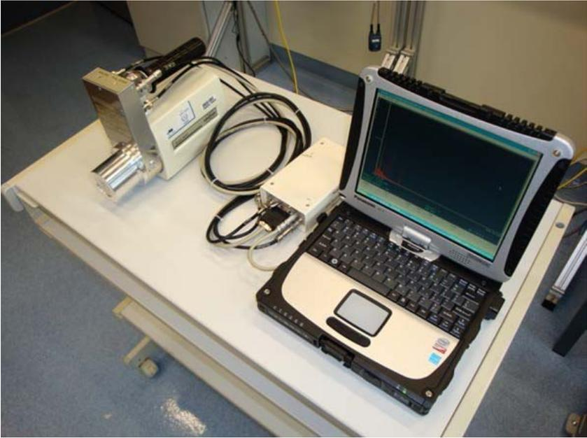
图 V-9. 采用液氮冷却高纯锗探测器的典型高分辨率  $\gamma$  能谱系统示例。
