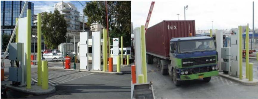
图 V-5. 安装在入口处的典型门式车辆辐射监测系统示例。
