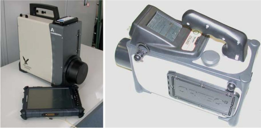
图 V-8. 采用电冷高纯锗探测器的典型高分辨率  $\gamma$  能谱系统示例。
