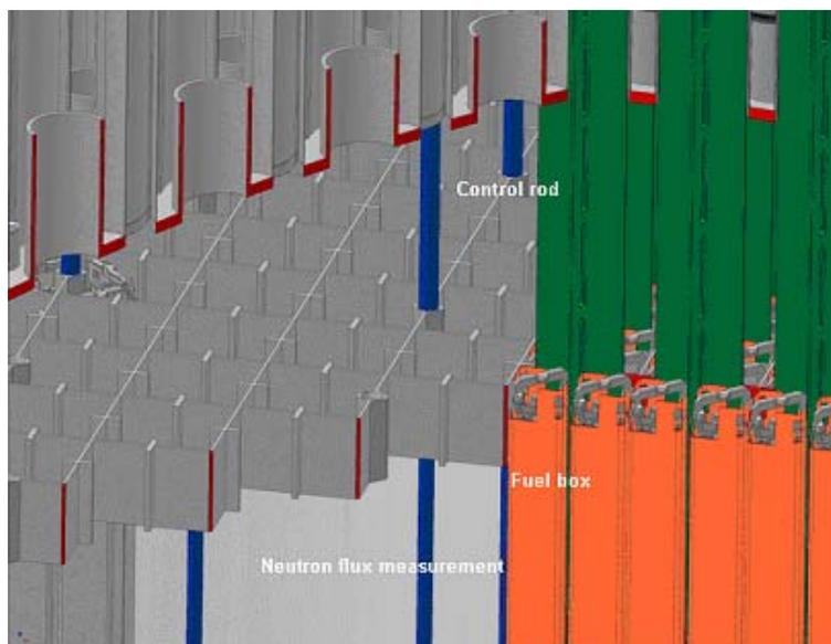
*Fig. 3. Control Rods*
